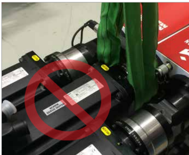
илюстрация 3-5 Не използвайте двигателя като точка за захващане
