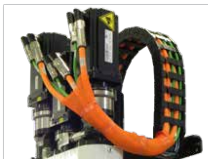
илюстрация 5-1 Прокарване на кабелите за серводвигателите при ЕМЗ
