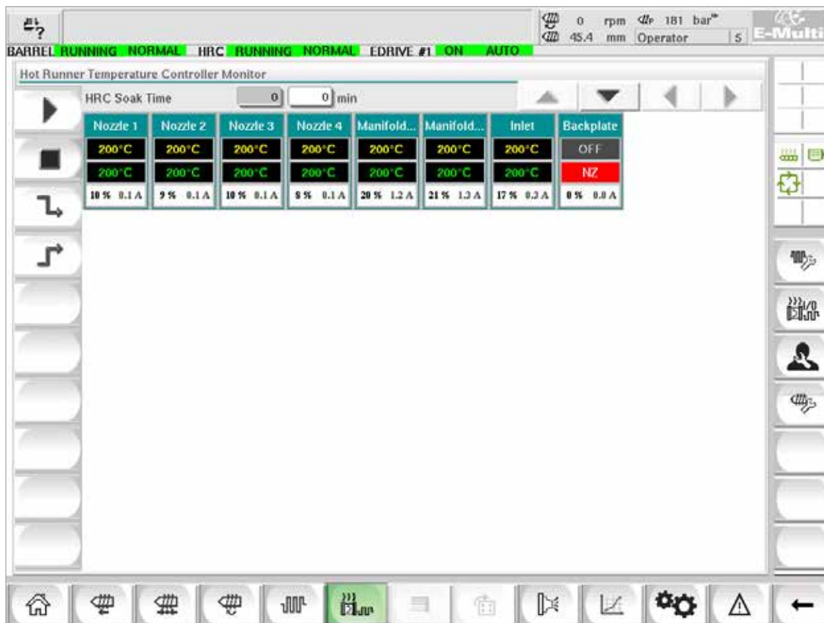
илюстрация 7-10 Екран за преглед на регулатора на температурата на гореща леякова система
