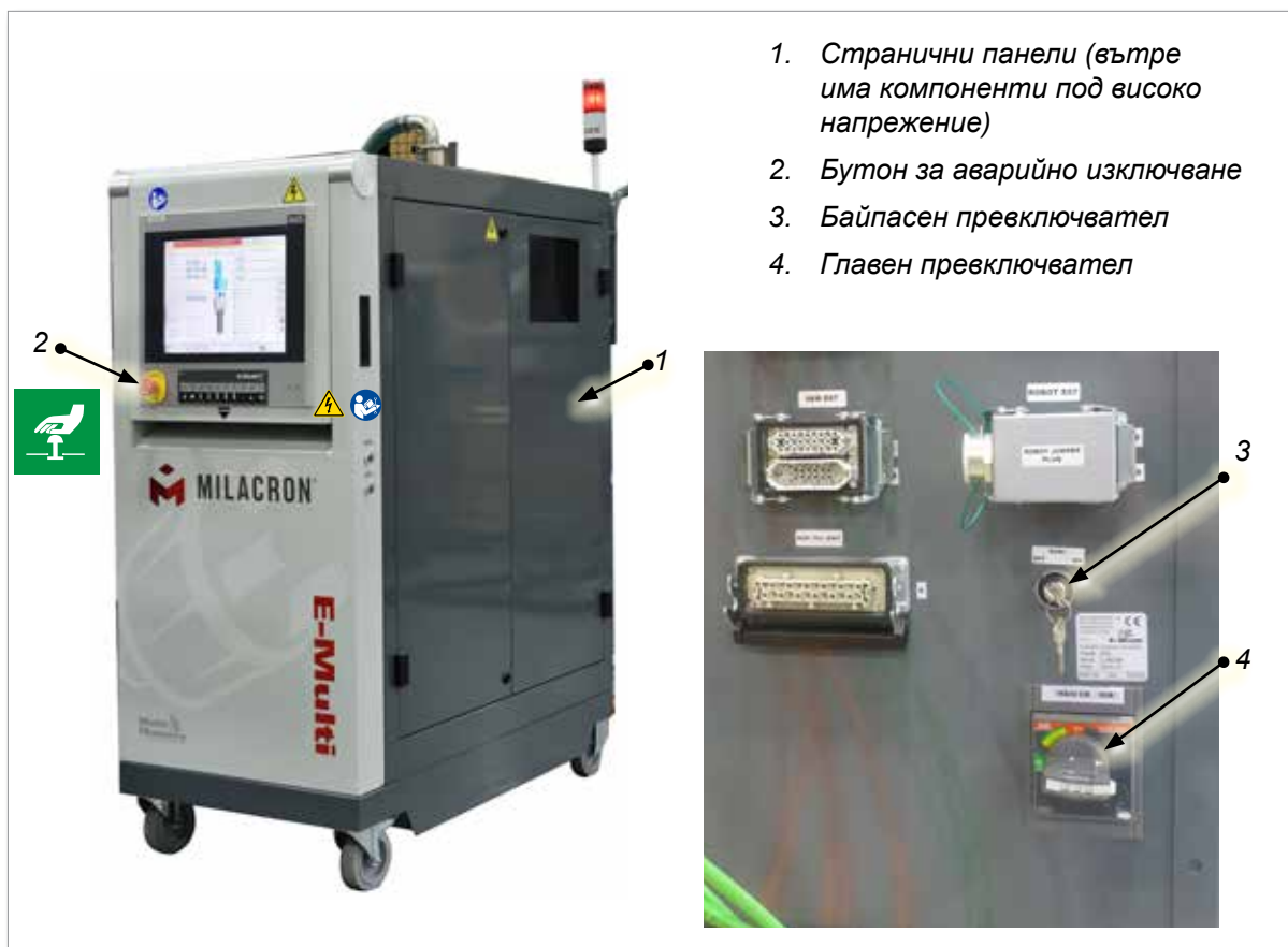
илюстрация 3-2 Източници на опасност при блок за управление E-Multi
