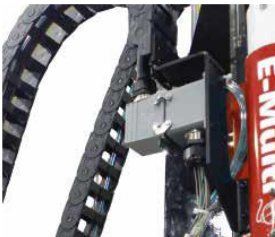
图 11-7 安装料筒加热器连接器
