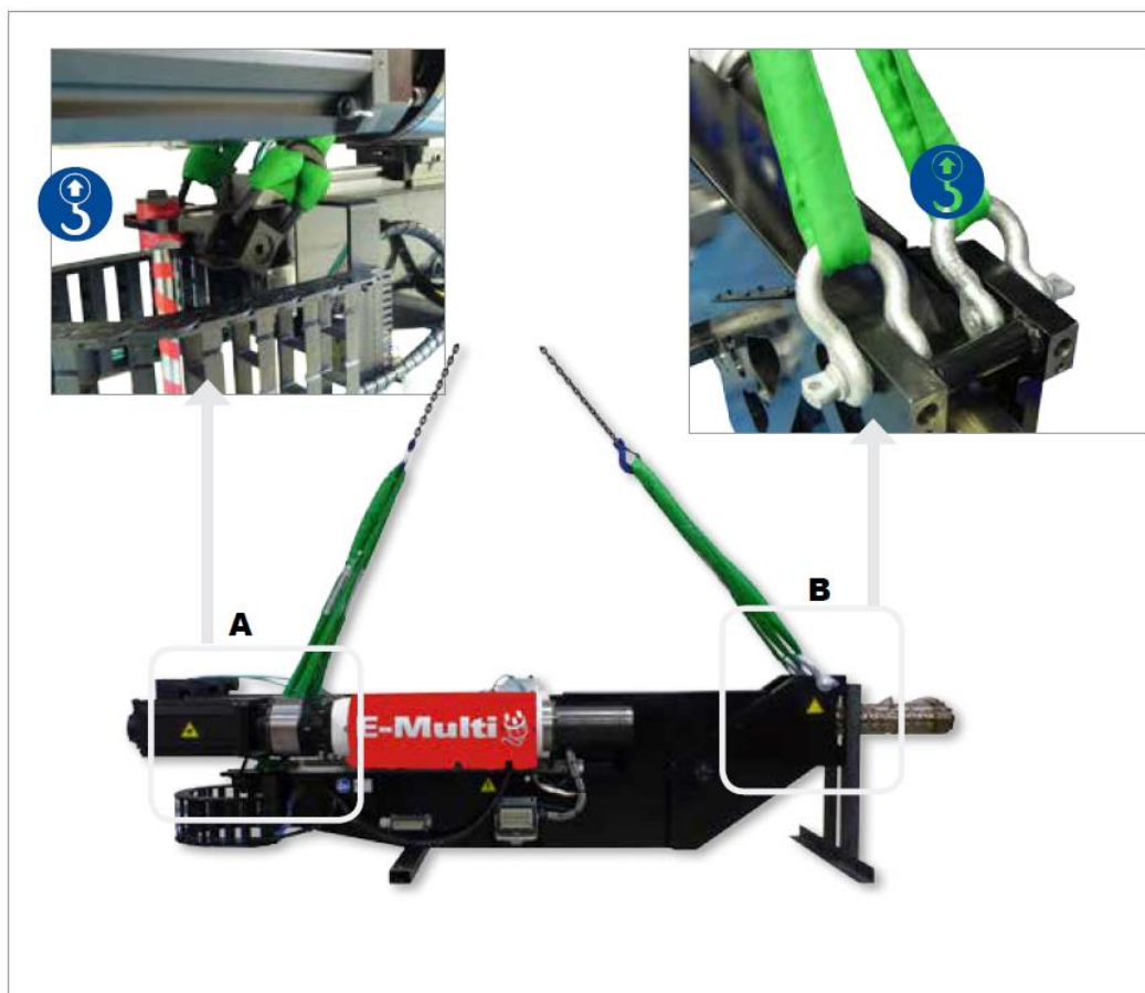
图像 3-8 EM4水平吊装连接
