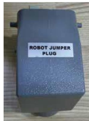
图像 7-6 机器人跳线插头
