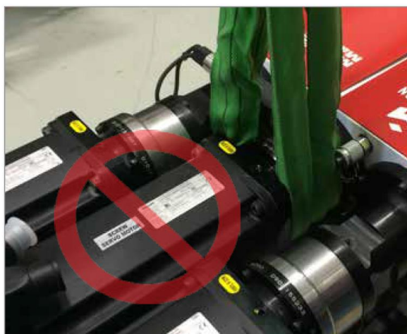
图像 3-5 请勿使用电机作为吊装点
