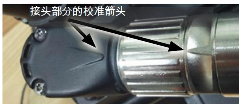
图像 7-2 正确的连接器对齐
