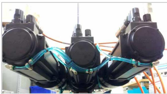
图像 7-8 EM3/EM4 伺服电机冷却连接
