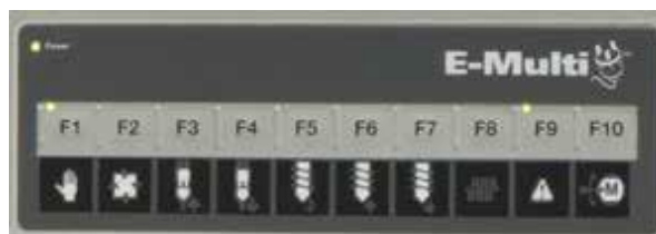
图像 8-2 控制器显示器下方的按钮条 (HMI)
