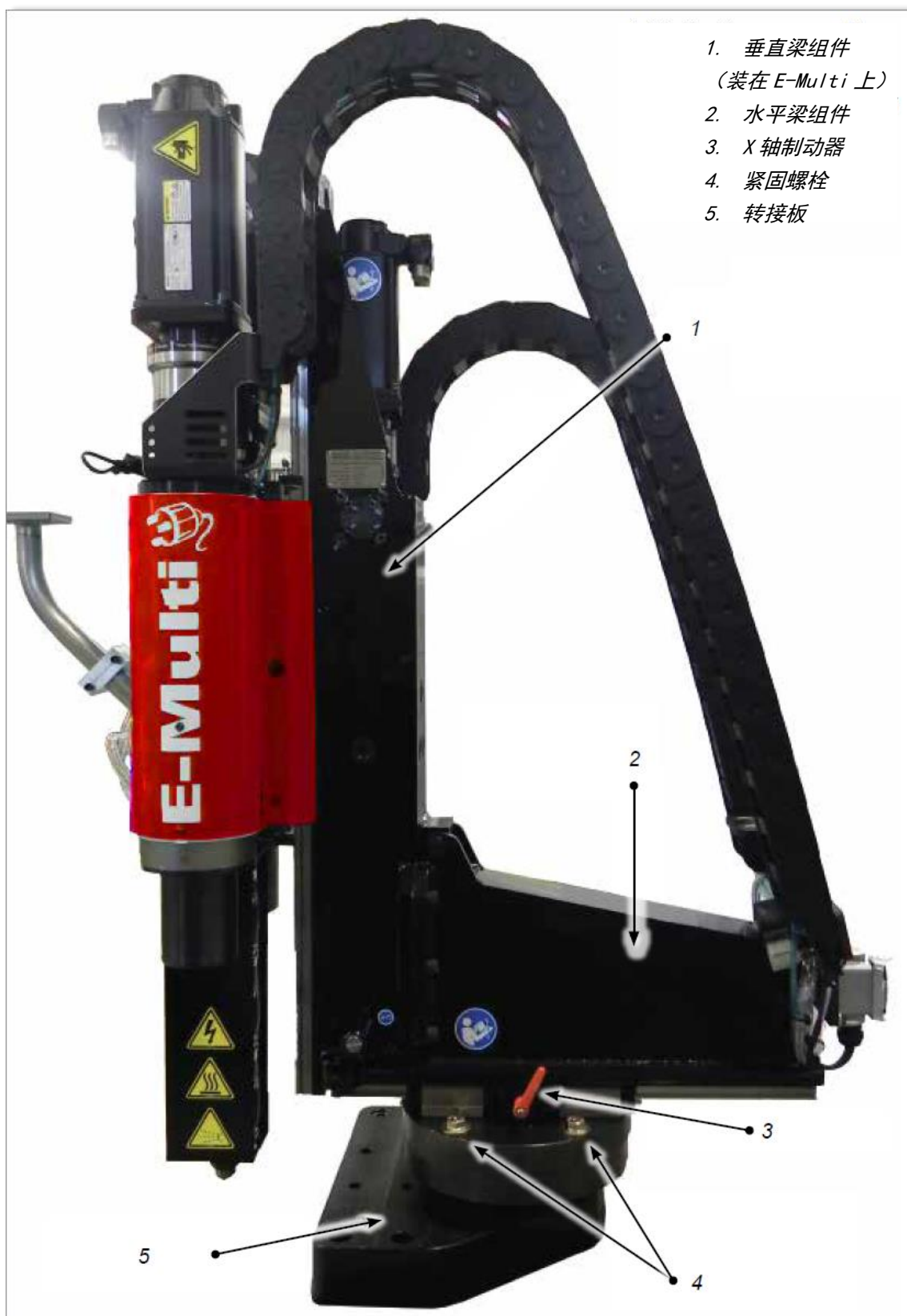
图 11-1 E-Multi Radial 的主要组件
