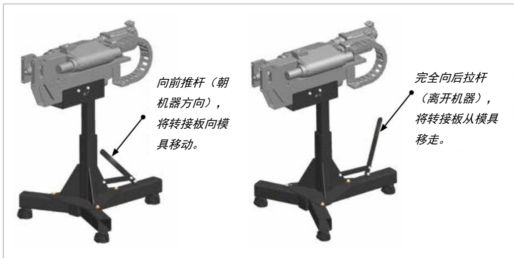
图 14-4 紧凑型支架水平位置调节
