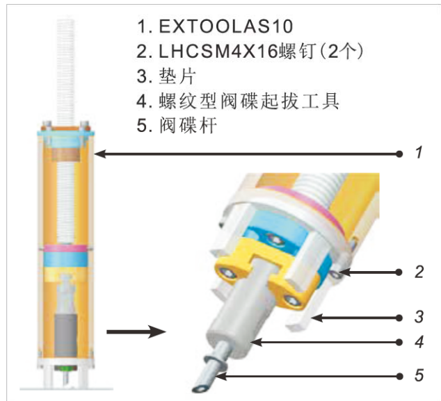
图15-4 螺纹型阀碟起拔
