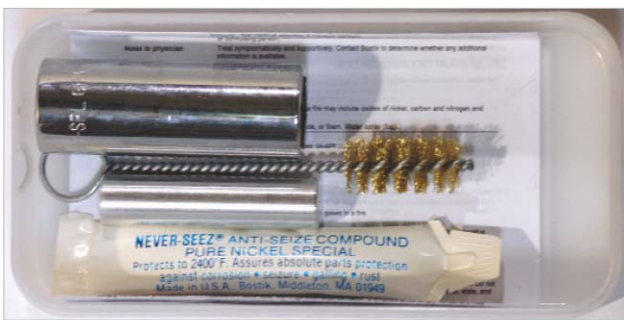
图15-10 浇口维护保养使用的工具组
