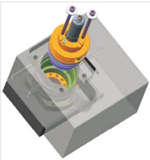
图11-23 安装SlimStack单元
