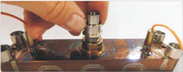
图19-15 安装连接套的下端部分
