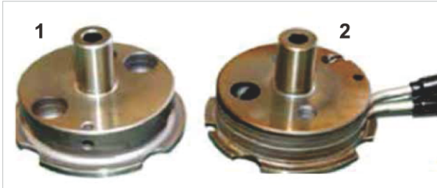
图5-30 阀针导套的种类 1. 非加热式 2. 加热式
