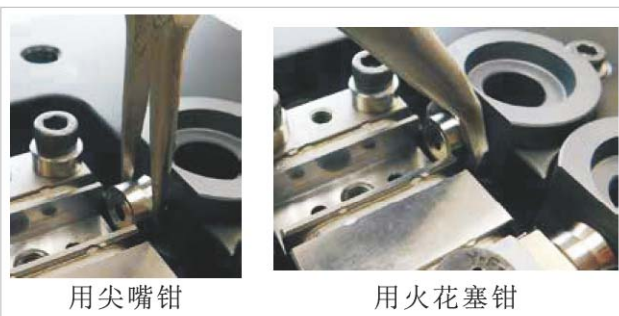
图19-30 拆除浇口装置
