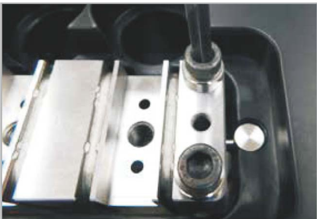
图19-21 安装垫圈和螺栓
