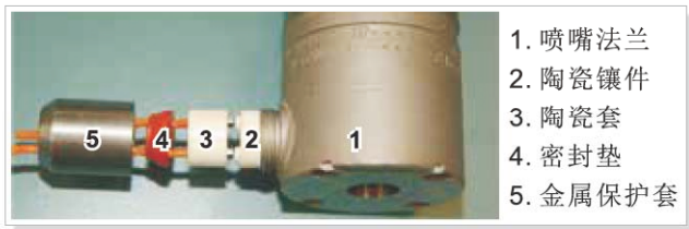
图15-6 喷嘴接线终端的装配
