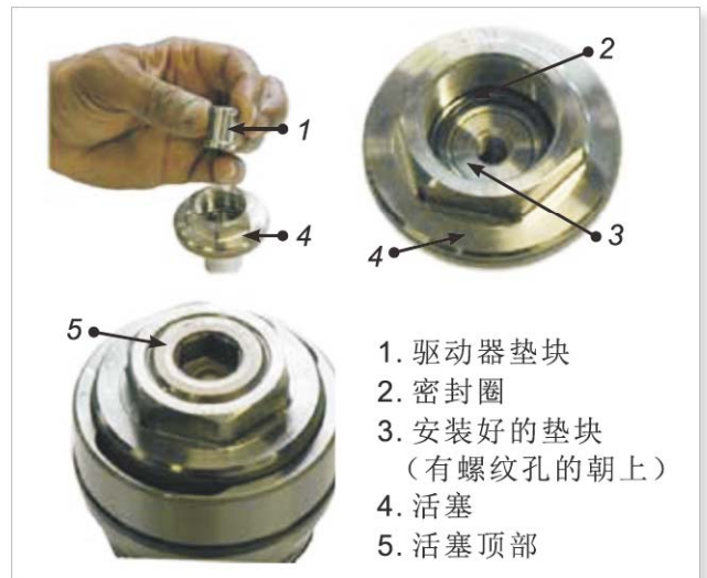
图10-19 活塞垫块的安装
