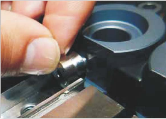
图19-25 安装浇口装置
