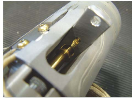
图17-2 Accu-Line阀针基座和阀针
