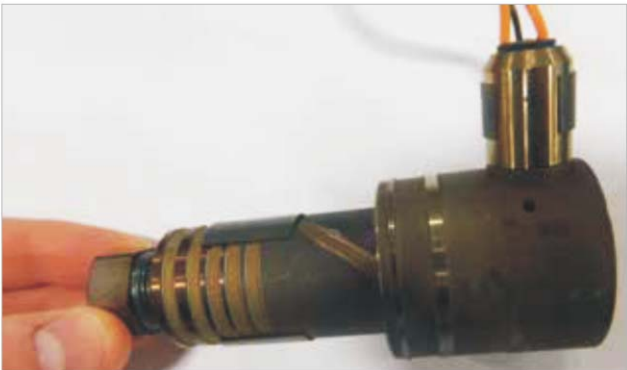
图19-16 安装连接套的上端部分
