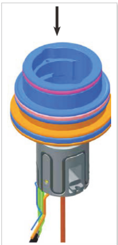
图11-12 将活塞组件安装至加热体
