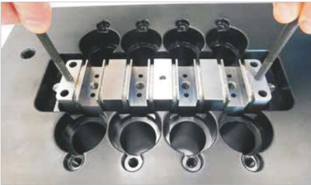
图19-20 安装Melt-CUBE分流板
