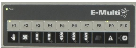
Obrázek 8-2 Lišta tlačítek pod displejem řídící jednotky (HMI)
