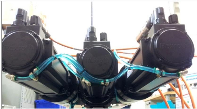
Obrázek 7-7 Přípojky chlazení servomotoru jednotky EM3/EM4
