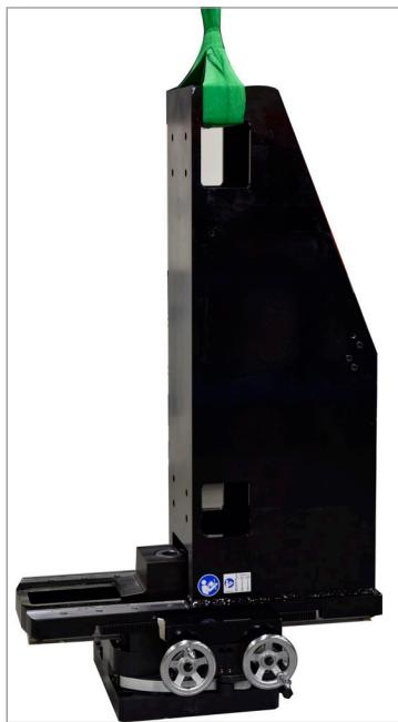
4. Nainstalujte vodorovný nosník na adaptérovou desku. Vložte 4 šrouby (M20x90) do přístupných otvorů a utáhněte je rukou.
