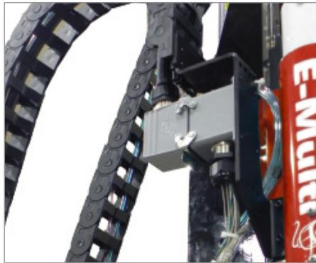
Obrázek 11-7 Nainstalujte konektor ohříváče válce
