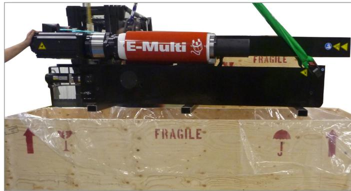
12. Ke svislému nosníku připevněte zdvihamy tyč. Ke každému konci zdvihamy tyče připevněte 4" popruhy (dodaný) ve škrticí konfiguraci.
