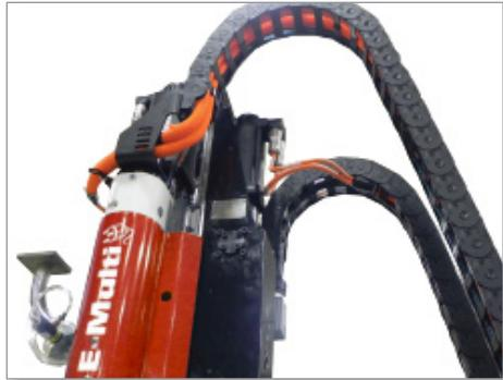
Obrázek 11-8 Připojte kably servomotoru
