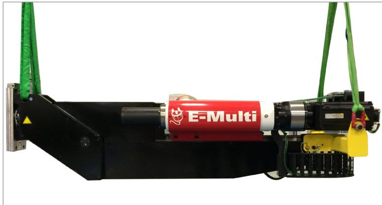
6. Zvedněte jednotku za konec u motoru. Udržujte zdvihací zařízení vystředěná nad příslušným zdvihacím bodem.
