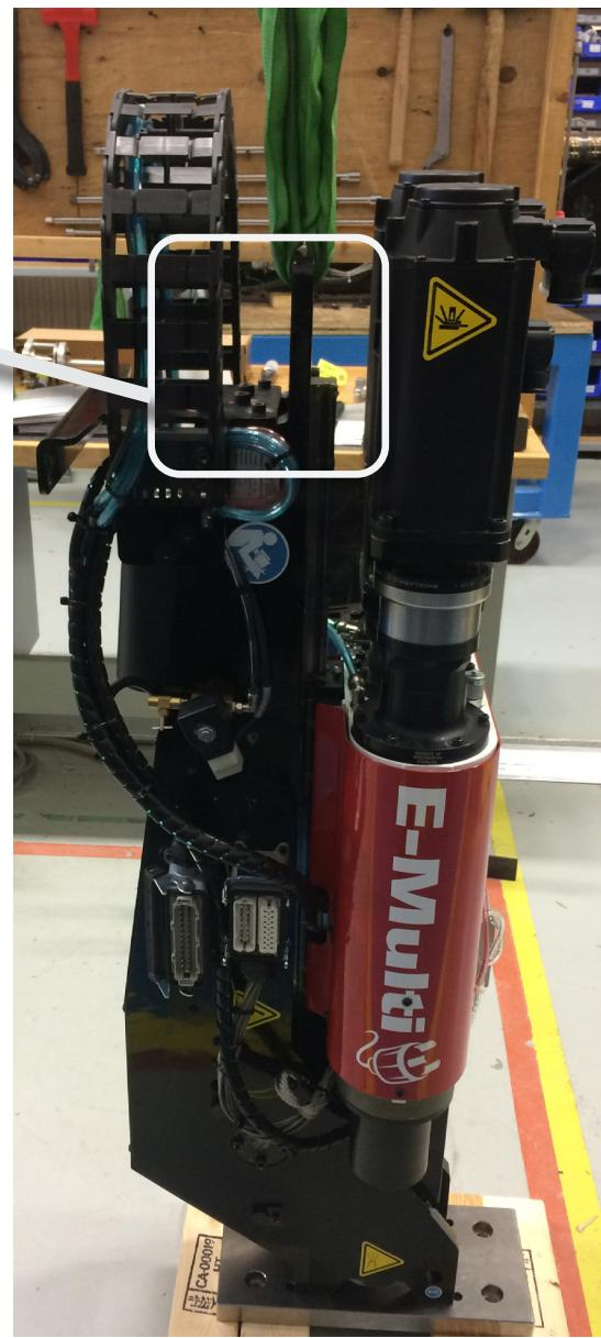
Obrázek 3-6 Vertikální připojovací body pro zvedání jednotky EM1/EM2 (podobné jednotce EM3)
