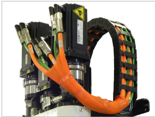
Obrázek 7-1 Vedení kabelů servopohonu jednotky EM3
