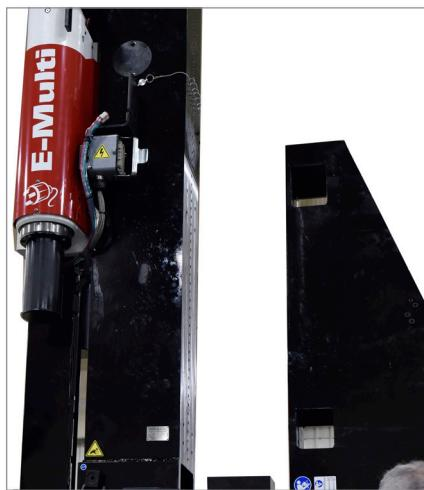
16. Namontujte 8 šroubů (M16×50), upevněte svislý nosník k vodorovnému nosníku a utáhněte šrouby rukou.
