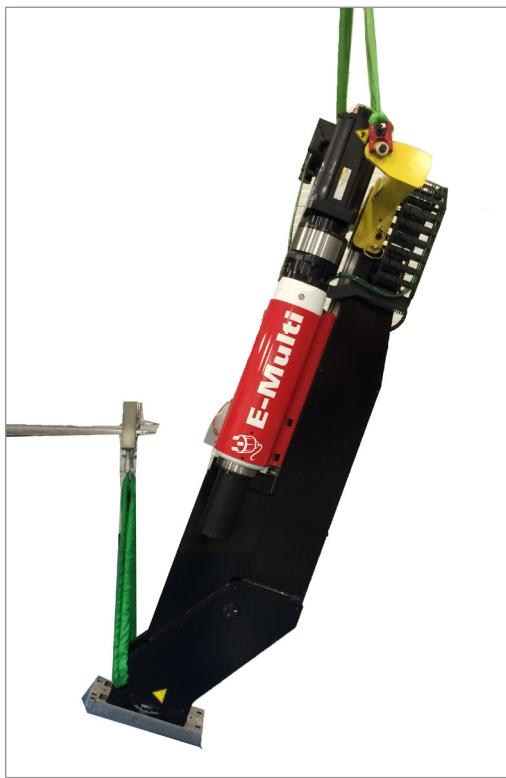
8. Položte vstřikovací jednotku E-Multi na desku adaptéru. Položte vstřikovací jednotku E-Multi na povrch, který nepoškodí desku adaptéru (dřevo, karton apod.).
