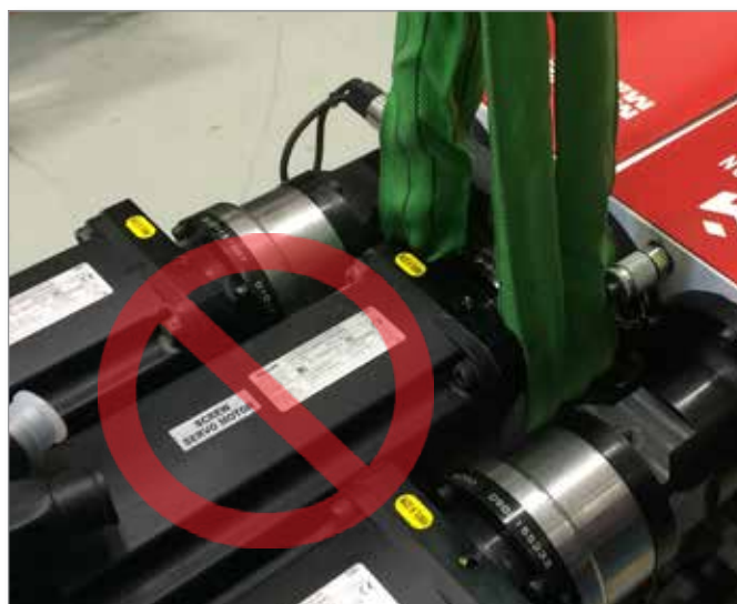
Obrázek 3-12 Nepoužívejte motor jako zdvihací bod.
