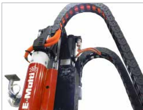
Abbildung 11-8 Anbringen der Servomotor-Kabel
