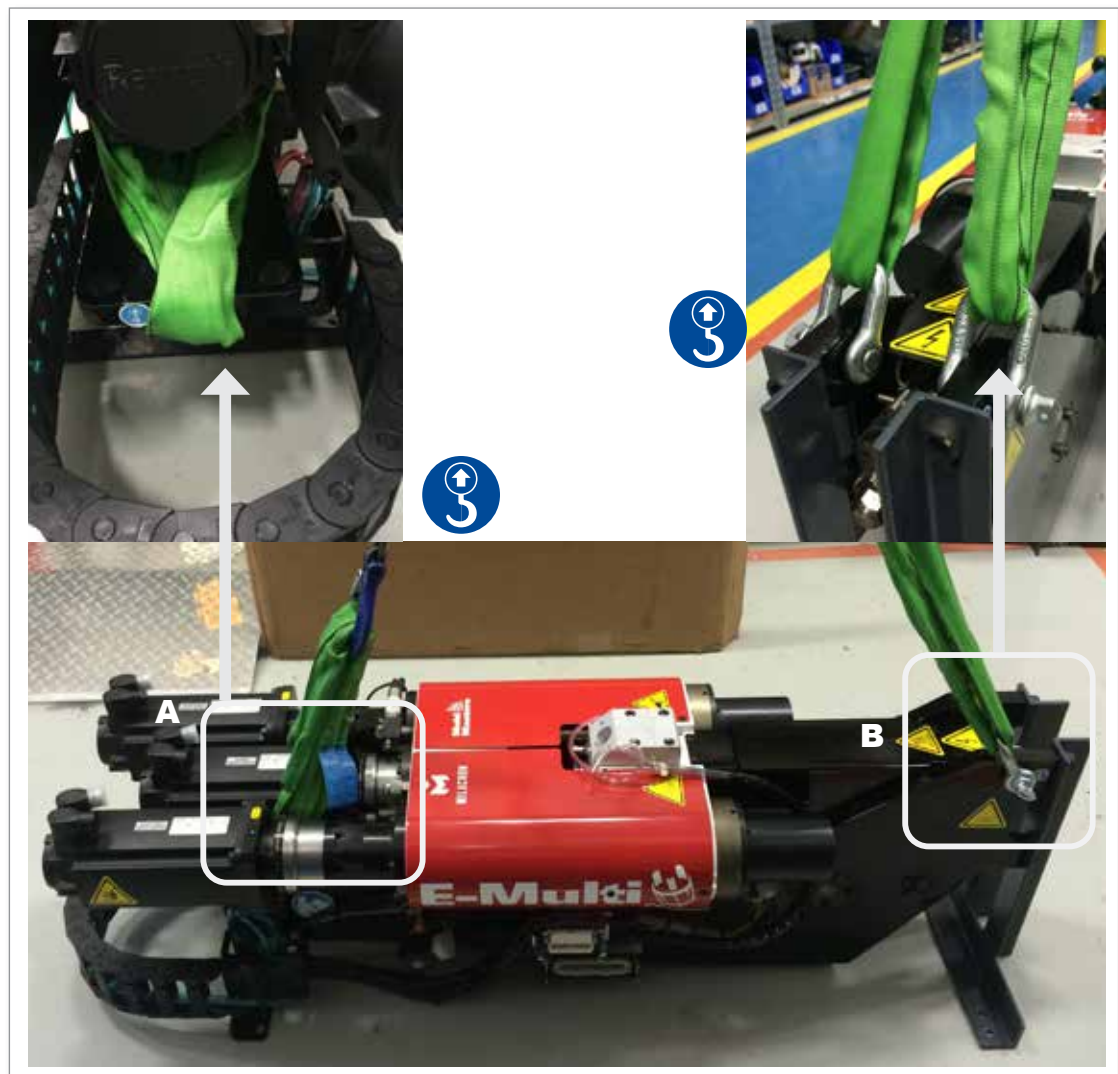
Abbildung 3-7 Horizontale Hubvorrichtungen EM3. EM1/EM2 ähnlich
