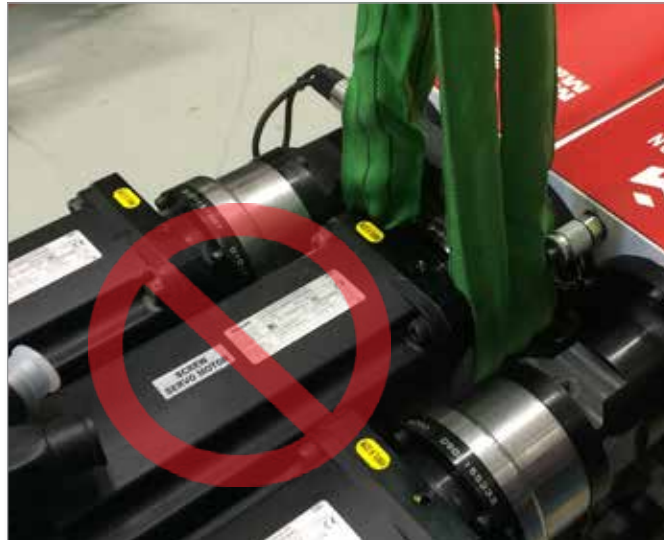
Figure 3-5 Verwenden Sie niemals den Motor als Hebepunkt.
