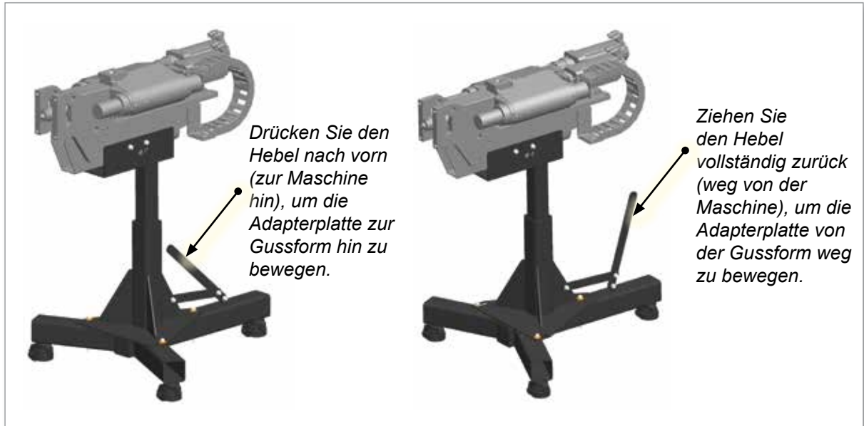
Abbildung 14-4 Kompaktständer – Einstellung der horizontalen Position
