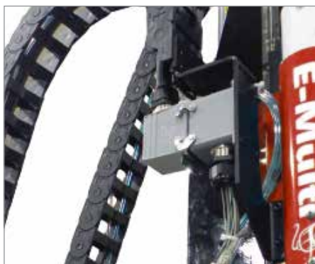
Abbildung 11-7 Installieren des Zylinderheizungsanschlusses
