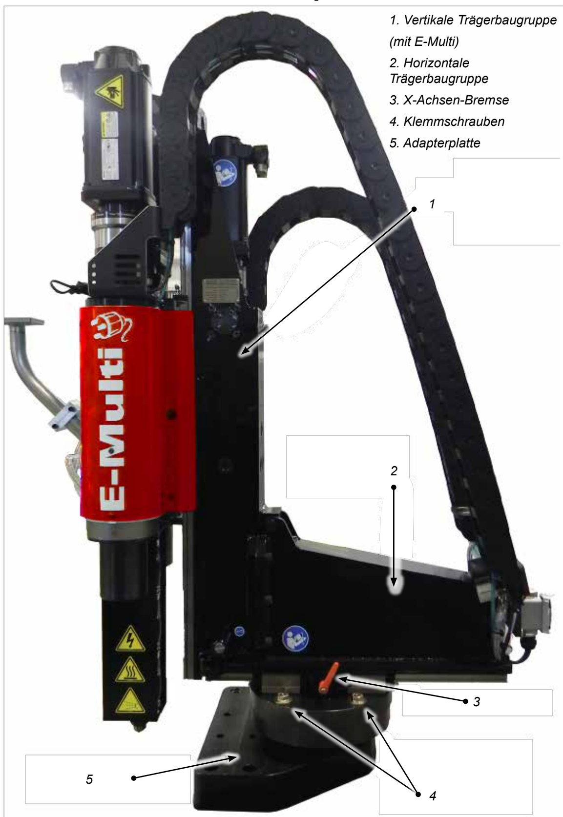
Abbildung 11-1 Hauptkomponenten des E-Multi-Radial-Systems
