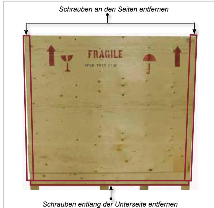
Abbildung 3-8 Schrauben an der Seite und am Boden entfernen
