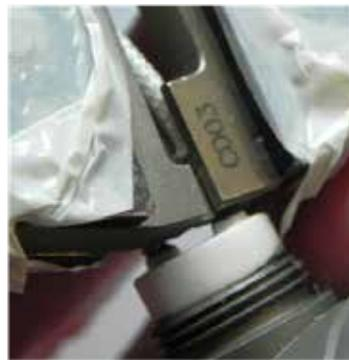
7. Schieben Sie die Keramikisolatoren und die Silikondichtung in Position.
