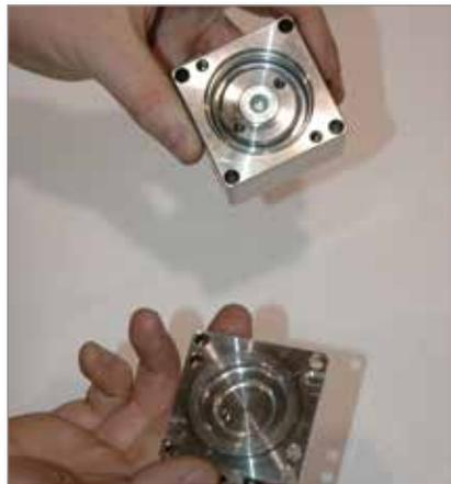
16. Tragen Sie Schraubenpaste auf die Schrauben auf. Montieren Sie die Zylinderkopfschrauben.
