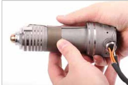
5. Installieren Sie die Halteklammer am Anschlussende. Prüfen Sie, dass das Thermoelement in der Vertiefung des Clips sitzt.
