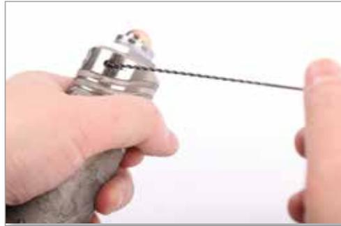
2. Führen Sie das Thermoelement durch die Flanschbohrung ein.
