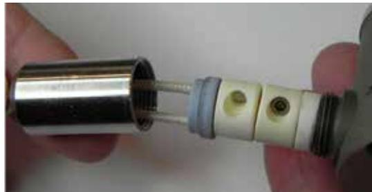
3. Entfernen Sie die Dichtung.
