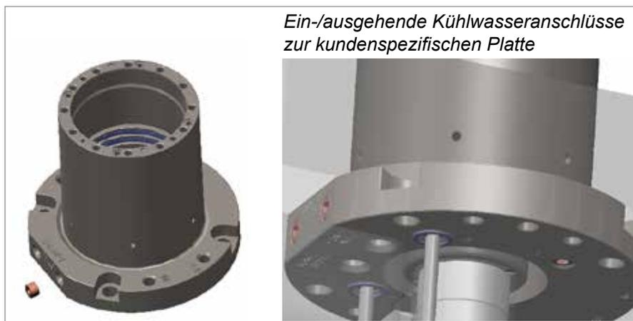
6. Tragen Sie Schmiermittel auf die O-Ring-Nuten auf der Außenfläche des Kolbens auf.
