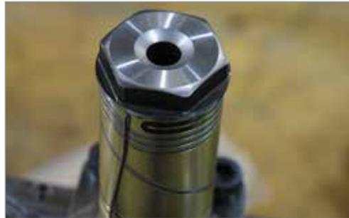
14. Montieren Sie den Thermoelement-Clip.
