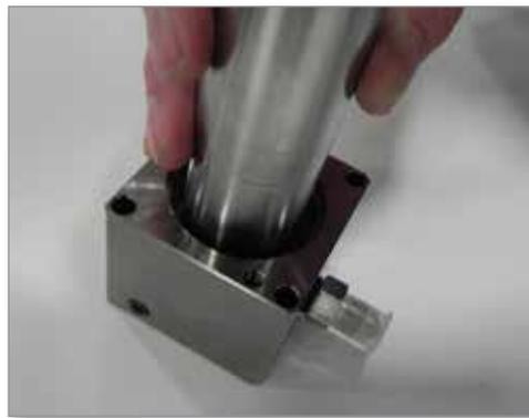
3. Setzen Sie den Sicherungsring der Stangendichtung ein.
