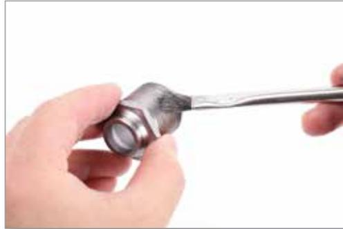
2. Stellen Sie sicher, dass alle Dichtungsoberflächen sauber und trocken sind.
