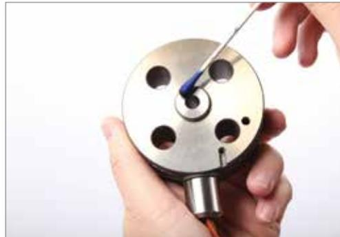
3. Entfernen Sie die Tuschiepaste von allen Komponenten.
