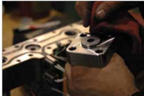
6. Montieren Sie die Verlängerung erneut. Ziehen Sie die Schrauben über Kreuz an und steigern Sie das Anzugsmoment langsam bis zum angegebenen Wert. Die Drehmomente finden Sie in der allgemeinen Montagezeichnung.
