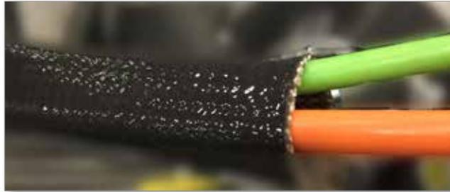
Abbildung 6-24 Versehen der Kabel mit einem Wärmeschutzmantel
