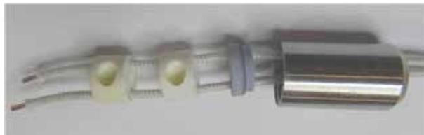
4. Stecken Sie Crimphülsen auf die Kabel. Die Litzen sollten über den Crimp hervorstehen.
