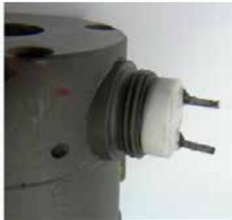
3. Fädeln Sie die Überwurfhülse, die Silikondichtung und die Keramikisolatoren auf die Adern.
