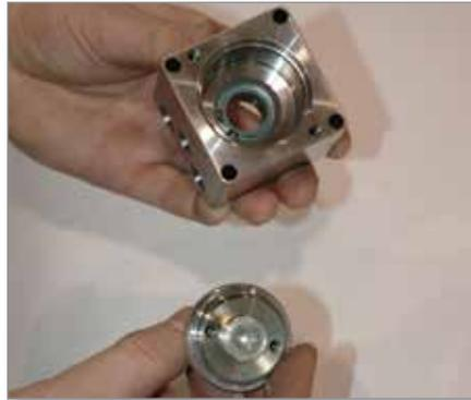
15. Setzen Sie den Zylinderkopf auf das Zylindergehäuse.
