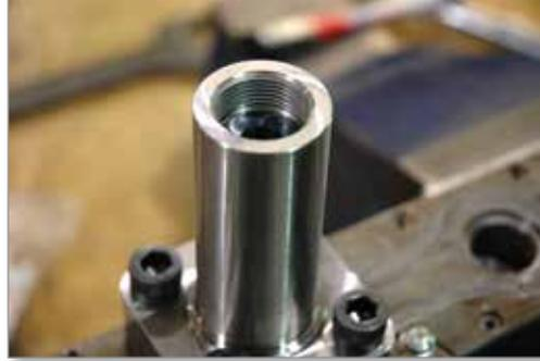
8. Entfernen Sie die Tuscherpaste von der Dichtung und dem Einlass.
