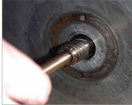
4. Tragen Sie nach dem Schleifen Tuschiepaste auf die Kontaktfläche des Liners auf, um den korrekten Sitz zu überprüfen. Wenn der Liner korrekt sitzt, entfernen Sie die Tuschiepaste von beiden Kontaktflächen.
