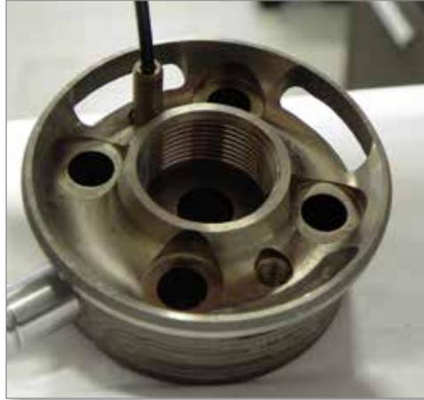
2. Setzen Sie den Kugelstößel mit einem 2,5-mm-Inbusschlüssel (0,10 in.) in den Flansch ein. Achten Sie dabei darauf, dass die Oberseite des Kugelstößels mindestens 0,08 mm (0,003 in.) unterhalb der Flanschoberfläche sitzt.
