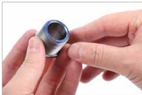
4. Entfernen Sie die Tuschiepaste von den Komponenten.
