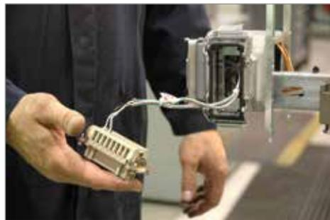
2. Installieren Sie die Steckverbinder im Anschlusskasten.
