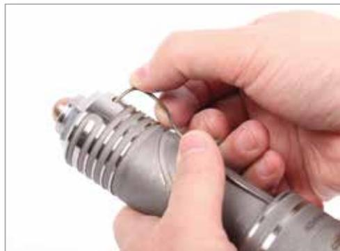
4. Führen Sie das Thermoelement sorgfältig entlang dem Düsenkörper und bringen Sie einen oder mehrere Halteklammern an. Die empfohlene Anzahl Clips für den jeweiligen Düsentyp können Sie der Teileliste entnehmen. Prüfen Sie, dass das Thermoelement in die Vertiefung des Clips passt.
