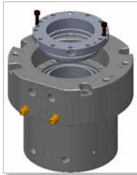
16. Setzen Sie die Isolierplatte auf das Zylindergehäuse und bringen Sie die Stützhülsen an.
