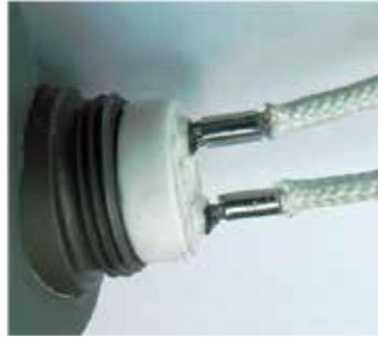
6. Erfassen sie die Crimphülse mit dem Crimpwerkzeug, schieben Sie die Crimphülse über dem Anschlussende in Position und crimpen Sie den Anschluss.
