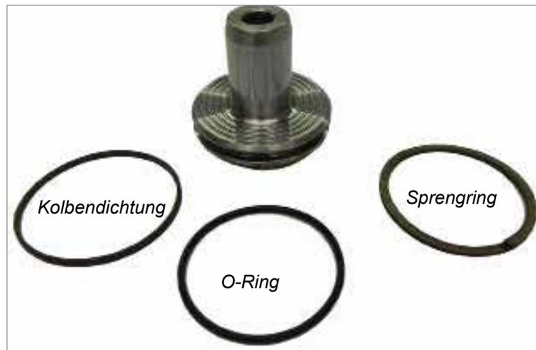
6. Montieren Sie den O-Ring.
