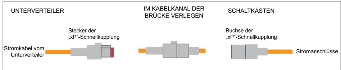
1. Verlegen Sie alle Stromadern zur Brücke, legen Sie die gewünschte Position der Schnellkupplung fest und längen Sie die Adern entsprechend ab.
