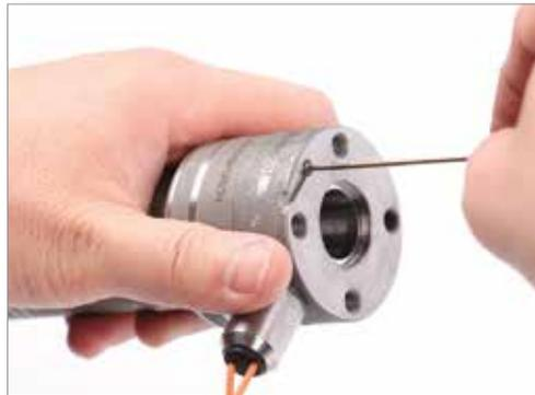
3. Biegen Sie die Spitze des Thermoelements mit dem Daumen um etwa 90°; achten Sie hierbei darauf, dass die abgebogene Länge ausreichend ist, um den Boden der Thermoelement-Bohrung zu erreichen.
