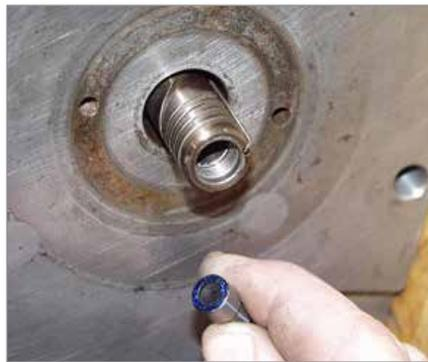
5. Tragen Sie Schraubenpaste (auf Nickelbasis) NUR auf das Gewinde der Ansnittdichtung auf. Achten Sie darauf, dass der Innenbereich des Kanals sauber und frei von Schraubenpaste bleibt.
