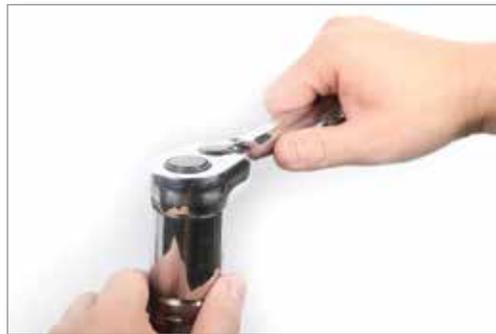
5. Erwärmen Sie die Düse auf Betriebstemperatur und ziehen Sie die Dichtung erneut auf den Drehmomentwert.
