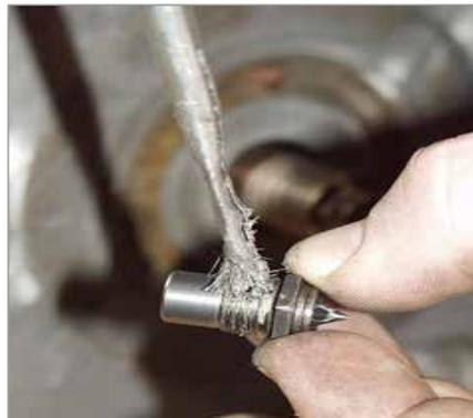
6. Bauen Sie die Ansnittdichtung mithilfe eines Steckschlüssels wieder ein; achten Sie darauf, die Dichtung nicht zu beschädigen.
