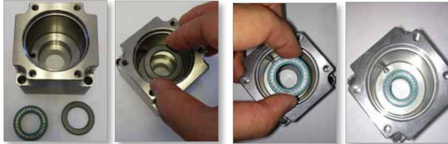
2. Drücken Sie die Dichtungen in das Gehäuse.
