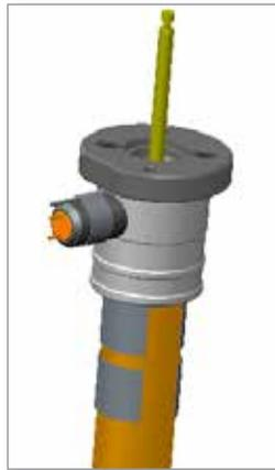
29. Montieren Sie den Heizkörper an der Düsenbaugruppe.
