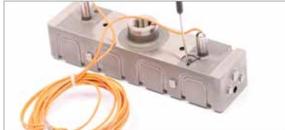
2. Biegen Sie den Thermofühler um 90° nach hinten, um ihn es in den Verteilerkanal einzulegen.
