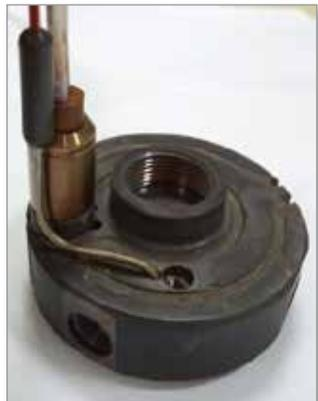
4. Befestigen Sie das Thermoelement mit der Thermoelement-Befestigungsschraube.
