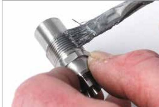
2. Drehen Sie Melt-Link MTL14A in die Düse und Melt-Link MTL14B in die Melt-Disk.
