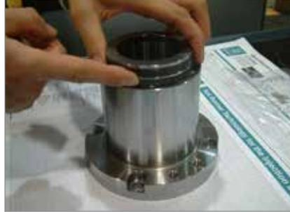
9. Stellen Sie sicher, dass die Ausrichtmarkierungen auf beiden Bauteilen aufeinander ausgerichtet sind.
