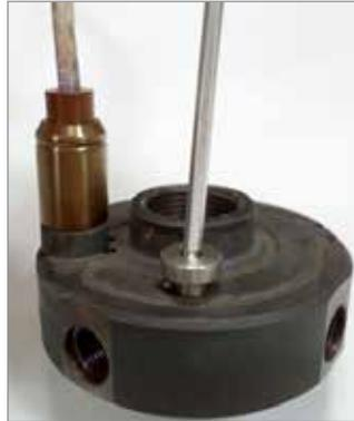
2. Führen Sie die Thermoelementspitze in die Thermoelementbohrung ein, bis sie den Boden des Lochs berührt.
