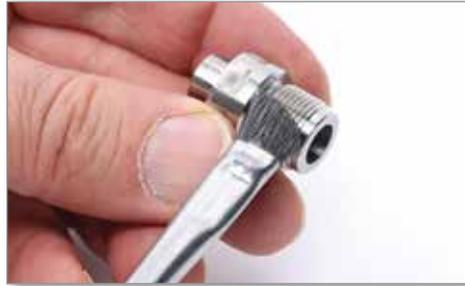
2. Drehen Sie die untere Hälfte des Melt Transfer-Links in den Melt-Cube und die obere Hälfte des Melt Transfer-Links in die Düse ein.
