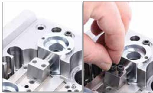
12. Schrauben Sie die Schmelzkeile fest. Stellen Sie sicher, dass die M4-Stellschrauben (SSETSM4X10DM) zurückgezogen sind und in dieser Phase nicht mit dem Melt-Cube in Kontakt treten. Geben Sie Gleitmittel auf SHCSM6X25 und ziehen Sie sie mit der Hand auf ein Drehmoment von etwa 0,79 Nm (oder 7 in-lb) fest, um sicherzustellen, dass alle Komponenten Kontakt miteinander haben.
