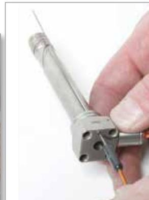
2. Biegen Sie die Spitze des Thermoelements mit dem Daumen um etwa 90°; achten Sie hierbei darauf, dass die abgebogene Länge ausreichend ist, um den Boden der Thermoelement-Bohrung zu erreichen.
