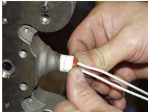
8. Schrauben Sie den Elementzylinder in Position. Stellen Sie sicher, dass der Silikonzylinder nicht zusammen mit dem Zylinder rotiert, um Schäden am Kabel zu vermeiden.
