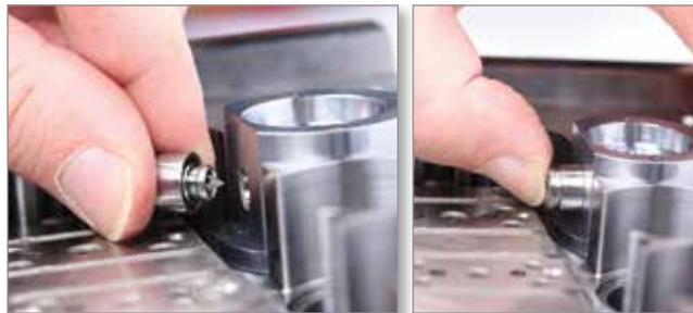
9. Setzen Sie die Keilstifte zum Fixieren der Schmelzkeile ein.
