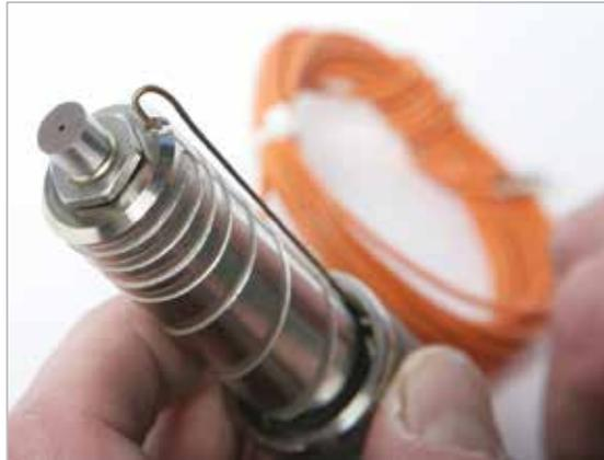
5. Stellen Sie sicher, dass sich das Thermoelement vollständig im Düsenkörper befindet, während Sie das Thermoelement am Flansch biegen.
