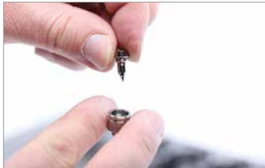
8. Vergewissern Sie sich, dass die Außenseite der Transferdichtung sauber ist. Schieben Sie die Transferdichtung in die Einlassöffnung der Kavität ein.
