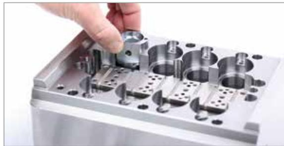
6. Alle Kavitätsausrichtungsmerkmale, wie Stifte oder Nocken müssen hierbei exakt eingesetzt werden. Im Beispiel unten sind die seitlichen Kavitätsarretierungen / Drehsicherungsstifte installiert. Wiederholen Sie den Vorgang für alle Kavitäten.
