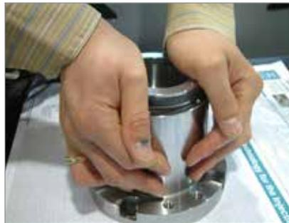
11. Setzen Sie den O-Ring in den Zylinderkopf ein und montieren Sie ihn am Zylinderkörper.
