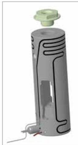
20. Befestigen Sie die Anschnittdichtung und die Innenisolierung an der Düse.
