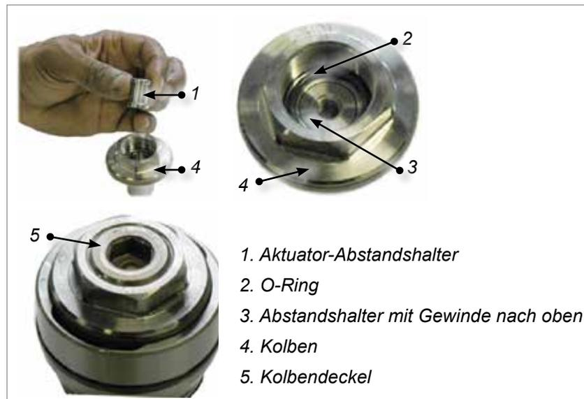
Abbildung 10-19 Installation des Kolben-Abstandshalters
