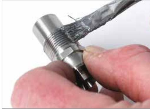
2. Schrauben Sie den Melt-Link in die Düse.
