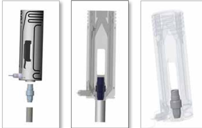
19. Installieren Sie die Einlassspitze im Heizkörper und ziehen Sie sie mit einem Drehmoment von 61 Nm (45 lbf-ft) fest.
