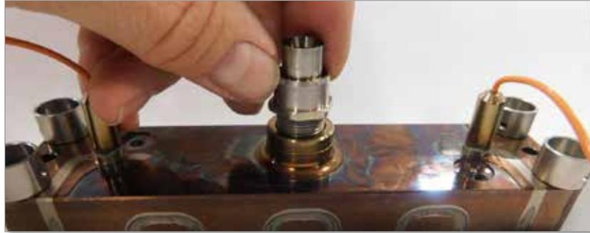
Abbildung 19-15 Installation der unteren Hälfte des Melt Transfer-Links
