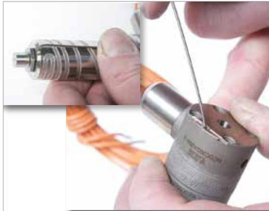
6. Drücken Sie das Thermoelement nach unten gegen das Anschlussende und befestigen Sie es mit wärmebeständigem Band an der Seite des Anschlussendes, um sicherzustellen, dass es nicht zwischen Düse und Verteiler eingeklemmt wird.
