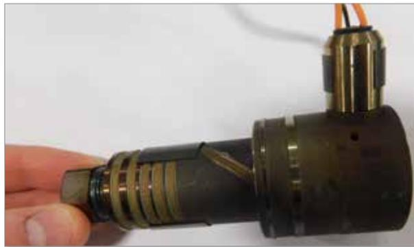
Abbildung 19-16 Installation der oberen Hälfte des Melt Transfer-Links
