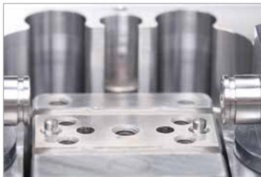
10. Stellen Sie sicher, dass alle Schmelzkeilflächen und Dichtungen sauber sind. Positionieren Sie die Dichtungen in den Schmelzkeilen.
