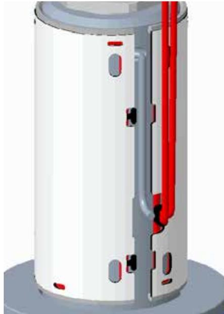
4. Stellen Sie sicher, dass die Notfall-Heizmanschette auf das Ende der Schräge am Düsenkörper ausgerichtet ist.
