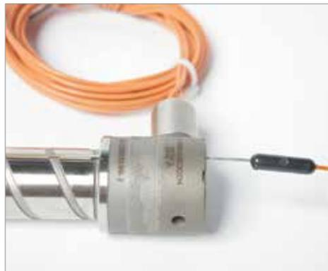
3. Platzieren Sie das Ende des Biegewerkzeuges vollständig über dem Ende des Thermoelements. Stützen Sie das Thermoelement und erzeugen Sie mit dem Werkzeug eine 180° „Angelhaken“-Form. Stellen Sie sicher, dass das Biegewerkzeug eng am Thermoelement anliegt.
