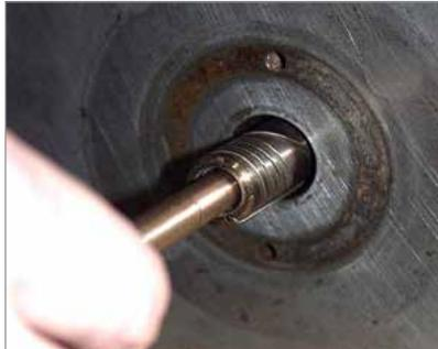
4. Tragen Sie nach dem Schleifen Brünierpaste auf die Innenisolierung an die Düse auf, um eine korrekte Verbindung sicherzustellen. Besteht guter Kontakt der Innenisolierung, reinigen Sie die Brünierpaste von beiden Seiten.
