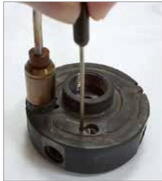
3. Biegen Sie das Thermoelement um 90° zum Anschluss.
