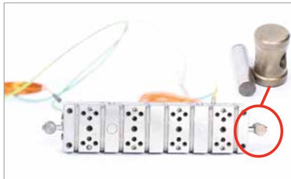
2. Montieren Sie den Melt-Cube-Positionsanzeiger hinten an den Kavitätenblock. Installieren Sie Abstandshalter hinten an den Melt-Cube.
