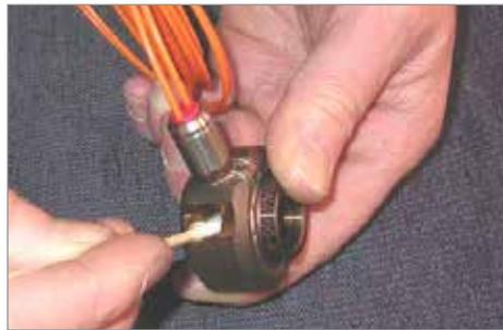
4. Tragen Sie Gleitmittel auf die Gewinde der Anschnittdichtungen auf; verwenden Sie hierzu das von *Mold-Masters* gelieferte Mittel.
