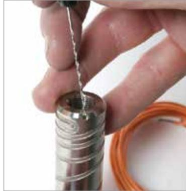
2. Führen Sie das Thermoelement durch den Düsenflansch ein.
