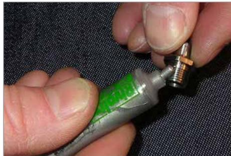
5. Setzen Sie das spitze Ende der Spitze (Torpedo) in das Gewindeende der Anschnittdichtung ein.
