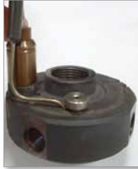
5. Bringen Sie die Düsenkabel und die Thermoelementkabel zusammen mit hitzebeständigem Klebeband direkt über dem Isolatorgehäuse an.
