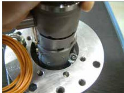
23. Befestigen Sie den Ventilstifthalter am Kolben. Ziehen Sie die Teile gemäß den Angaben der allgemeinen Montagezeichnung fest.
