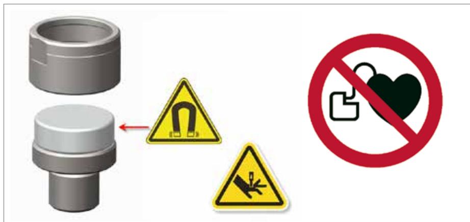
Abbildung 14-2 Mag-Pin-Sicherheitsgefahren
