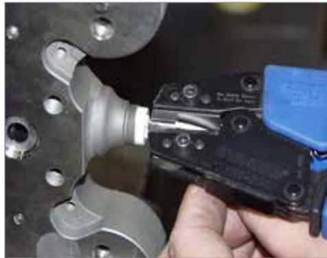
7. Schieben Sie den Keramikisolator und die Silikondichtung in Position.
