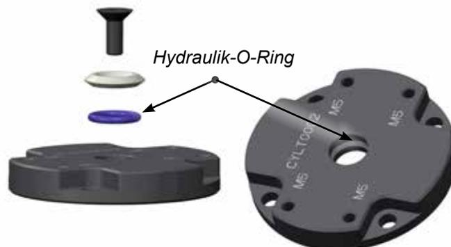
10. Montieren Sie den Zylinderkopf. Der Kolbendeckel ragt aus dem Zylinderkopf.
