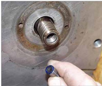
5. Tragen Sie Gleitmittel auf Nickelbasis NUR auf die Gewinde der Ansnittdichtung auf. Stellen Sie sicher, dass der interne Kanal sauber und frei von Gleitmittel ist.
