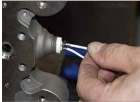
6. Greifen sie den Crimp mit dem Crimpwerkzeug, schieben Sie den Crimp über der Polklemme in Position und crimpen Sie den Anschluss.
