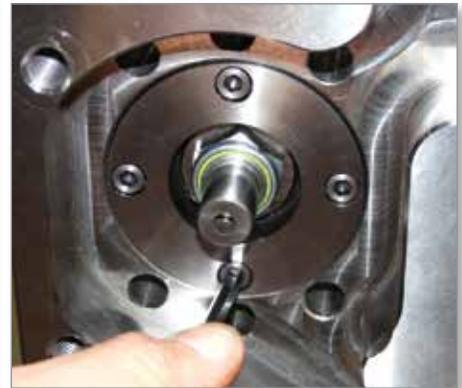
3. Montieren Sie die Kugelmutter auf der Kugelumlaufspindel mit einem Drehmoment von 43 bis 45 Nm (31,7 bis 33,1 lbf-ft).
