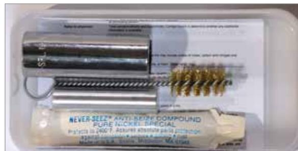
Abbildung 15-10 Werkzeuge der Sprintverschlussdichtung
