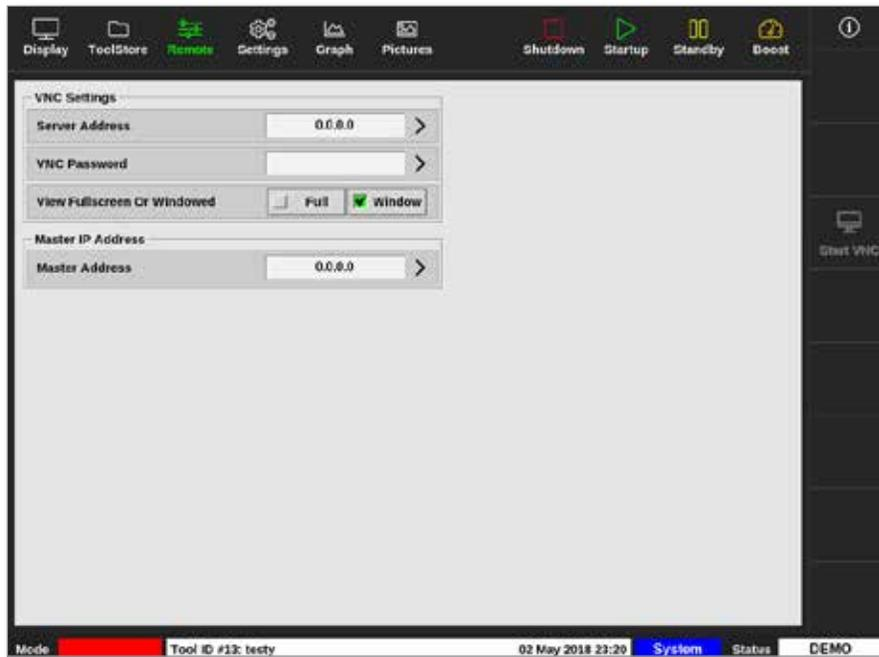
Figure 6-26 Remote-Bildschirm mit dem Fensterbereich [VNC Settings] (VNC-Einstellungen)
