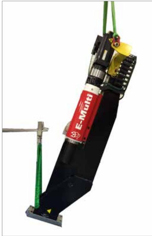
8. Apoye la unidad de inyección E-Multi sobre la placa adaptadora. Coloque la unidad de inyección E-Multi en una superficie que no estropee la placa adaptadora (madera, cartón, etc.).
