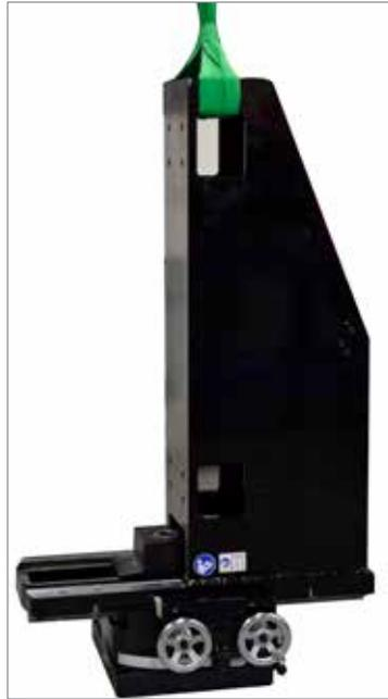
4. Instale la viga horizontal en la placa adaptadora. Inserte y apriete a mano los 4 pernos (M20X90) en los orificios accesibles.
