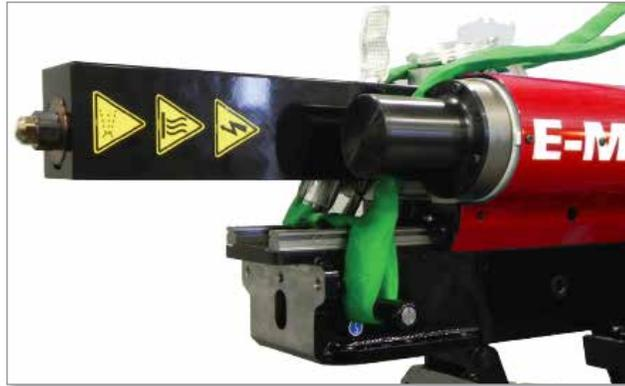
*Figura 11-3 Sujeción de la eslinga delantera*
