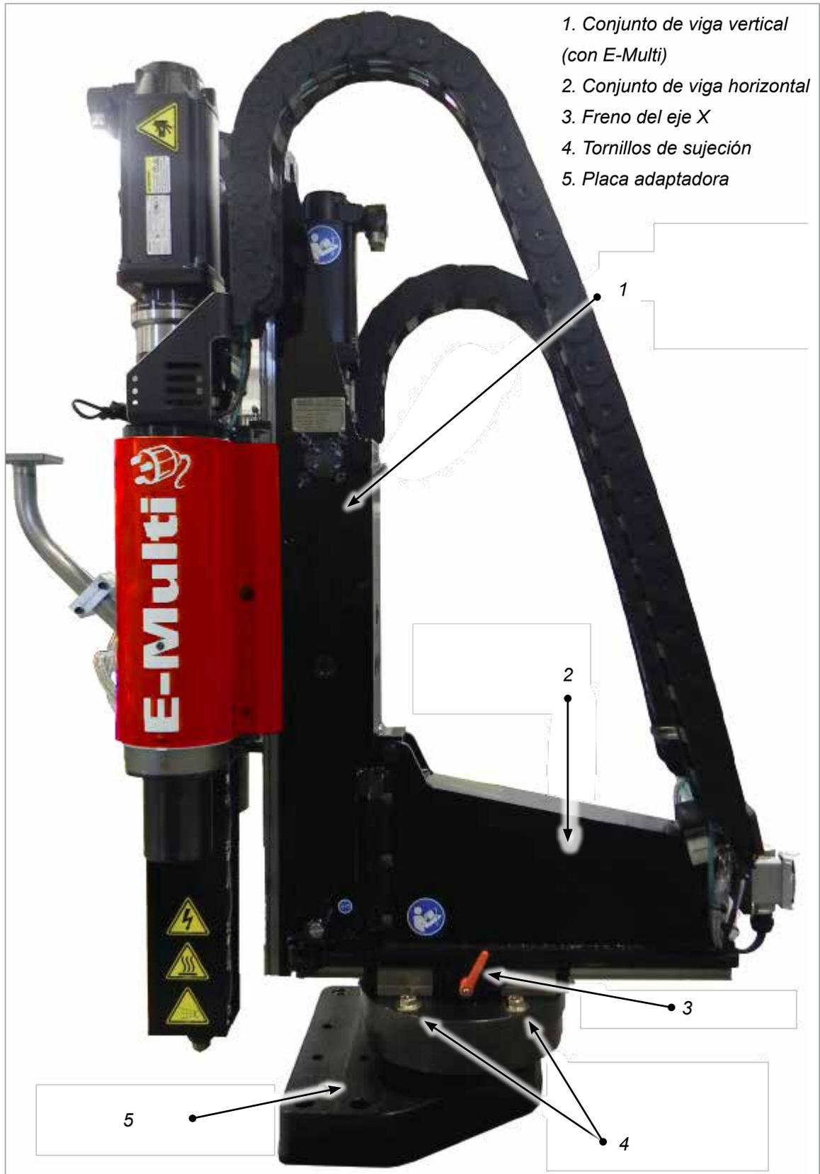
Figura 11-1 Componentes principales del E-Multi Radial
