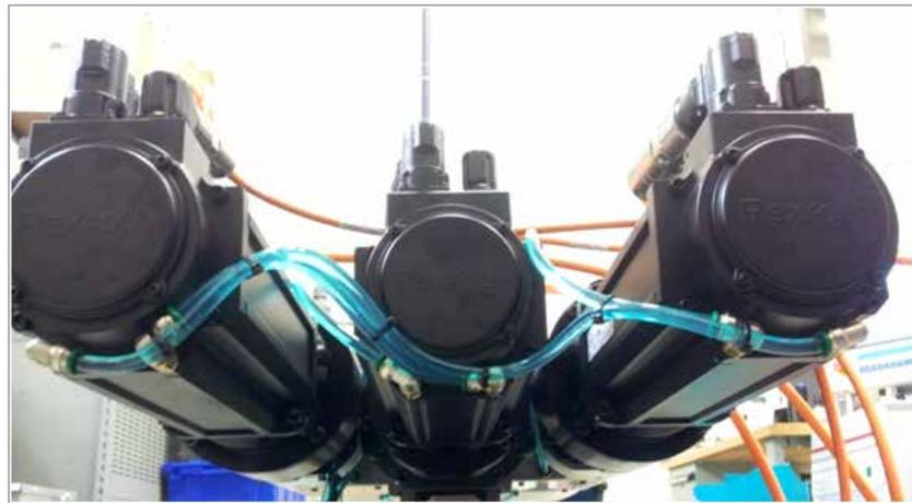
Figura 7-8 Conexiones de enfriamiento del servomotor EM3 / EM4
