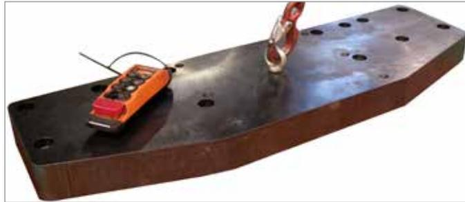
2. Coloque la placa adaptadora en la platina fija. Instale los pernos (M20X90) en un patrón cruzado y apriételos a 339 Nm (250 pies-libras).
