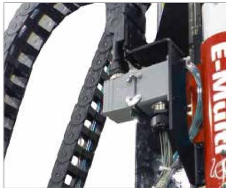
Figura 11-7 Instale el conector del calentador del cañón
