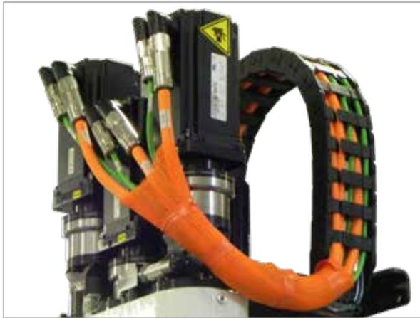
Figura 7-1 Enrutamiento del cable del servo EM3
