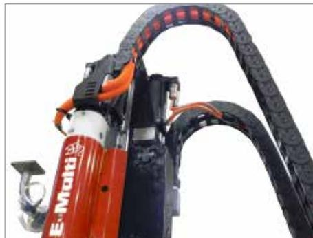
Figura 11-8 Conecte los cables del servomotor
