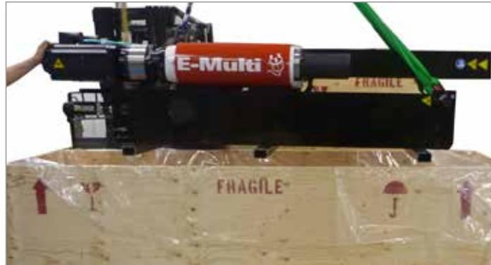
12. Fije la barra de elevación a la viga vertical. Conecte una eslinga de tela de 4 pulgadas (suministrada) a cada extremo de la barra de elevación con una configuración de gargantilla.
