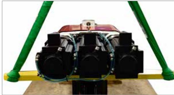
13. Levante la viga vertical con dos dispositivos de elevación. Si se utiliza una grúa y un montacargas, la grúa debe levantar el extremo de la barra de elevación.
