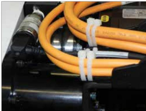
Figura 7-2 Cables sostenidos con bridas de alambre
