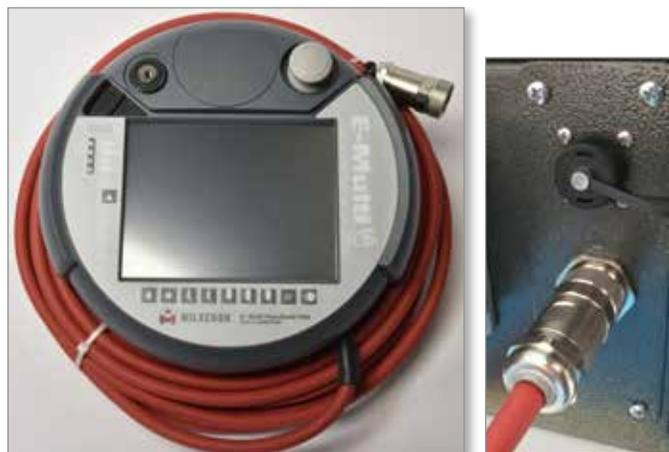
Figura 7-5 HMI portátil y conexión
