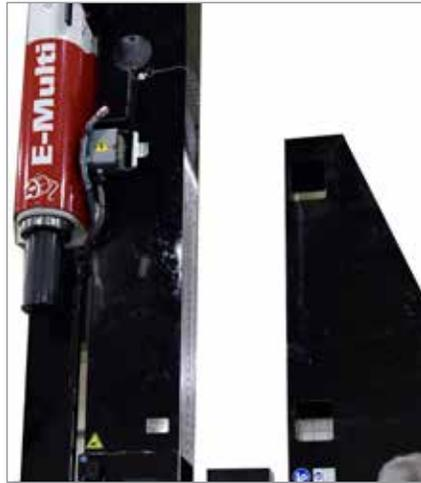
16. Instale los 8 tornillos (M16X50), sujete la viga vertical a la viga horizontal y apriételes a mano.
