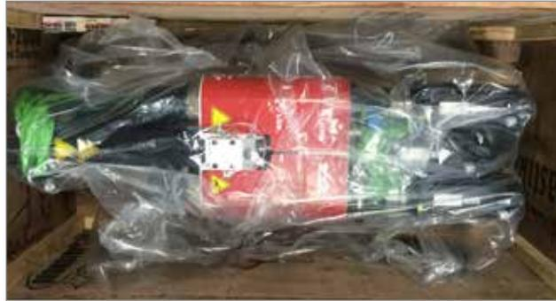
4. Retire los cuatro tornillos tirafondos de 3/8" de los extremos de los soportes de envío con un tornillo cilíndrico de hexágono interior de 14 mm (9/16 pulg.).
