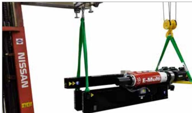
14. Cambie la orientación de la viga para que la viga esté vertical con la barra de elevación en la parte superior.
