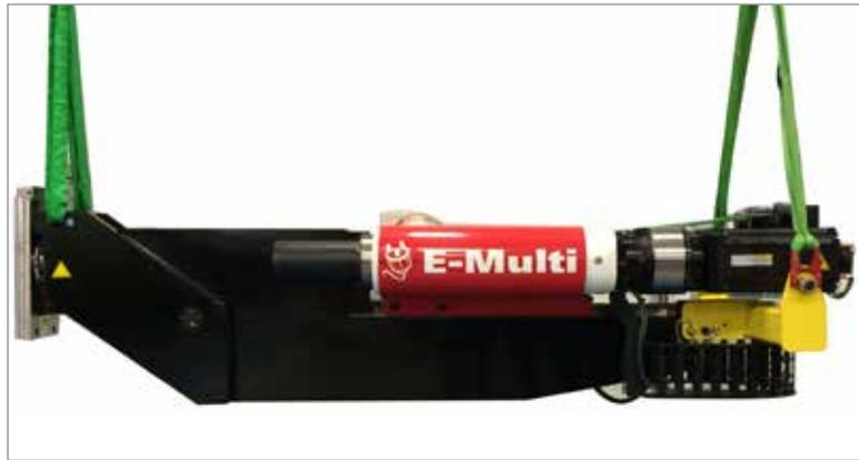
6. Eleve el extremo del motor de la unidad. Mantenga las máquinas de elevación centradas sobre sus respectivos puntos de elevación.
