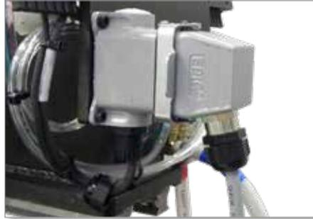
Figura 11-9 Instale el conector de E/S
