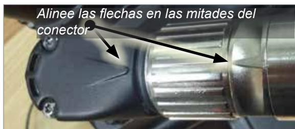
Figura 7-3 Corrija la alineación del conector
