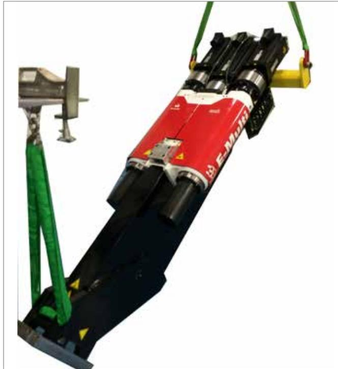
4. Mueva la máquina de elevación hacia arriba y hacia adelante (hacia el extremo del cañón de la unidad de inyección E-Multi), manteniendo la máquina de elevación centrada sobre la unidad.
