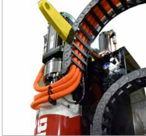
25. Corte las bridas de cables que sujetan el conducto de cables pequeño al conducto de cables grande.
