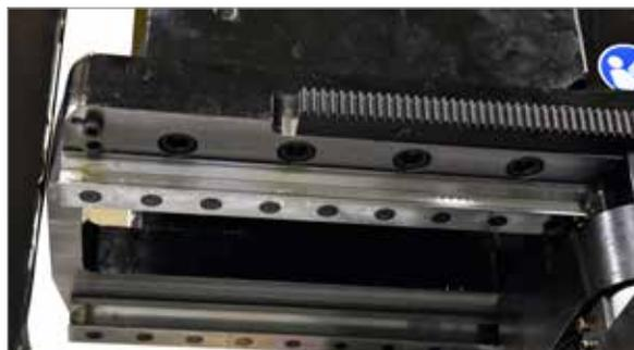
18. Apriete los cuatro pernos inferiores (M16X50) en la viga vertical a 122 Nm (90 pies-libras) en un patrón cruzado y repita esto para los cuatro pernos superiores en la viga vertical.
