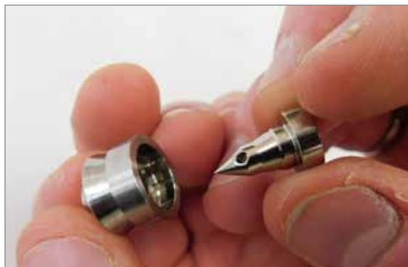
Figura 19-23 Instalación del torpedo
