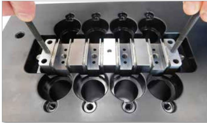
Figura 19-20 Instalación del colector de Melt-CUBE
