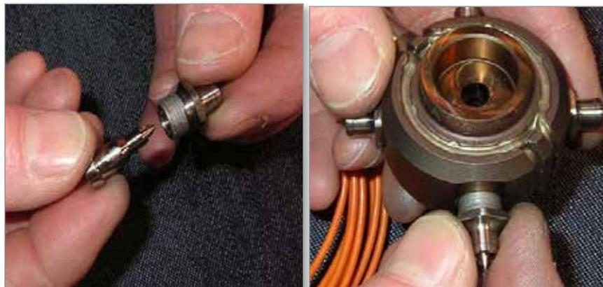
6. Enrosque el conjunto del sello de la compuerta en el Melt-Disk. Fije el Melt-Disk en un tornillo de banco blando y apriete los sellos de la compuerta en frío al valor especificado a continuación o en el plano de ensamblaje general. No apriete demasiado el tornillo de banco. Asegúrese de que ninguno de los componentes se dañe.
