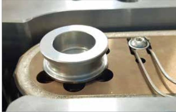
Figura 5-34 Cojinetes de soporte para sistemas con MasterSHIELD
