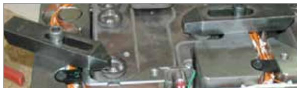
Figura 15-1 Abrazaderas del colector
