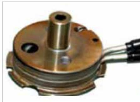
Figura 5-16 Cojinete de válvula calentado
