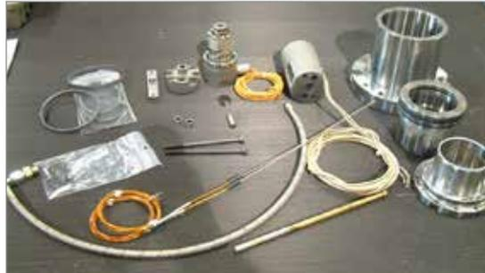
2. Coloque la arandela de respaldo del cilindro y la junta tórica en la ranura del cuerpo del cilindro. Doble el anillo rígido del cilindro en forma de riñón e insértelo en su sitio en el cuerpo del cilindro.
