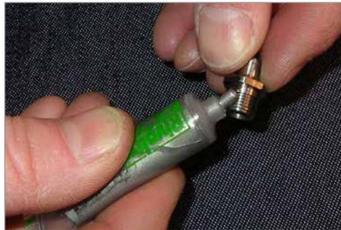
5. Inserte el extremo puntiagudo de las puntas (torpedos) en el extremo roscado del sello de la compuerta.
