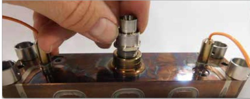
Figura 19-15 Instalación de la mitad inferior de la conexión de transferencia de colada
