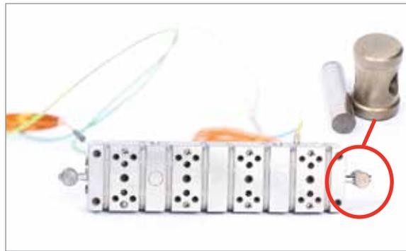
2. Instale el localizador de centro de Melt-CUBE en la parte posterior del bloque de cavidades. Instale soportes espaciadores en la parte posterior del Melt-CUBE.
