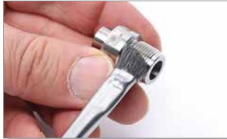
2. Enrosque la mitad inferior de la conexión de transferencia de colada en el Melt-CUBE y la mitad superior de la conexión de transferencia de colada en la boquilla.
