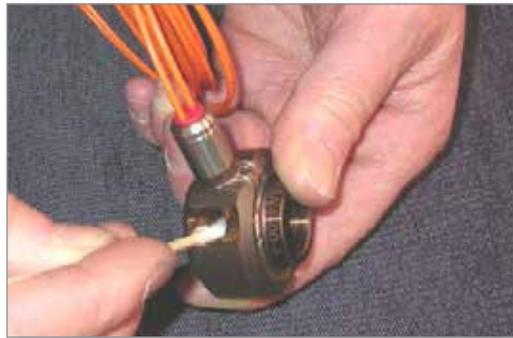
4. Aplique compuesto antiagarrotamiento a las roscas de los sellos de la compuerta, usando el compuesto suministrado por *Mold-Masters*.
