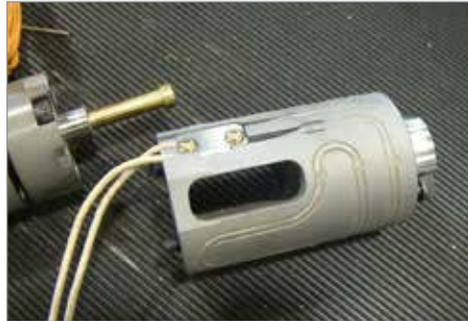
17. Coloque el cuerpo del calentador sobre el conjunto.
