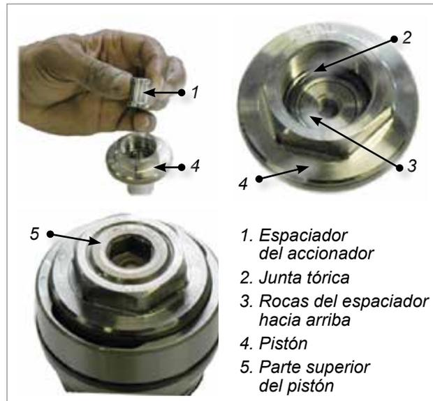
Figura 10-19 Instalación del espaciador del pistón
