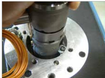
23. Fije el soporte de clavija de la válvula al pistón. Apriete según las especificaciones detalladas en el plano de ensamblaje general.
