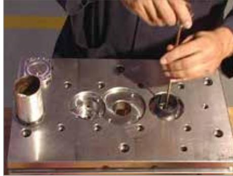
Figura 10-20 Instalación del pistón y la clavija de la válvula
