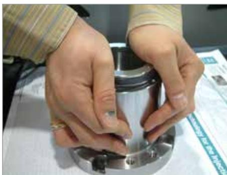
11. Inserte la junta tórica en la parte superior del cilindro y ensámblela en el cuerpo del cilindro.
