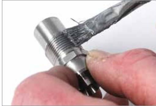
2. Enrosque Melt-Link MTL14A en la boquilla y Melt-Link MTL14B en el Melt-Disk.
