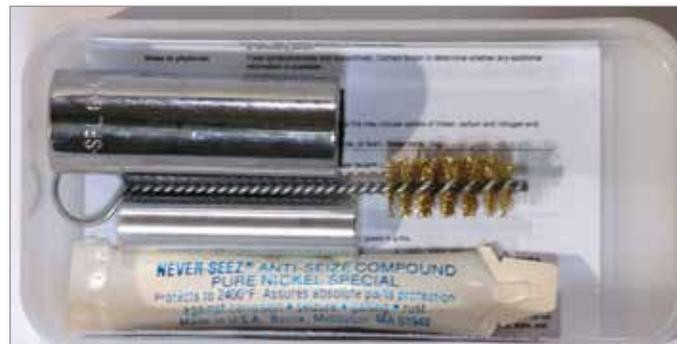
Figura 15-10 Herramientas del sello de la compuerta Sprint
