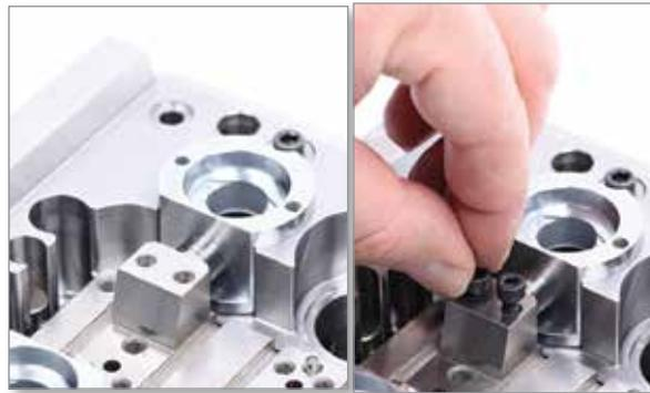
12. Instale la cuña de carga entre las cuñas de colada. Asegúrese de que los tornillos de fijación M4 (SSETSM4X10DM) estén retraídos y no entren en contacto con el Melt-CUBE en este paso. Aplique compuesto antiagarrotamiento al SHCSM6X25 y apriete a mano con un par de apriete de aproximadamente 0,79 Nm (7 pulg-lb) para asegurarse de que todos los componentes tengan el contacto adecuado.
