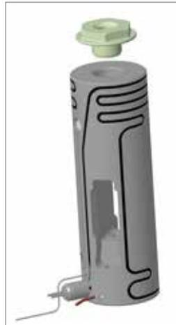
20. Coloque el sello de la compuerta y el revestimiento en la boquilla.
