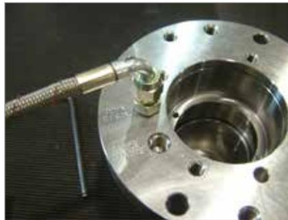
14. Coloque el sello de la compuerta y el revestimiento en la boquilla. Apriete según las especificaciones detalladas en los planos de ensamblaje general. Coloque el termopar de la boquilla.
