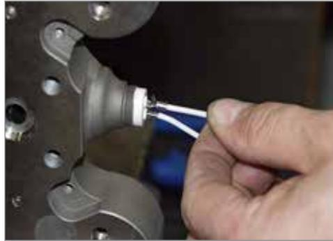
6. Sujete el engarzado con la herramienta engarzadora, introduzca en su posición el engarzado deslizándolo sobre el poste de terminal y engarce la conexión.
