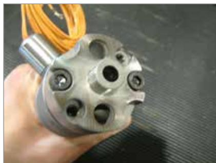
**Montaje de Accu-Line™ con cojinete de válvula
