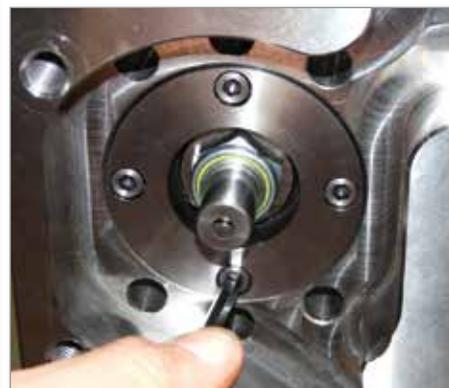
3. Ensamble la tuerca de bola en el tornillo de bola con un par de 43-45 Nm (de 31,7 a 33,1 lbf-ft).
