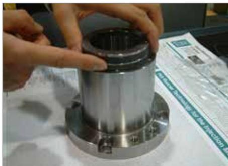
9. Asegúrese de que las marcas de sincronización en ambos componentes estén alineadas.
