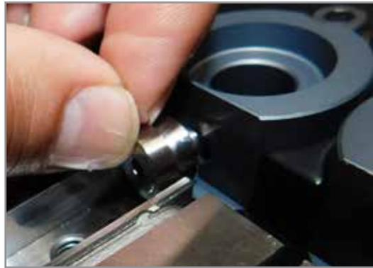
*Figura 19-25 Instalación del sello de la compuerta*
