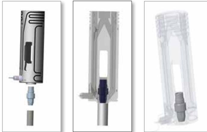
19. Instale la punta de entrada en el cuerpo calentado y apriete a un par de 61 N·m (45 lbf-ft).
