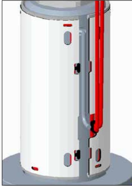
4. Asegúrese de que el calentador de emergencia quede alineado con el extremo del chaflán del cuerpo de la boquilla.
