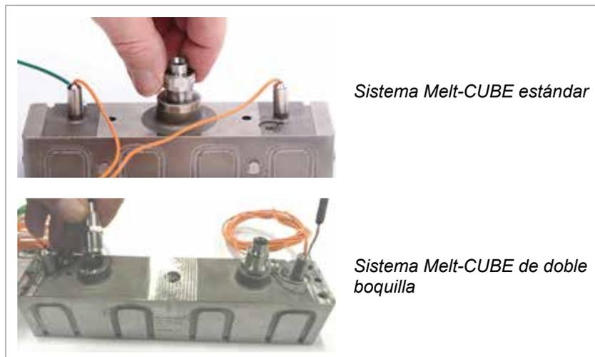
3. Apriete la conexión de transferencia de colada al valor especificado en la tabla de par de apriete o el diagrama de ensamblaje general. Consulte la precaución anterior.
