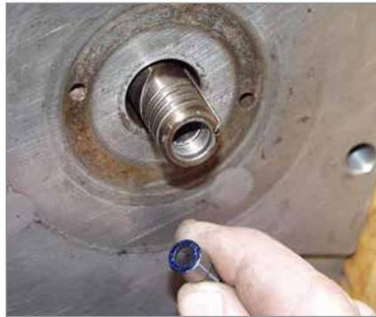
5. Aplique antiadherente con base de níquel SOLO a las roscas del sello de la compuerta. Asegúrese de que el canal de colada interno esté limpio y sin compuesto antiagarrotamiento.
