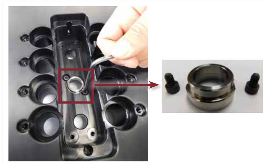
Figura 19-18 Instalación del localizador de centro
