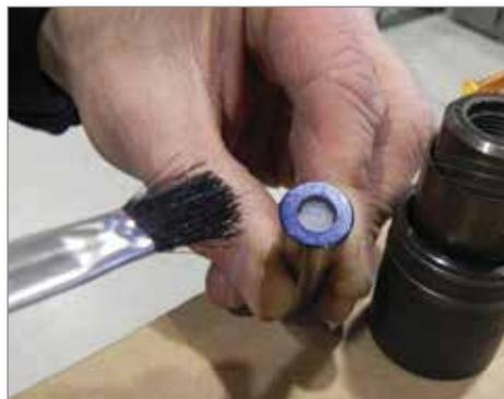
4. Después de asegurar un buen contacto, limpie el compuesto azul de tintado de ambas superficies.
