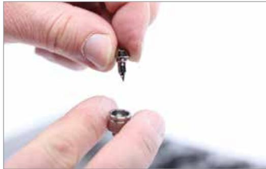
8. Asegúrese de que el exterior del sello de transferencia esté limpio. Introduzca el sello de transferencia de ajuste en el orificio de inserción de la cavidad deslizándolo.
