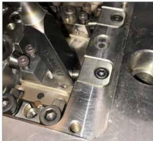
**Diseño B de Melt-CUBE: Desensamblaje del sello de transferencia/torpedo y bloque de colada (continuación)**
