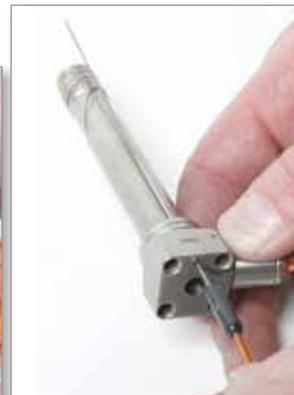
2. Doble manualmente la punta del termopar contra su pulgar a aproximadamente en un ángulo de 90 °, asegurando una longitud de la doblez suficiente para alcanzar la parte inferior del orificio del termopar.
