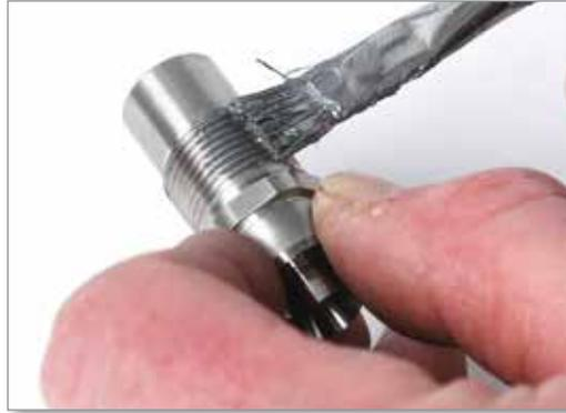
2. Enrosque el Melt-Link en la boquilla.
