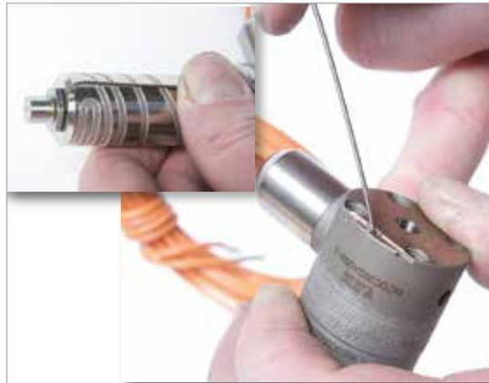
6. Presione el termopar hacia abajo para que se asiente contra el extremo del terminal y fíjelo en el lateral del extremo del terminal con cinta resistente al calor para asegurarse de que no se pellizque entre la boquilla y el colector.
