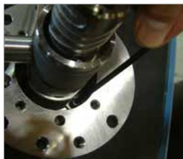
**Montaje de Accu-Line™ con cojinete de válvula
