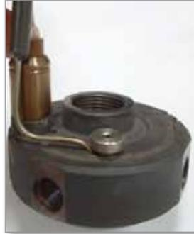
5. Utilice cinta adhesiva resistente al calor justo por encima de la vaina aislante para unir los cables de la boquilla y los del termopar.
