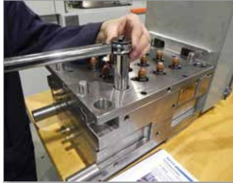
3. El sello de la compuerta, el torpedo y la tapa aislante deben salir de la boquilla como una unidad. Si el torpedo permanece en la boquilla después de retirar el sello de la compuerta, aumente la temperatura de la boquilla en 15 °C (59 °F) o 5 % de la corriente y retire el torpedo usando pinzas con mordazas blandas.
