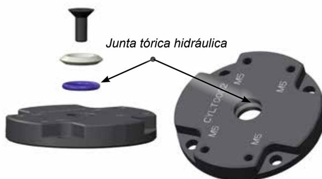
10. Instale la parte superior del cilindro. La parte superior del pistón sobresaldrá de la parte superior del cilindro.
