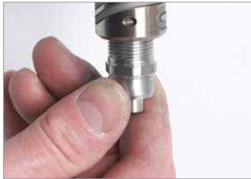
3. Apriete el Melt-Link en FRÍO al valor especificado en el plano de ensamblaje general.
