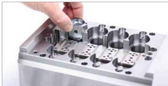
6. Cualquier característica de alineación de la cavidad, como clavijas o levas, debe insertarse correctamente en este momento. En el siguiente ejemplo, se instalan retenedores/clavijas antirotación en el lado de las cavidades. Repítalo en todas las cavidades.
