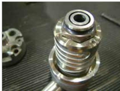
15. Coloque el cojinete de la válvula. Apriete según las especificaciones detalladas en el plano de ensamblaje general.
