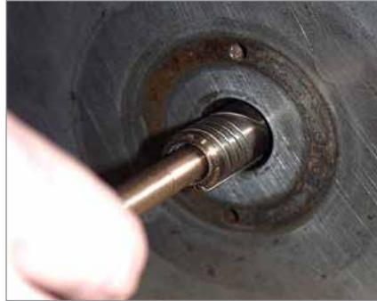
4. Una vez que finaliza el pulido, aplique el compuesto azul de tintado al recubrimiento de la boquilla para asegurar un acople adecuado. Si el recubrimiento hace buen contacto, retire el compuesto azul de tintado de ambas superficies. Si el revestimiento está haciendo buen contacto, limpie el compuesto azul de tintado de ambas caras.
