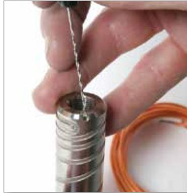
2. Coloque el termopar a través de la brida de la boquilla.
