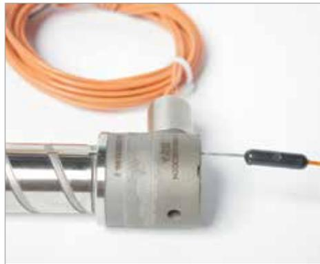
3. Coloque el extremo de la herramienta de plegado completamente sobre el extremo del termopar. Mientras sostiene el termopar, cree un "anzuelo" de 180 ° con la herramienta. Asegúrese de que la herramienta de plegado quede ajustada contra el termopar.
