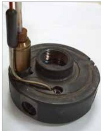
4. Conecte el termopar con el tornillo de retención del termopar.
