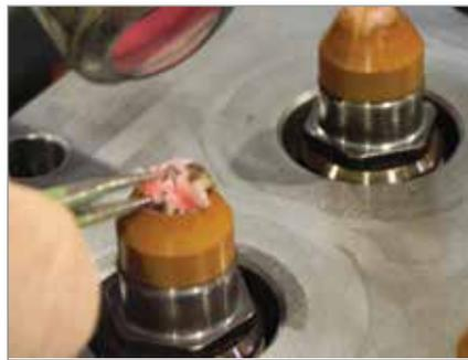
**15.8 Instalación de la tapa aislante de la boquilla**
