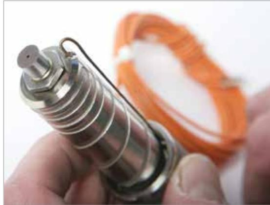
5. Asegúrese de que el termopar quede completamente acoplado en el cuerpo de la boquilla mientras pliega el termopar en la brida.
