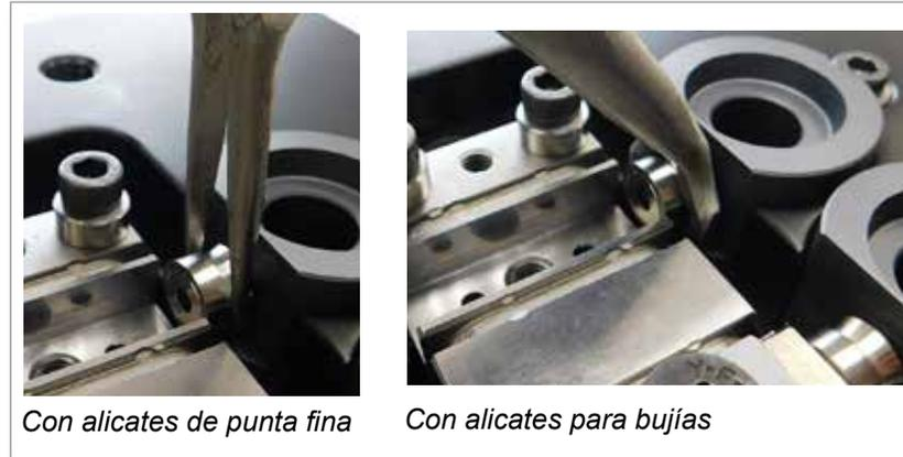
Figura 19-30 Extracción del sello de la compuerta
