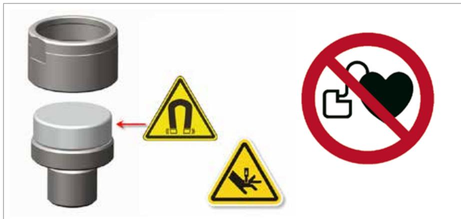
Figura 14-2 Riesgo de seguridad de Mag-Pin
