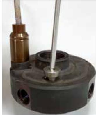
2. Inserte la punta del termopar en el orificio del termopar hasta que toque el fondo del orificio.
