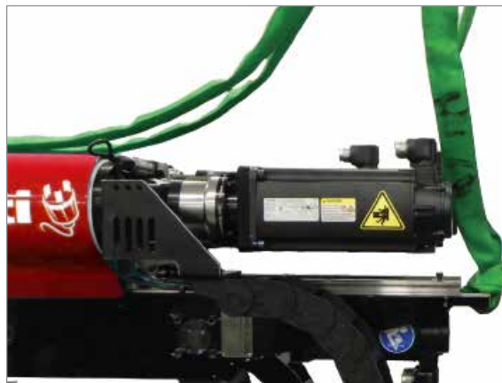
Illustration 11-5 Fixation de l'élingue arrière
