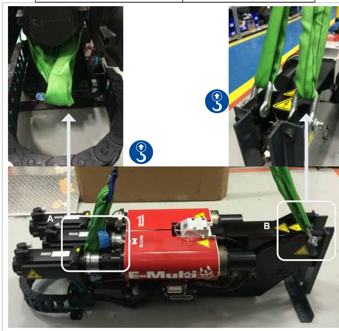
Illustration 3-6 Raccordements de levage horizontal EM3. La situation est similaire pour les modèles EM1 / EM2.
