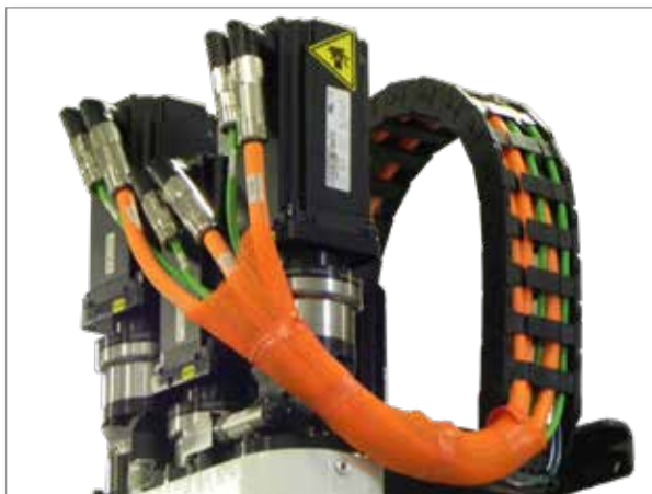
Illustration 7-1 Acheminement des câbles de servo pour le modèle EM3
