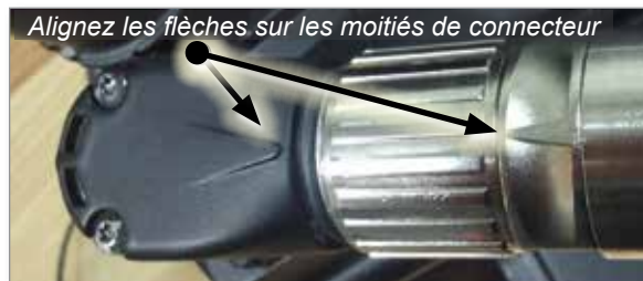
Illustration 7-3 Alignement correct des connecteurs.
