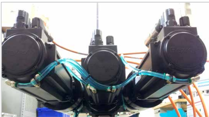
Illustration 7-8 Connexions de refroidissement du servomoteur sur les modèles EM3 / EM4
