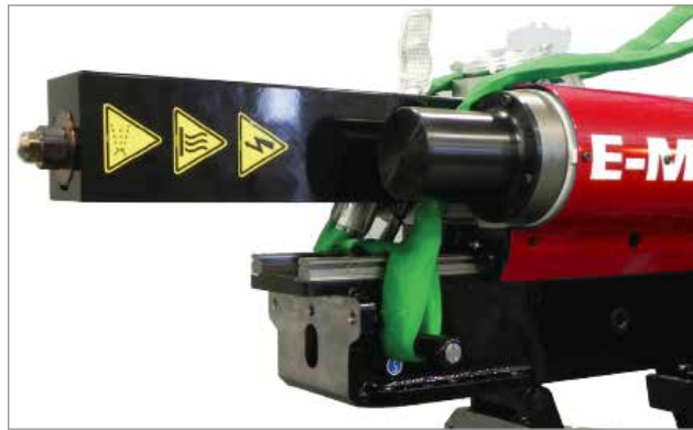
Illustration 11-4 Fixation de l'élingue avant
