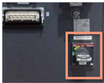
Illustration 6-1 Interrupteur d'alimentation principal du contrôleur E-Multi
