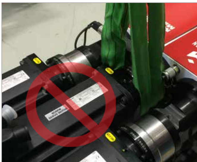
Illustration 3-12 N'utilisez pas le moteur comme point de levage
