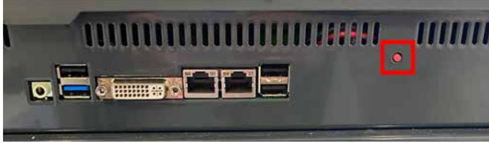
*Illustration 6-2 Emplacement de l'interrupteur marche/arrêt de la console*
