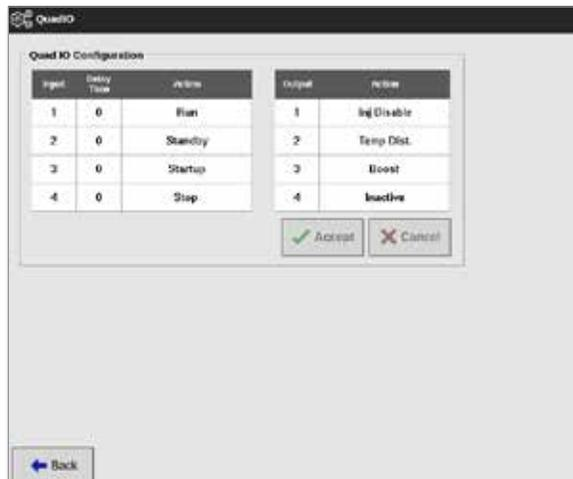
Quatre entrées et quatre sorties sont répertoriées. Les colonnes de temps de retard et d'action sont configurables par l'utilisateur.
