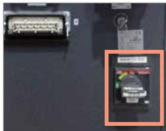
Figura 6-1 Interruttore di alimentazione principale di E-Multi
