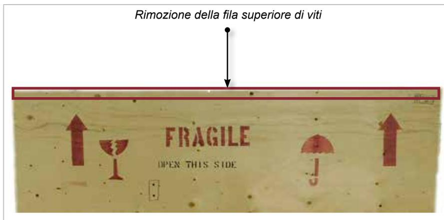
*Figura 3-6 Rimozione della fila superiore di viti*
