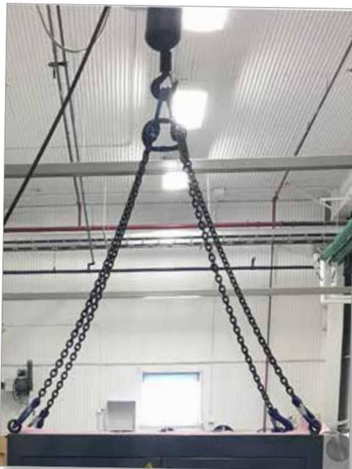
Figura 3-11 Fissaggio delle imbracature a tutti e quattro i golfari
