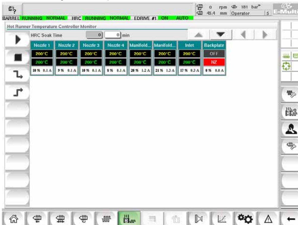
Figura 7-10 Schermata di monitoraggio dell'unità di controllo della camera calda
