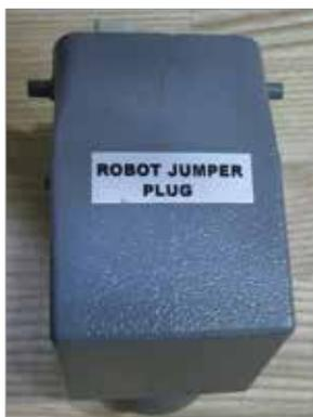
Figura 5-2 Spina a ponticello del robot
