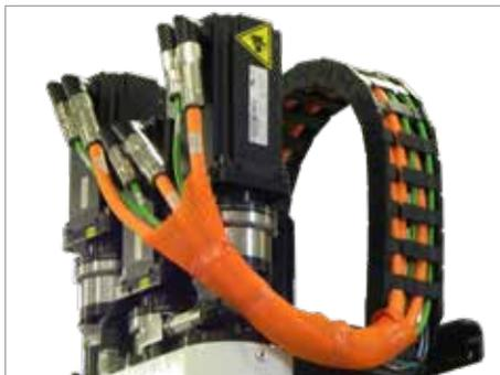
Figura 5-1 Disposizione dei cavi dei servomotori dell'EM3
