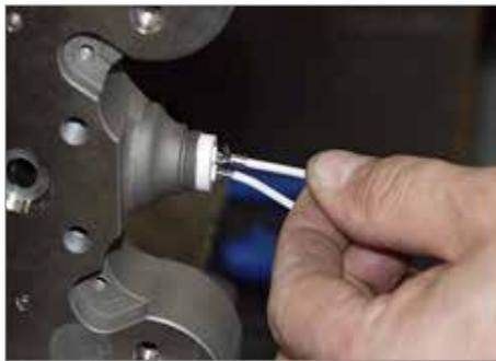
6. Afferrare il connettore a crimpare con la crimpatrice, farlo scorrere in posizione sul polo del terminale e crimpare il collegamento.
