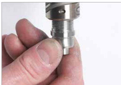
3. Serrare il Melt-Link FREDDO utilizzando il valore di coppia specificato nello schema di assemblaggio generale.
