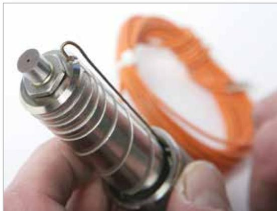
5. Accertarsi che la termocoppia sia completamente innestata nel corpo dell'ugello piegando nel contempo la termocoppia sulla flangia.
