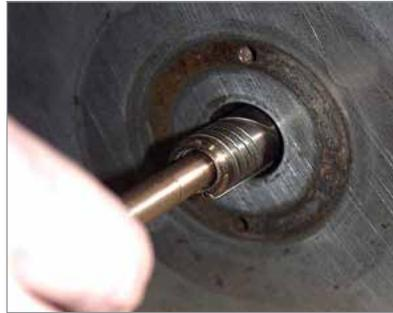
4. Una volta completata la lappatura, applicare composto blu di riscontro al rivestimento all'ugello per accertarsi del corretto accoppiamento. Se il rivestimento mostra un buon contatto, rimuovere il composto blu di riscontro da entrambe le superfici.
