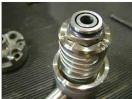
15. Collegare la boccola della valvola. Serrare conformemente alle specifiche indicate nello schema di assemblaggio generale.
