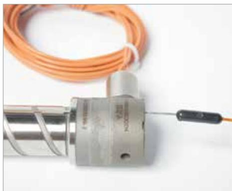
3. Posizionare completamente l'estremità dell'utensile di piegatura sopra l'estremità della termocoppia. Tenendo la termocoppia, creare un "amo da pesca" a 180° con l'utensile. Accertarsi che l'utensile di piegatura aderisca bene alla termocoppia.
