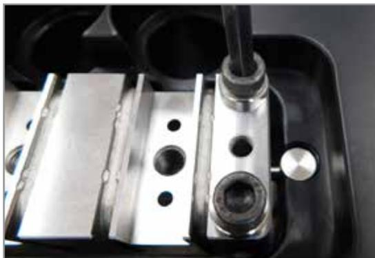
Figura 19-21 Installazione delle rondelle e dei bulloni
