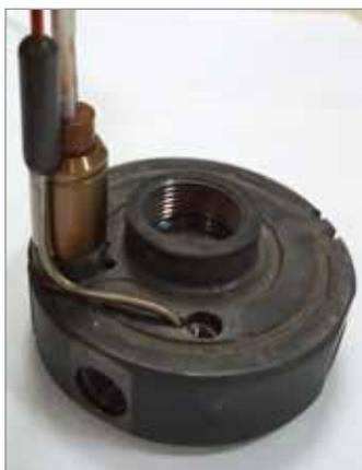
4. Collegare la termocoppia con la vite di ritegno della termocoppia.
