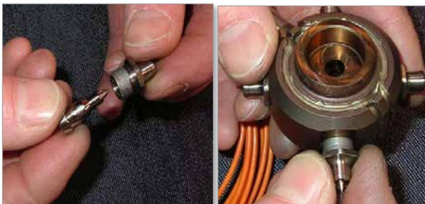
6. Avvitare il gruppo tenuta della saracinesca al Melt-Disk. Immobilizzare il Melt-Disk in una morsa morbida e serrare le tenute della saracinesca in condizioni a freddo utilizzando il valore specificato in basso o nello schema di assemblaggio generale. Non serrare eccessivamente la morsa. Accertarsi che nessuno dei componenti sia danneggiato.
