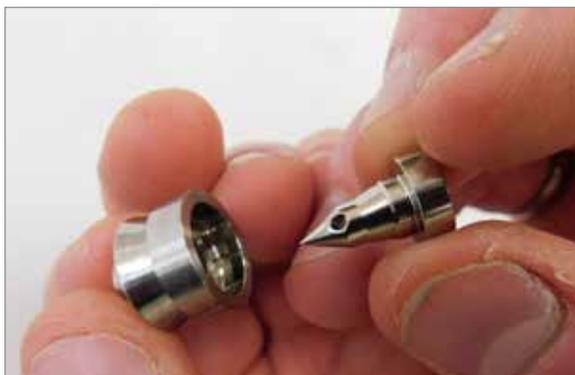
Figura 19-23 Installazione del torpedo
