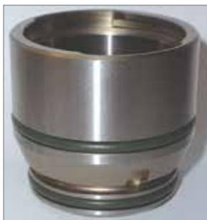
Figura 10-3 O-ring cilindro inferiore serie 6X00 e serie 7100
