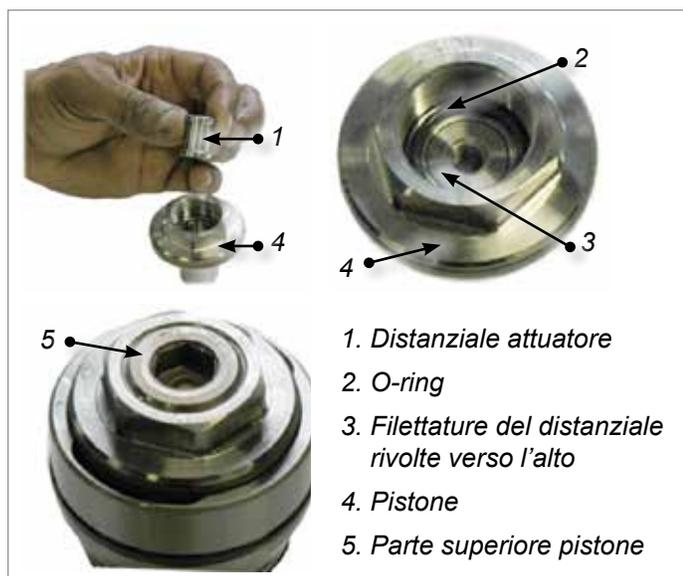
Figura 10-19 Installazione del distanziale del pistone
