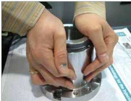
11. Inserire l'O-ring nella parte superiore del cilindro e assemblarlo al corpo del cilindro.
