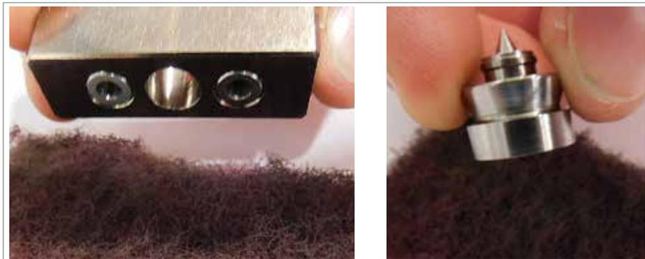
*Figura 19-31 Pulizia del blocco fusione e della tenuta della saracinesca*
