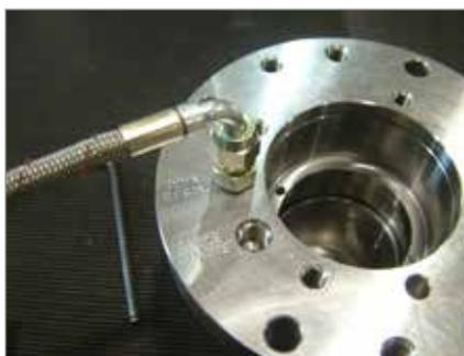
14. Fissare la tenuta della saracinesca e il rivestimento all'ugello. Serrare conformemente alle specifiche indicate negli schemi di assemblaggio generale. Collegare la termocoppia dell'ugello.
