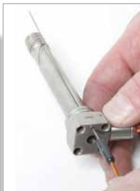
2. Piegare manualmente la punta della termocoppia contro il pollice a un angolo di circa 90°, accertandosi che sia presente una lunghezza della curva sufficiente per raggiungere il fondo del foro della termocoppia.
