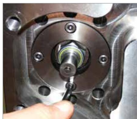
3. Assemblare il dado della vite sulla vite a ricircolo di sfere con una coppia di 43-45 Nm (da 31,7 a 33,1 lbf-ft).
