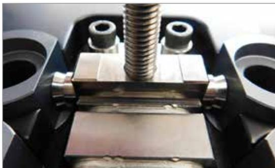
Figura 19-26 Installazione con un bullone di sollevamento M10
