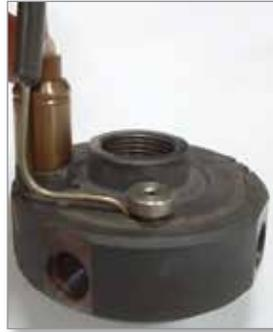
5. Utilizzare nastro resistente al calore proprio sopra la capsula dell'isolatore per fissare insieme i fili dell'ugello e quelli della termocoppia.
