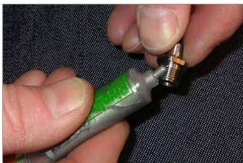
5. Inserire l'estremità appuntita delle punte (torpedo) nell'estremità filettata della tenuta della saracinesca.
