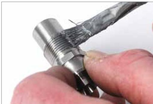
2. Avvitare Melt-Link MTL14A nell'ugello e Melt-Link MTL14B nel Melt-Disk.
