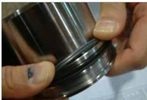
7. Applicare una piccola quantità di lubrificante a tutte le superfici esterne delle tenute prima del punto 8 per agevolare l'assemblaggio.
