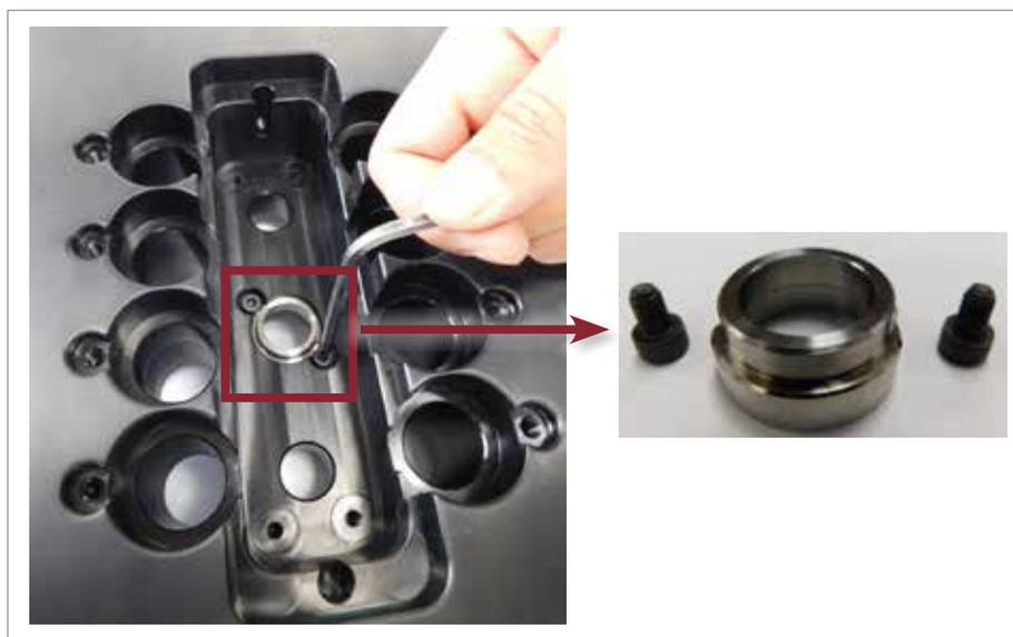
Figura 19-18 Installazione del posizionatore centrale
