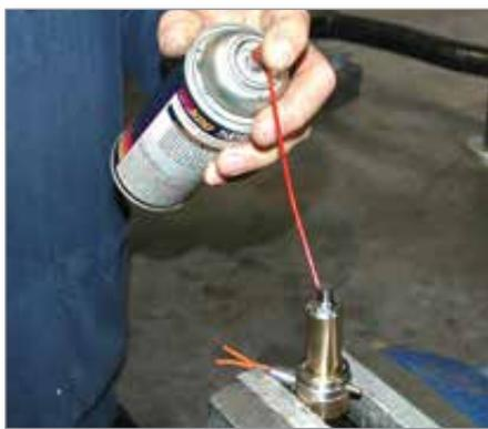
2. Lasciare l'ugello nello stampo o rimuoverlo e posizionarlo in una morsa e fissarlo con cura.
