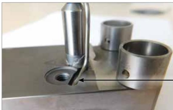
Termocoppia nel canale del collettore
