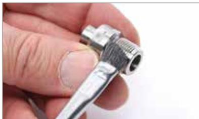
2. Avvitare la metà inferiore del collegamento di trasferimento fusione al Melt-CUBE e la metà superiore del collegamento di trasferimento fusione all'ugello.
