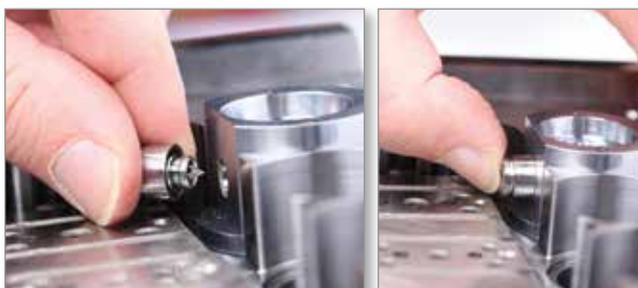
9. Installare le spine di centraggio del cuneo per il posizionamento dei cunei di fusione.
