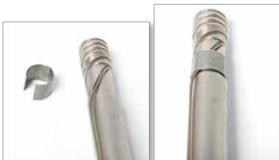
4. Installare il fermaglio di ritegno dell'estremità terminale. Verificare che la termocoppia sia contenuta nel recesso del fermaglio.
