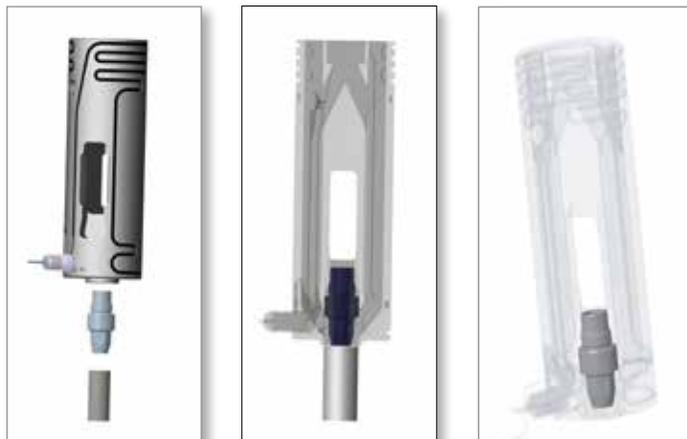
19. Installare la punta dell'ingresso nel corpo riscaldato e serrare a una coppia di 61 N·m (45 lbf-ft).
