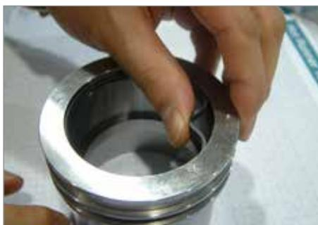
5. Utilizzare la mano e installare la rondella di supporto del pistone e l'O-ring nella scanalatura esterna designata.
