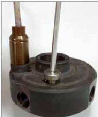
2. Inserire la punta della termocoppia nel foro della termocoppia fino a che non tocca la parte inferiore del foro.
