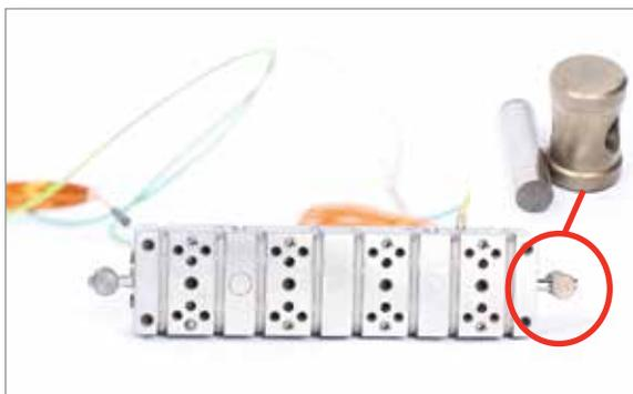
2. Installare il posizionatore del centro Melt-CUBE nella parte posteriore del blocco cavità. Installare i supporti del distanziale nella parte posteriore del Melt-CUBE.
