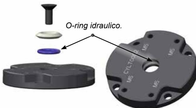
10. Installare la parte superiore del cilindro. La parte superiore del pistone spingerà dalla parte superiore del cilindro.
