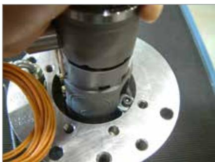
23. Fissare il supporto del perno della valvola al pistone. Serrare conformemente alle specifiche indicate nello schema di assemblaggio generale.
