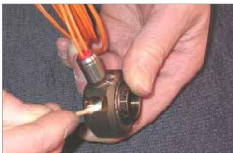
4. Applicare composto antigrippaggio alle filettature delle tenute della saracinesca, utilizzando il composto fornito da *Mold-Masters*.
