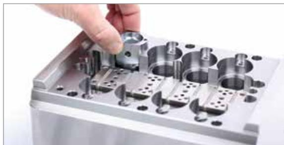
6. Qualsiasi elemento di allineamento della cavità, ad esempio spine o camme, deve essere correttamente inserito a questo punto. Nell'esempio in basso vengono installati le spine antirotazione/fermi laterali della cavità. Ripetere per tutte le cavità.
