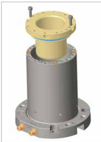
14. Posizionare la piastra isolante sul corpo del cilindro e installare i manicotti di supporto. Posizionare la piastra di copertura sulla piastra isolante. Inserire le viti a esagono incassato e serrarle a una coppia di 14 N·m (10 lbf-ft).
