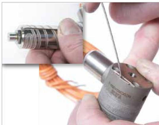
6. Premere la termocoppia verso il basso in modo che poggi contro l'estremità terminale e fissarla al fianco di quest'ultima con nastro resistente al calore in modo da accertarsi che non resti schiacciata tra l'ugello e il collettore.
