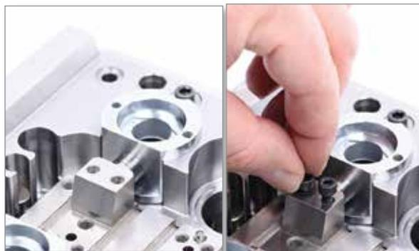
12. Installare il cuneo di carico tra cunei di fusione. Accertarsi che le viti di fermo M4 (SSETSM4X10DM) siano ritratte e non a contatto con il Melt-CUBE in questa fase. Applicare composto antigrippaggio a SHCSM6X25 e serrare a mano con una coppia di circa 0,79 Nm (7 in-lb) in modo da accertarsi che tutti i componenti siano in condizioni di contatto adeguate.
