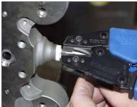
7. Fare scorrere l'isolante in ceramica e la tenuta in silicone in posizione.
