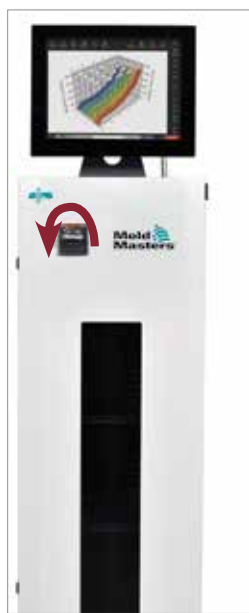
Figura 6-2 Spegnere l'interruttore di alimentazione principale
