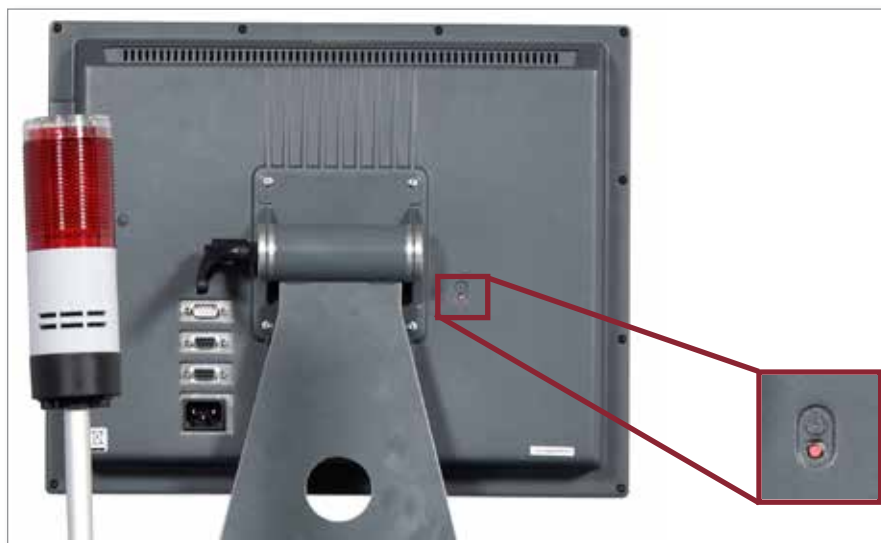
Figura 6-1 Posizione dell'interruttore di accensione/spegnimento della console
