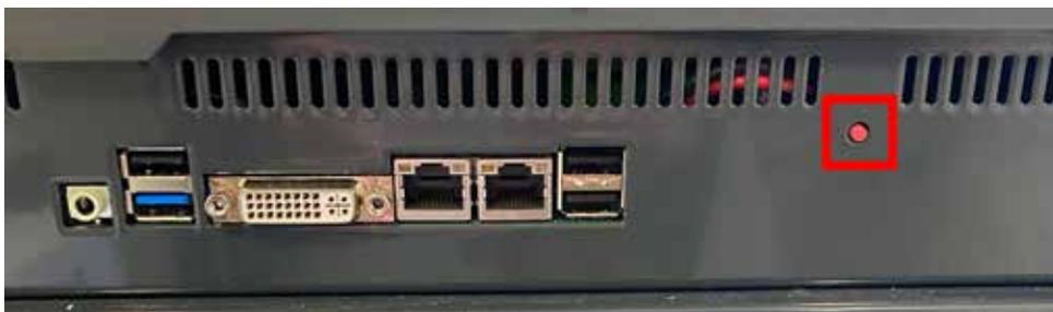
Figura 6-2 Posizione dell'interruttore di accensione/spegnimento della console
