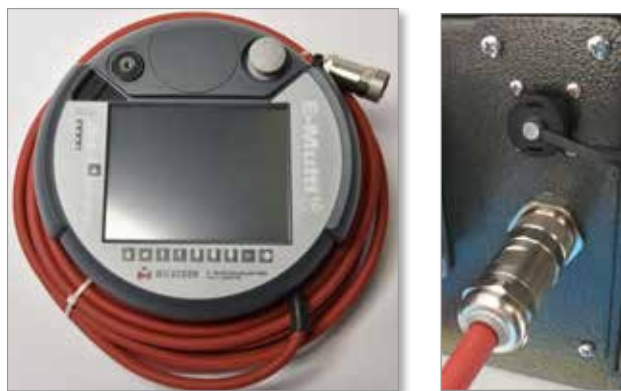
Rysunek 5-4 Ręczny interfejs HMI i połączenie
