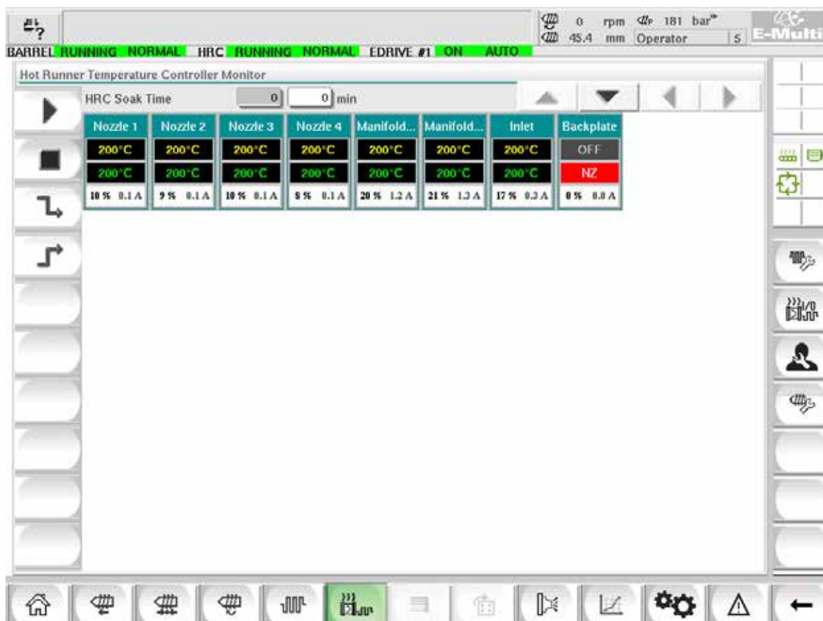
Rysunek 7-10 Ekran monitorowania sterownika gorących kanałów
