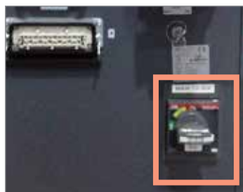
Rysunek 6-1 Główny wyłącznik zasilania E-Multi
