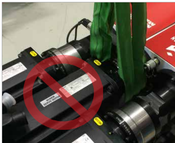
Rysunek 3-5 Nie używać silnika jako punktu podnoszenia
