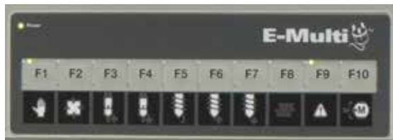
Rysunek 6-2 Pasek przycisków pod wyświetlaczem sterownika (HMI)
