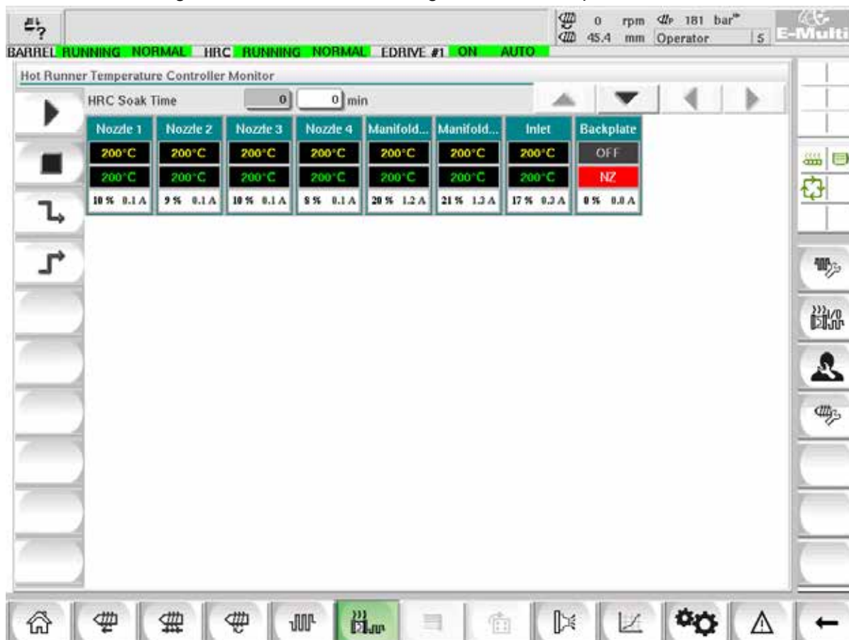
Figure 7-10 Ecrã de monitorização do controlador do canal quente
