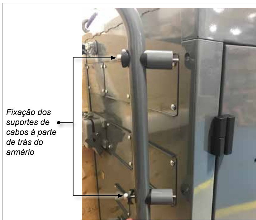
Figure 4-5 Fixar suportes de cabos
