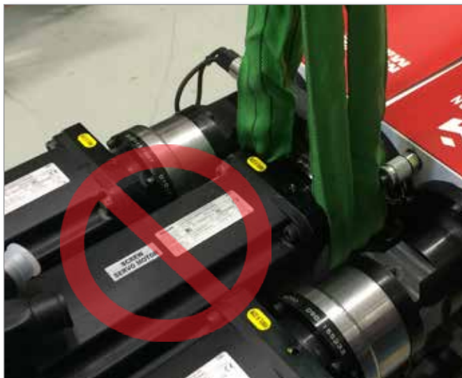
Figure 3-12 Não utilize o motor como ponto de elevação
