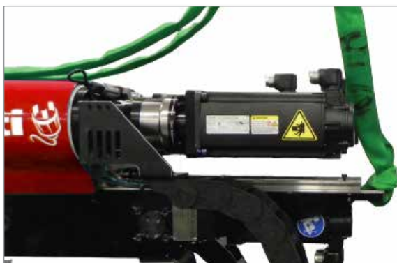
Hình 11-4 Gắn dây nâng phía sau
