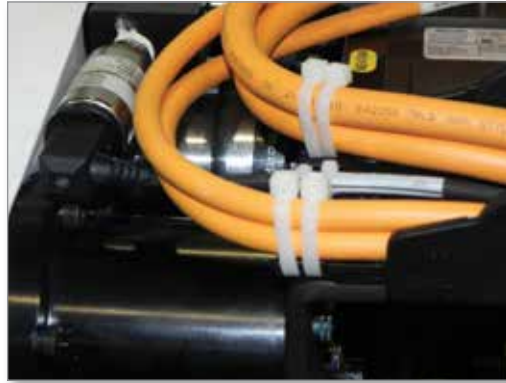
Hình 7-2 Cáp được giữ bằng dây buộc
