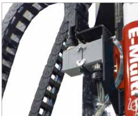
Hình 11-7 Lắp đầu nối bộ gia nhiệt của khoang chứa
