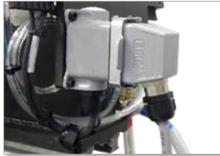
Hình 11-9 Lắp đầu nối I/O
