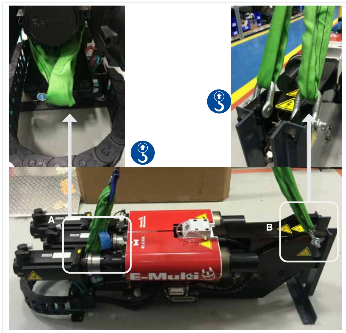
Hình 3-7 Các khớp nối nâng ngang của EM3. Tương tự như EM1/EM2
