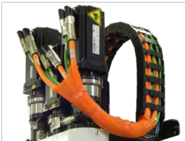
Hình 7-1 Định tuyến cáp servo của EM3
