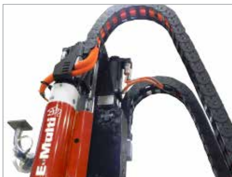
Hình 11-8 Lắp cáp của động cơ servo
