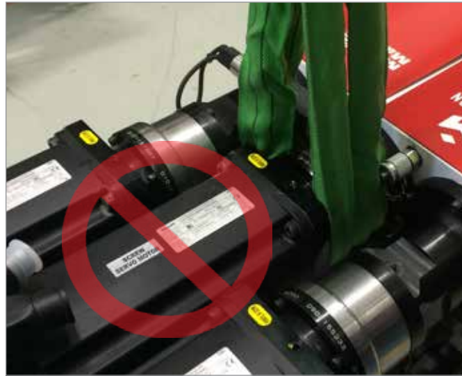
Hình 3-5 Không dùng động cơ làm điểm nâng
