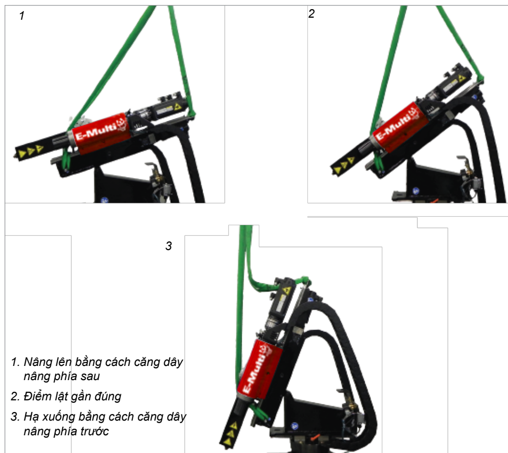
Hình 11-6 Nghiêng Thiết bị hướng tâm E-Multi từ vị trí ngang sang vị trí dọc
