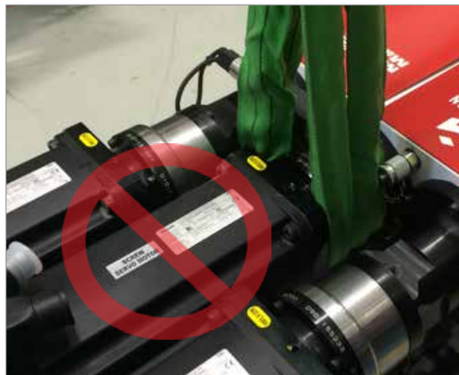
Hình 3-12 Không dùng động cơ làm điểm nâng
