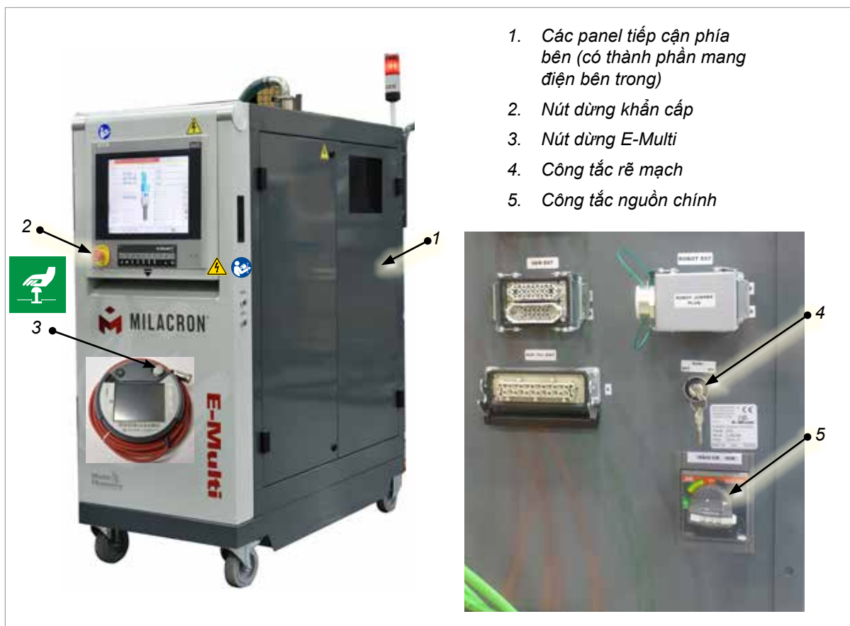
Hình 3-2 Nguy cơ an toàn của thiết bị điều khiển E-Multi
