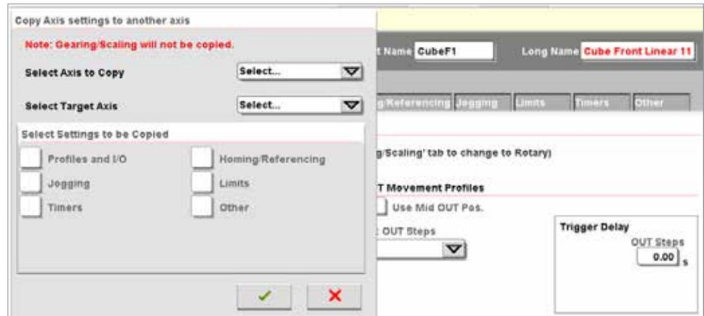
2. Seleccione el eje para copiar de la lista desplegable para Select Axis to Copy (Seleccionar eje a copiar).
