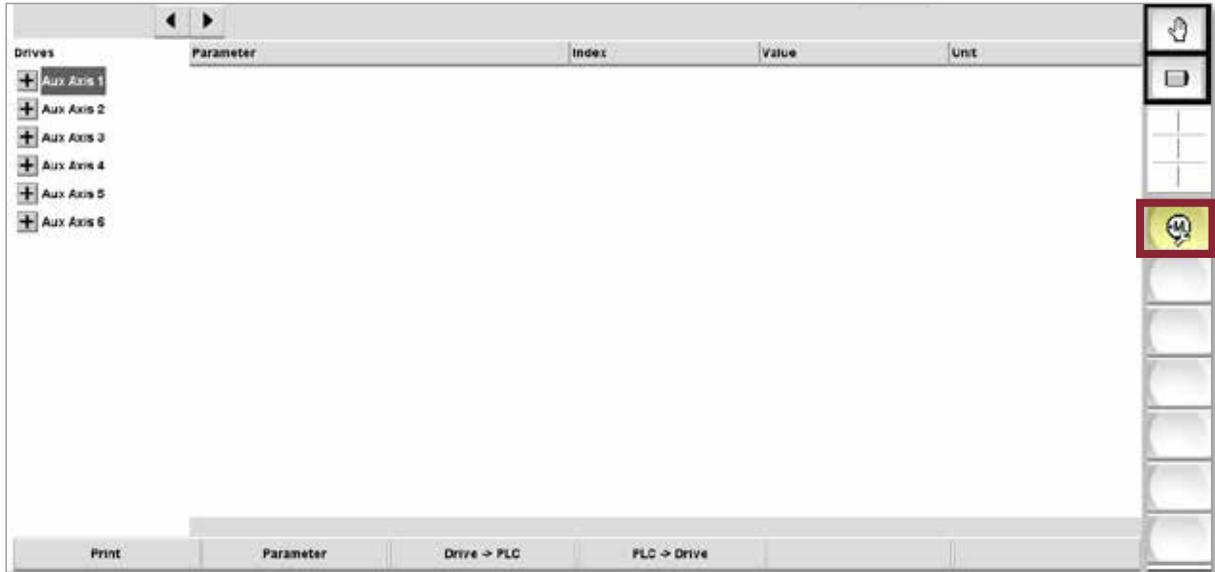
11. Cuando esté en la pestaña Gearing/Scaling (Engranaje/Escala) aparecerá un mensaje que le indicará que debe encender y apagar el equipo. Antes de hacerlo, asegúrese de tener la configuración correcta para la relación de engranajes, el recorrido del tornillo y el torque máximo.
