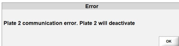
Si la placa 2 utiliza una versión de software diferente, se muestra el siguiente mensaje.
