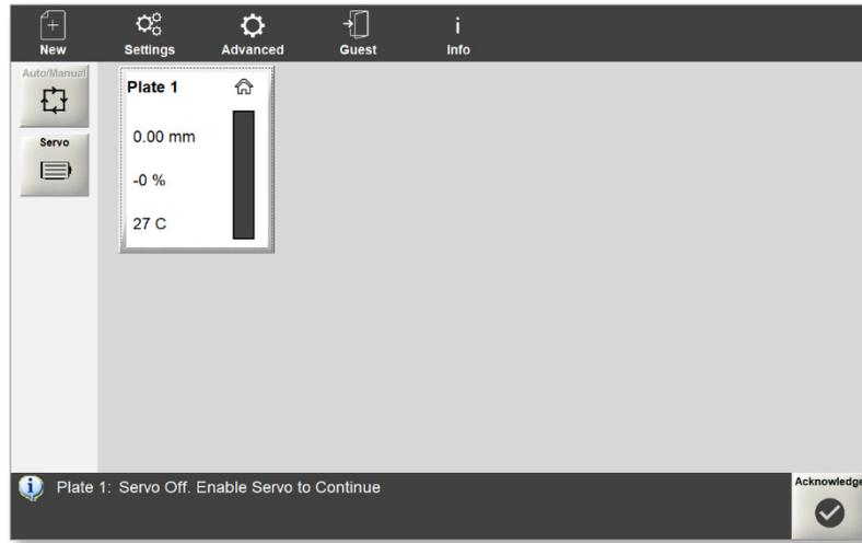
Figura 4-2 Pantalla principal del controlador E-Drive
