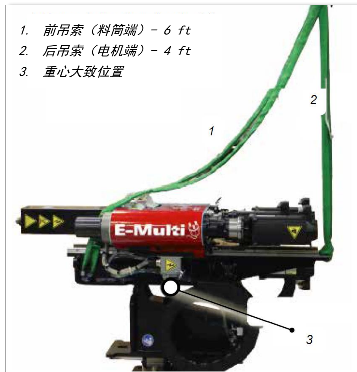
图 11-2 E-Multi Radial 垂直梁的吊索位置（水平方向）和重心的大致位置
