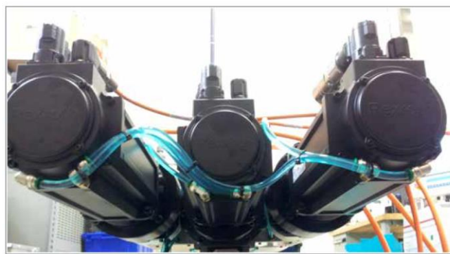
图像 7-8 EM3/EM4 伺服电机冷却连接
