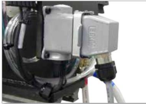
图 11-9 安装 I/O 连接器
