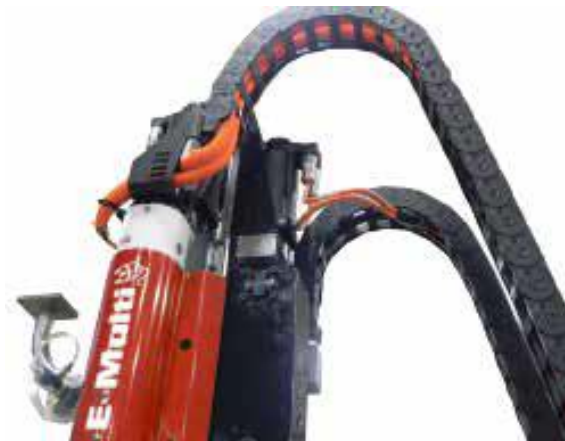
图 11-8 连接伺服电机电缆
