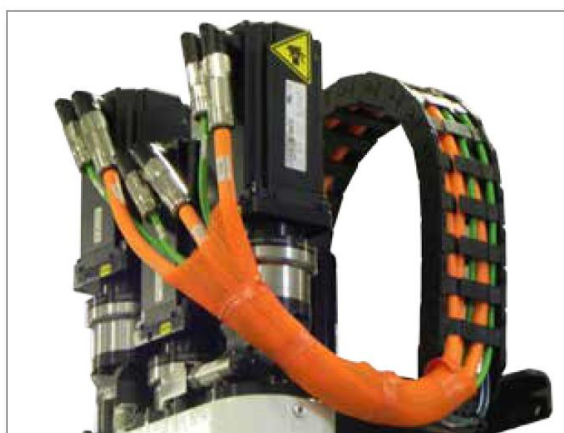
图像 7-1 EM3 伺服电缆布线
