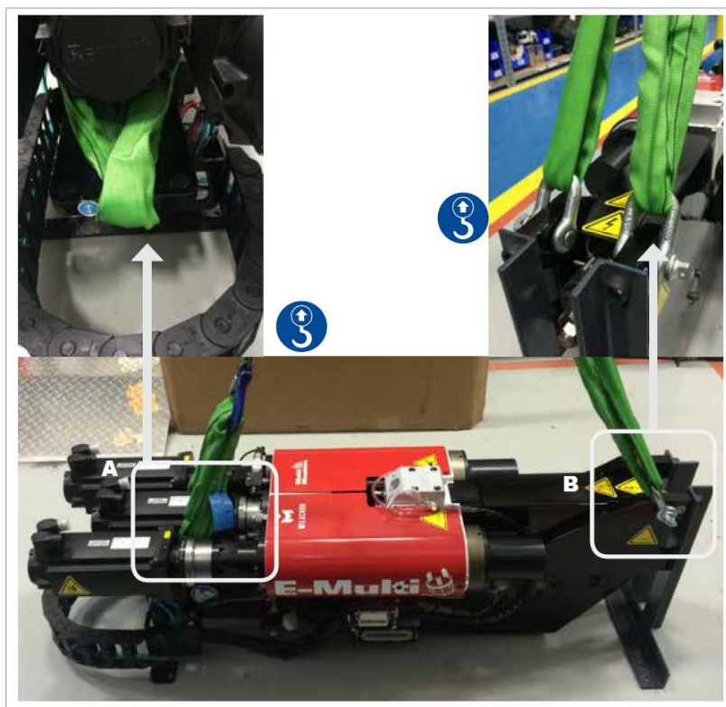
Figure 3-7 EM3 水平吊装连接. EM1 / EM2 类似
