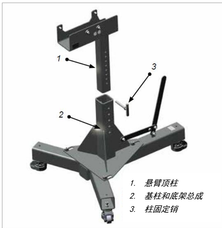
图 14-5 紧凑型支架组装
