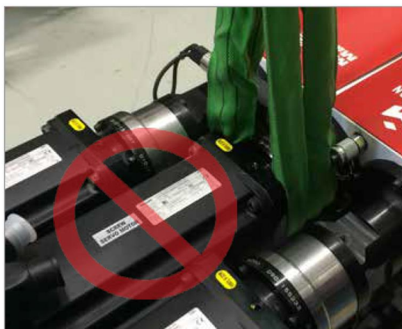
图像 3-5 请勿使用电机作为吊装点
