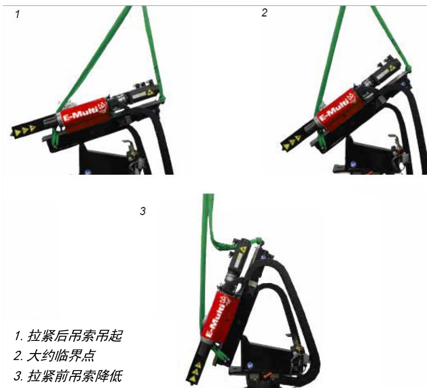
图 11-6 将 E-Multi Radial 从水平位置倾斜到垂直位置
