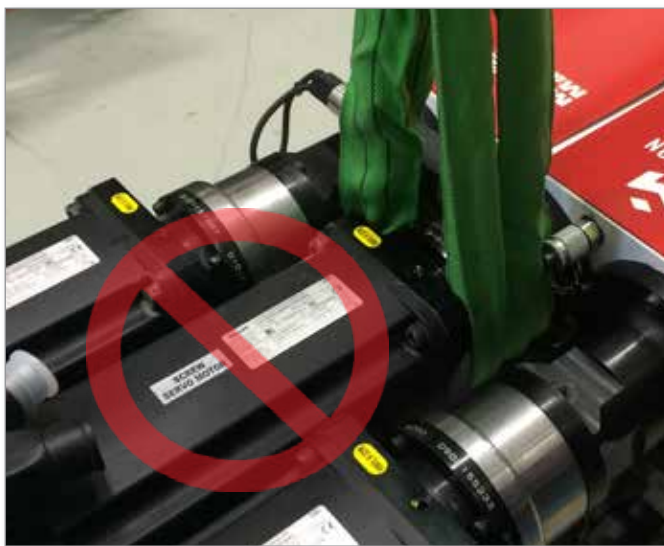
Figure 3-5 Nepoužívejte motor jako zdvihací bod.
