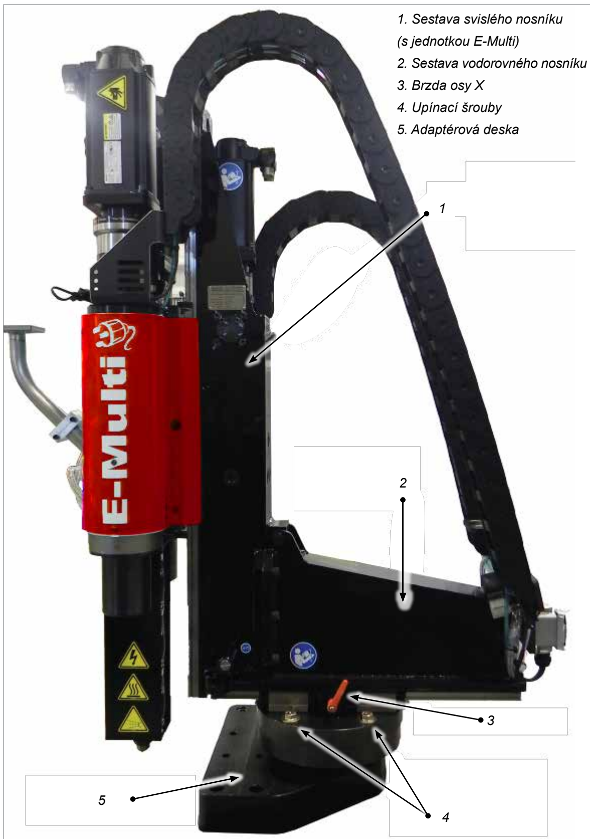
Obrázek 11-1 Hlavní součásti jednotky E-Multi Radial
