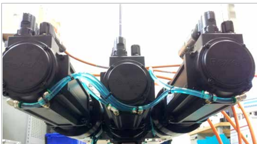
Obrázek 7-7 Přípojky chlazení servomotoru jednotky EM3/EM4
