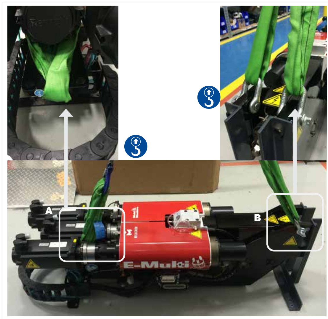
Obrázek 3-7 Horizontální připojovací body pro zvedání jednotky EM3 (podobné jednotce EM1/EM2)
