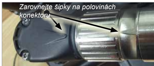
Obrázek 7-3 Správné zarovnání konektorů
