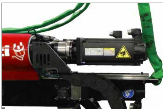
Abbildung 11-4 Anbringen des hinteren Seils
