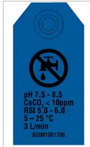
Abbildung 7-9 Kennzeichnung mit Angaben zur Wasserqualität an der E-Multi-Einheit
