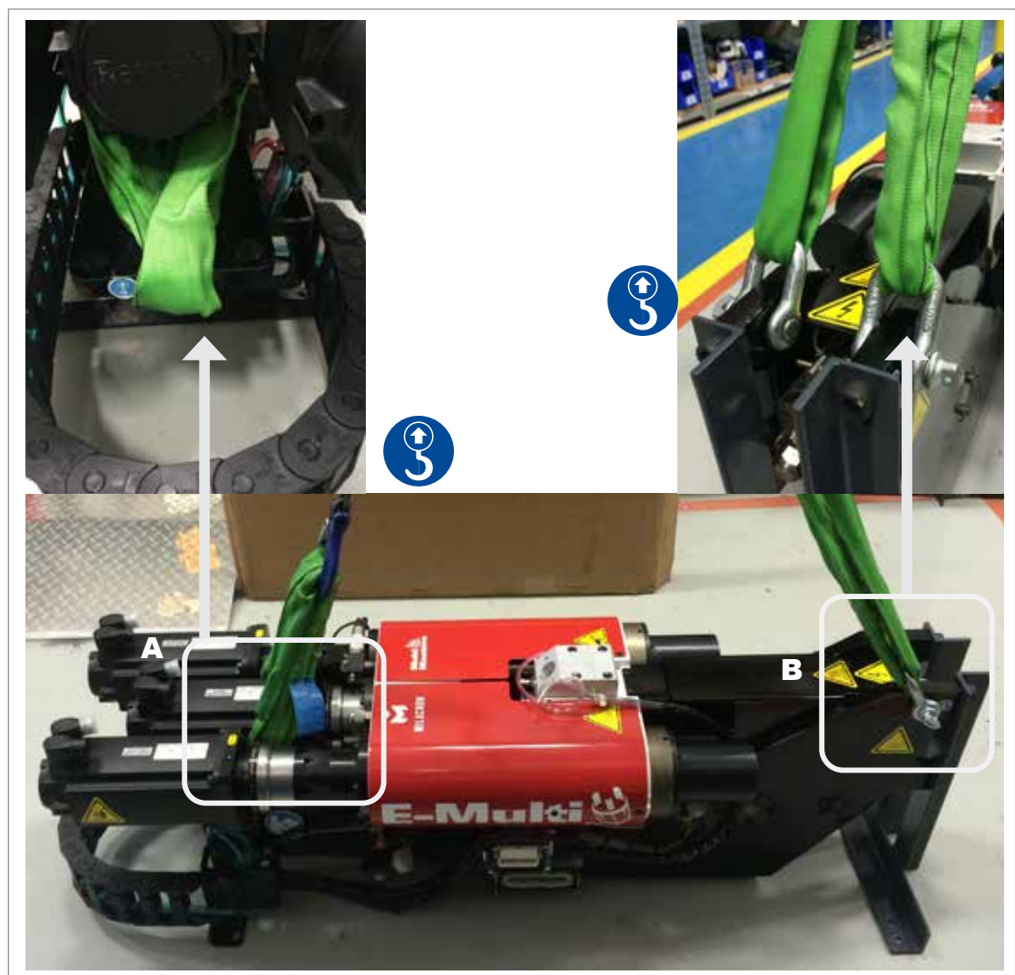
Abbildung 3-7 Horizontale Hubvorrichtungen EM3. EM1/EM2 ähnlich
