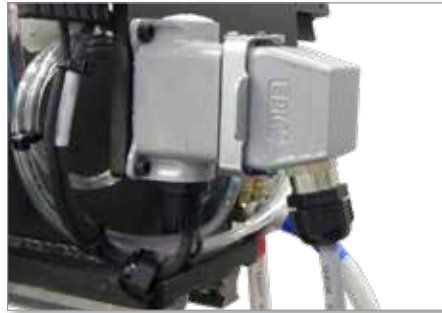
Figura 11-9 Instale el conector de E/S
