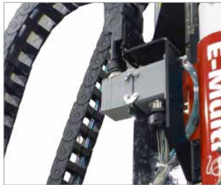
Figura 11-7 Instale el conector del calentador del cañón
