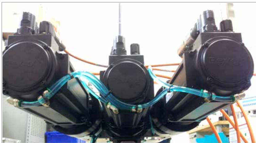
Figura 7-8 Conexiones de enfriamiento del servomotor EM3 / EM4
