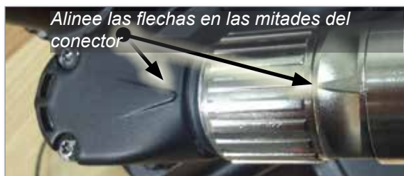
Figura 7-3 Corrija la alineación del conector
