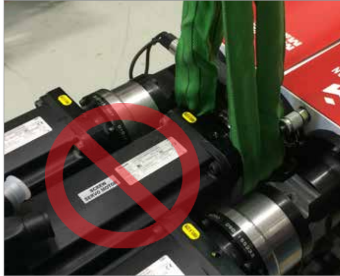
Figura 3-5 No utilice el motor como punto de elevación.
