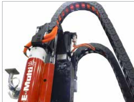
Figura 11-8 Conecte los cables del servomotor
