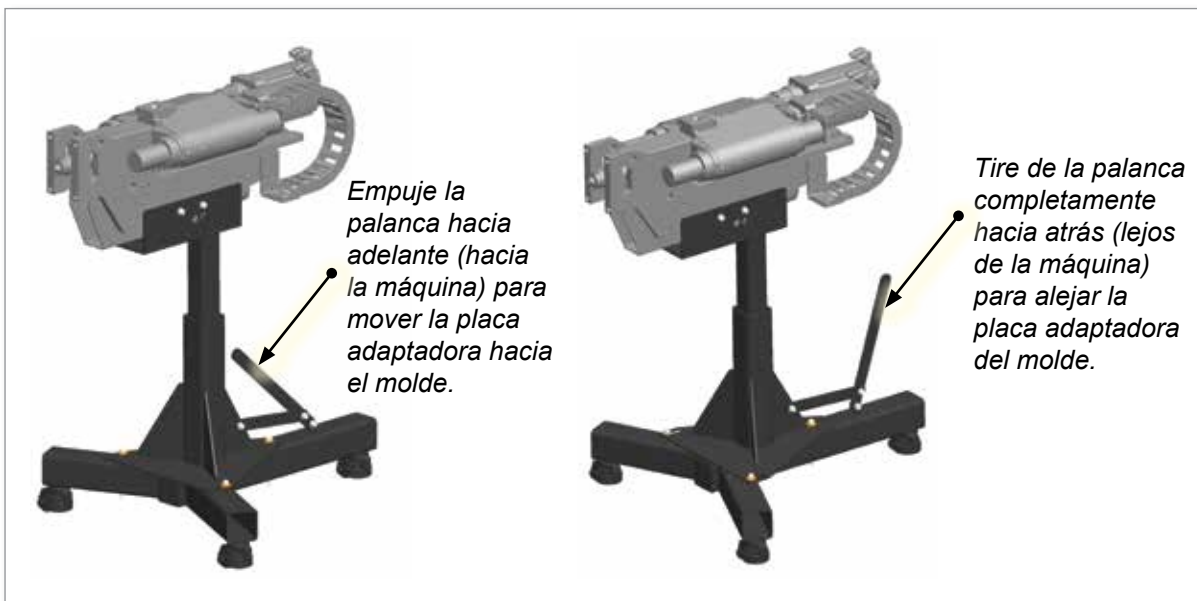
Figura 14-4 Ajuste de la posición horizontal del soporte compacto
