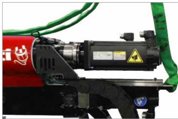
Figura 11-4 Sujeción de la eslinga trasera
