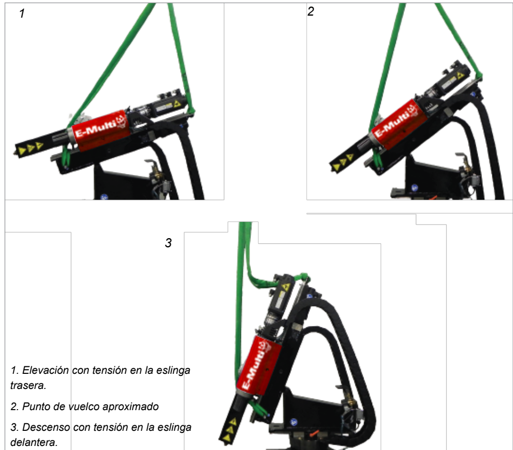
Figura 11-6 Inclínación del E-Multi Radial de la posición horizontal a la vertical
