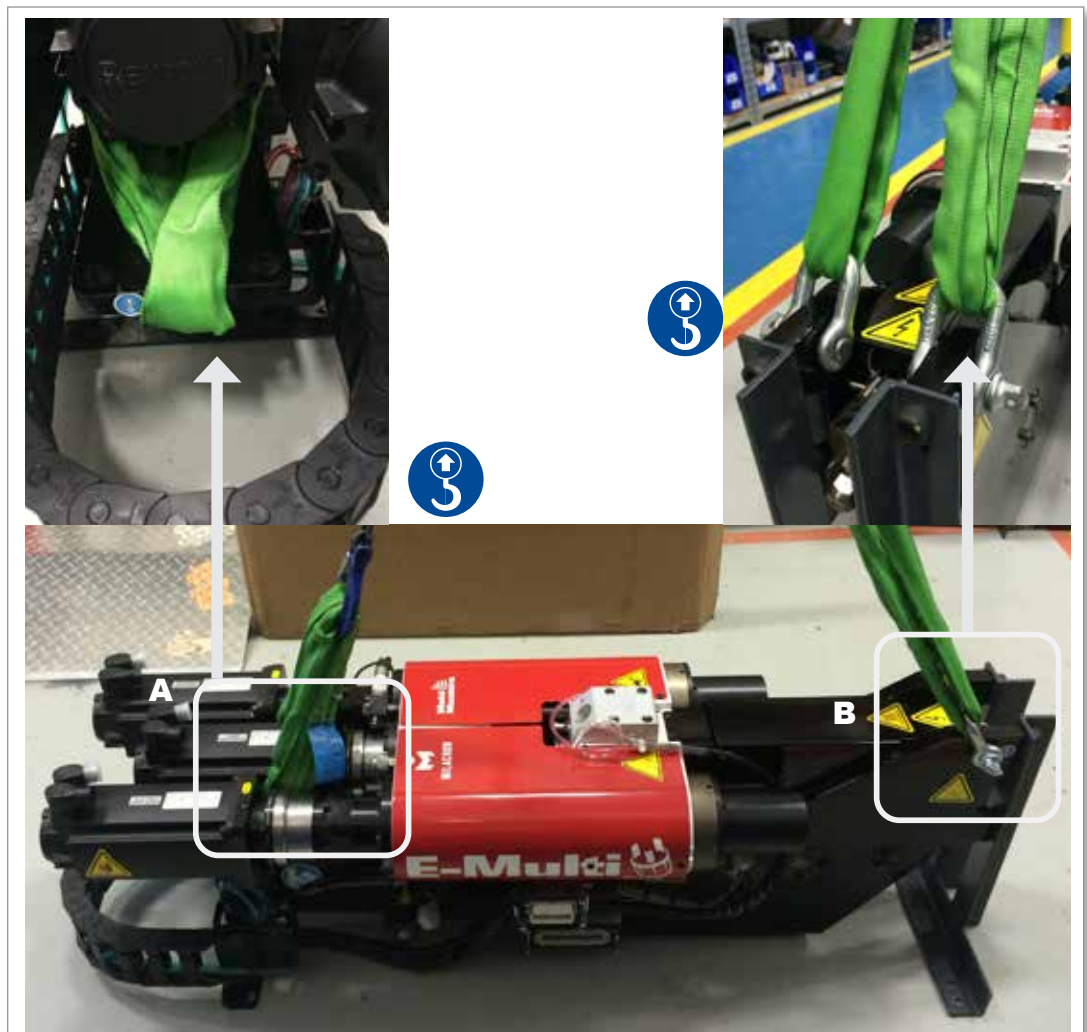
Figura 3-7 Conexiones de elevación horizontal EM3. Similares a EM1/EM2
