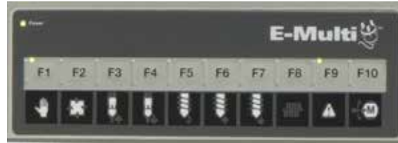
Figura 8-2 Tira de botones debajo de la pantalla del controlador (IHM)
