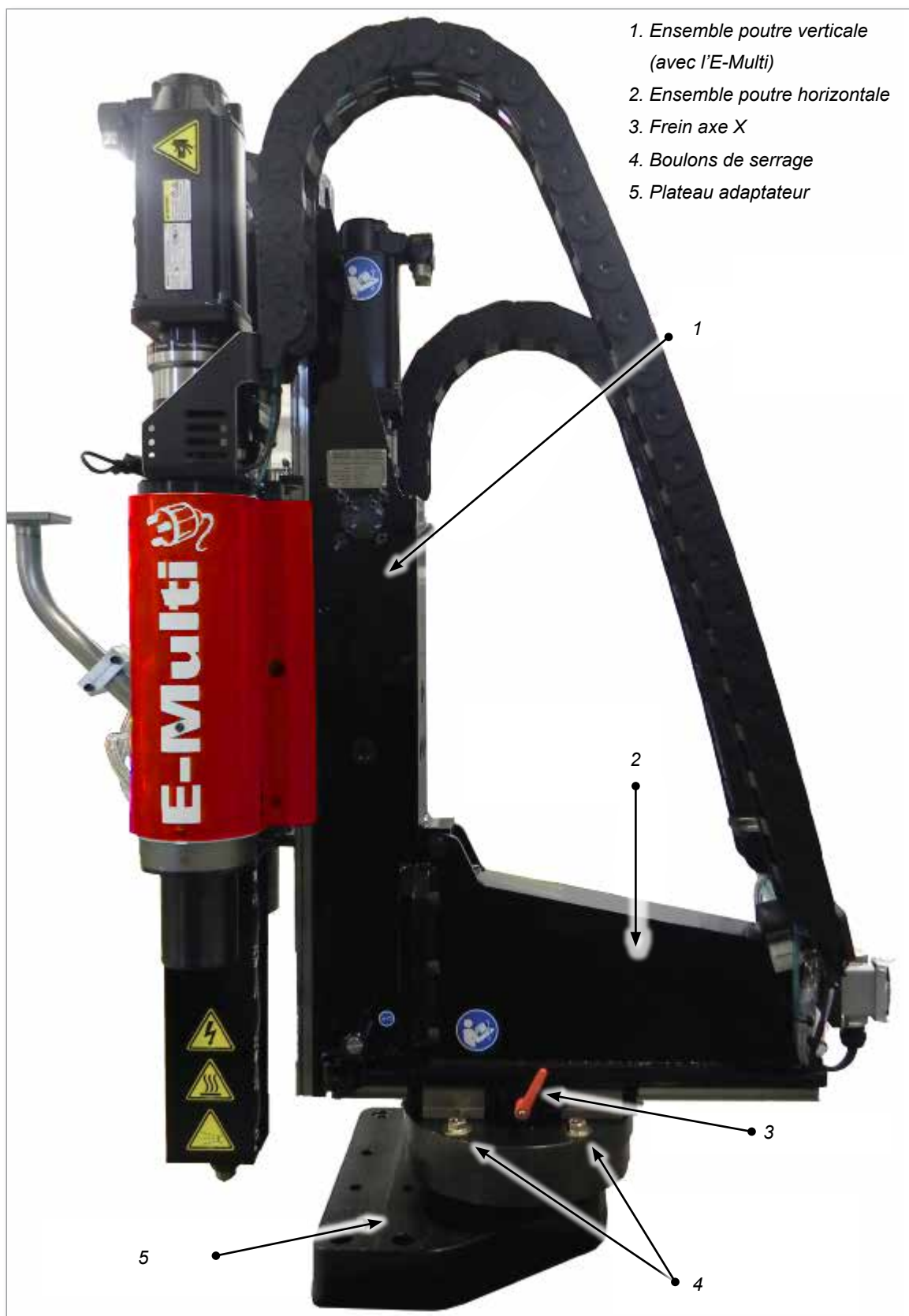
Illustration 11-1 Composants principaux du Radial de l'E-Multi
