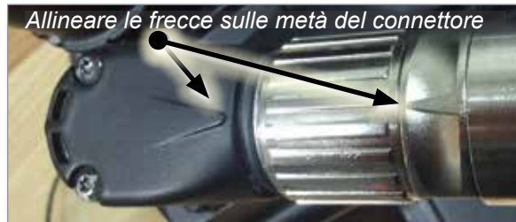
Figura 7-3 Allineamento corretto del connettore
