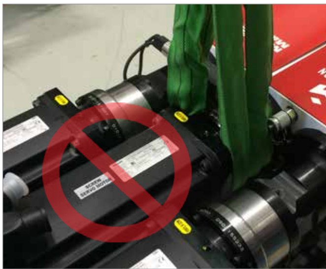
Figura 3-5 Non utilizzare il motore come punto di sollevamento
