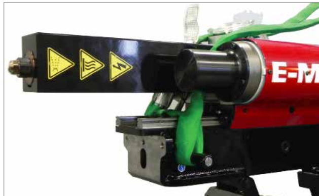
Figura 11-3 Attacco dell'imbracatura anteriore
