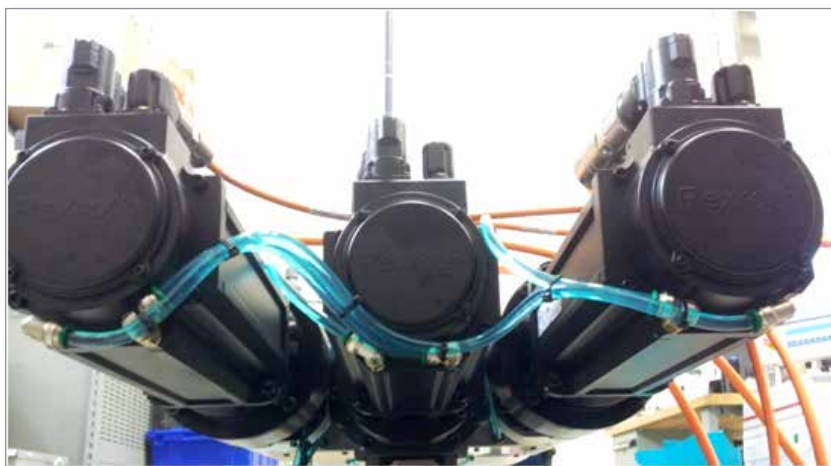
Figura 7-8 Collegamenti di raffreddamento del servomotore EM3 / EM4
