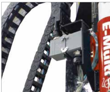
Figura 11-7 Installare il connettore dei riscaldatori a cilindro
