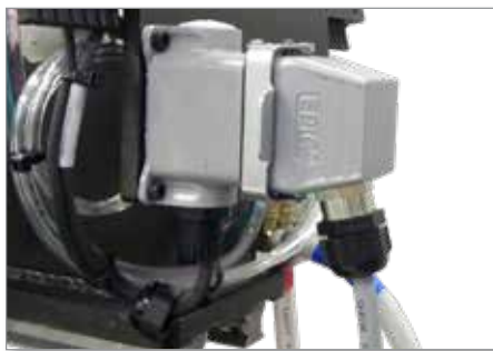
Figura 11-9 Installazione del connettore I/O
