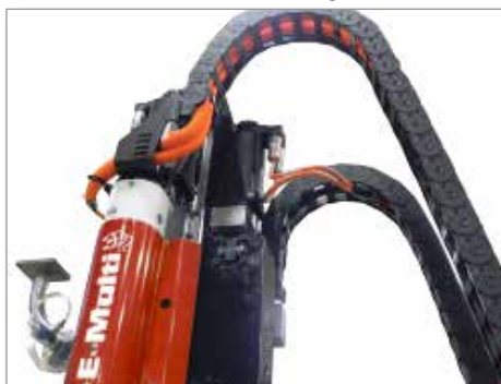
Figura 11-8 Collegare i cavi del servomotore
