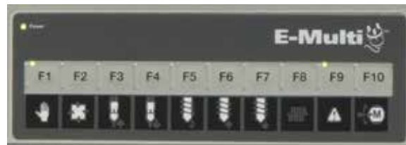
Figura 8-2 Striscia di pulsanti sotto il display del controller (HMI)
