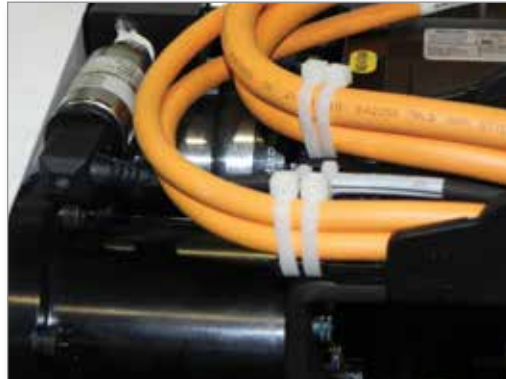
Figura 7-2 Cavi fissati con fascette fermacavi
