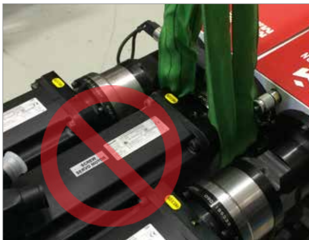
Rysunek 3-5 Nie używać silnika jako punktu podnoszenia
