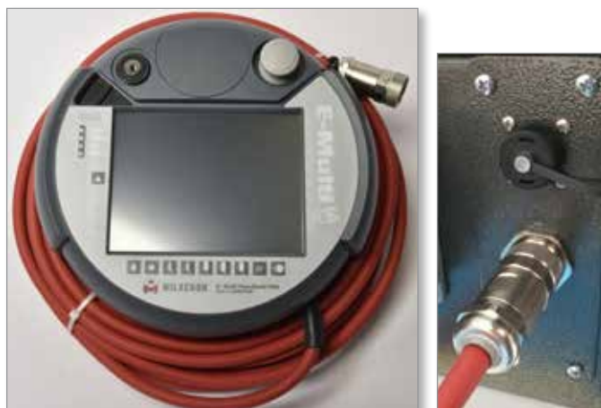
Rysunek 7-5 Ręczny interfejs HMI i połączenie
