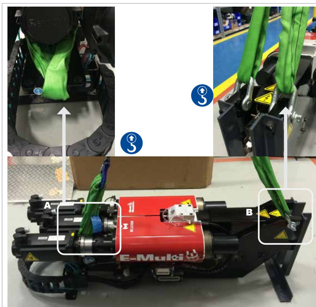
Rysunek 3-7 Połączenia do podnoszenia poziomego EM3. W przypadku EM1 / EM2 podobne
