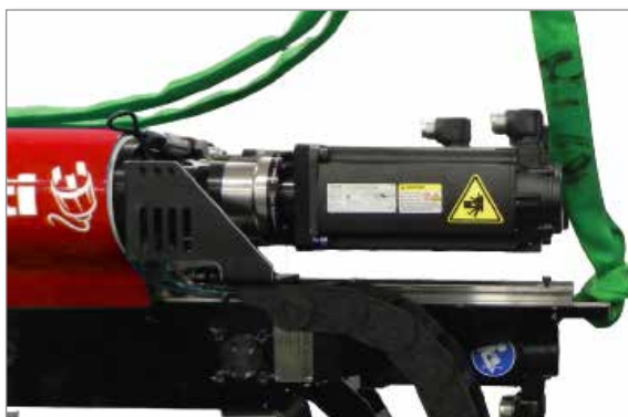
Rysunek 11-4 Mocowanie tylnego zawiesia
