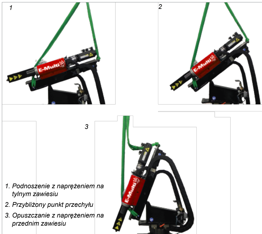
Rysunek 11-6 Przechylenie jednostki E-Multi Radial z pozycji poziomej do pionowej
