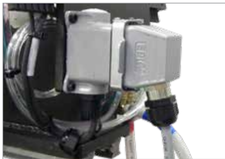
Rysunek 11-9 Mocowanie złącza WE/WY
