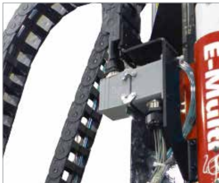
Rysunek 11-7 Instalacja złącza elementów grzejnych cylindra
