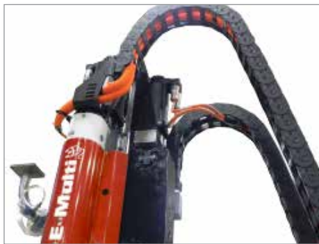
Rysunek 11-8 Mocowanie przewodów serwomotorów
