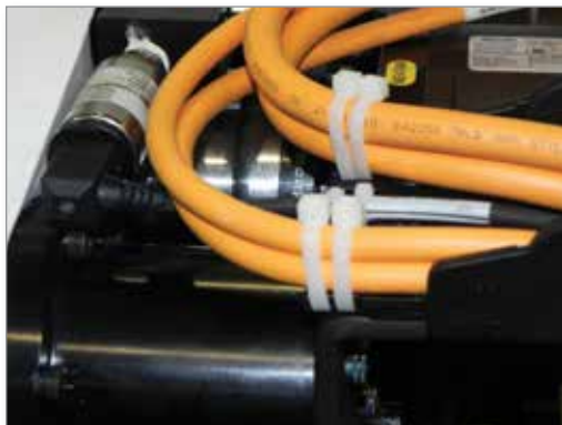
Rysunek 7-2 Przewody zamocowane za pomocą opasek zaciskowych
