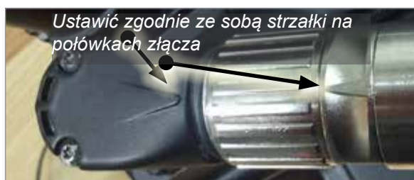
Rysunek 7-3 Prawidłowe ustawienie złącza
