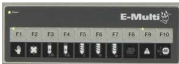
Rysunek 8-2 Pasek przycisków pod wyświetlaczem sterownika (HMI)
