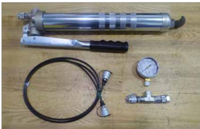
Rysunek 5-1 Zestaw do napełniania olejem (opcja)
