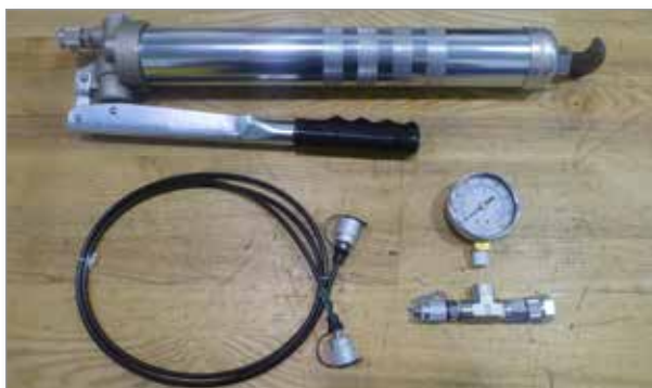
Rysunek 11-5 Zestaw do napełniania olejem (opcja)
