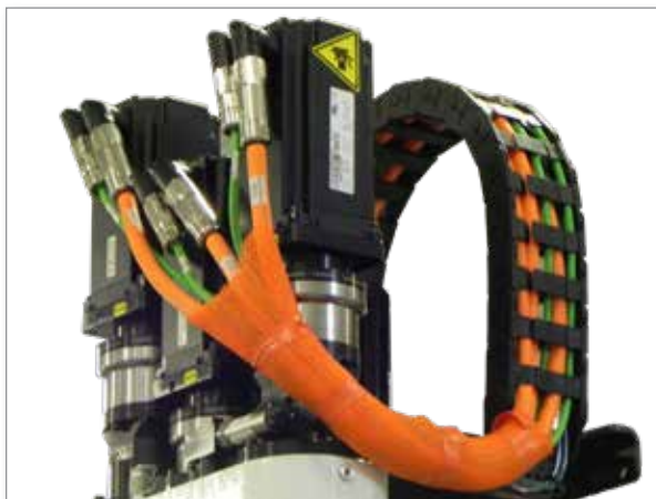
Rysunek 7-1 Prowadzenie przewodów serwo EM3
