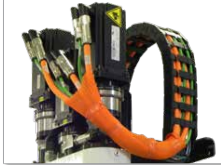
Hình 5-1 Định tuyến cáp servo của EM3
