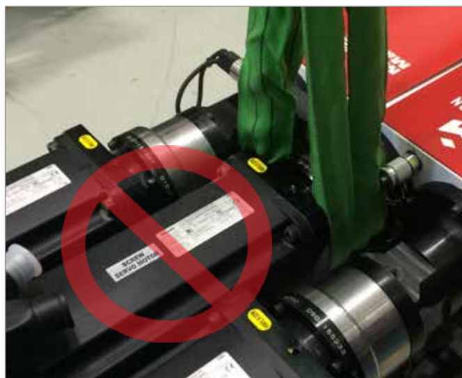
Hình 3-12 Không dùng động cơ làm điểm nâng
