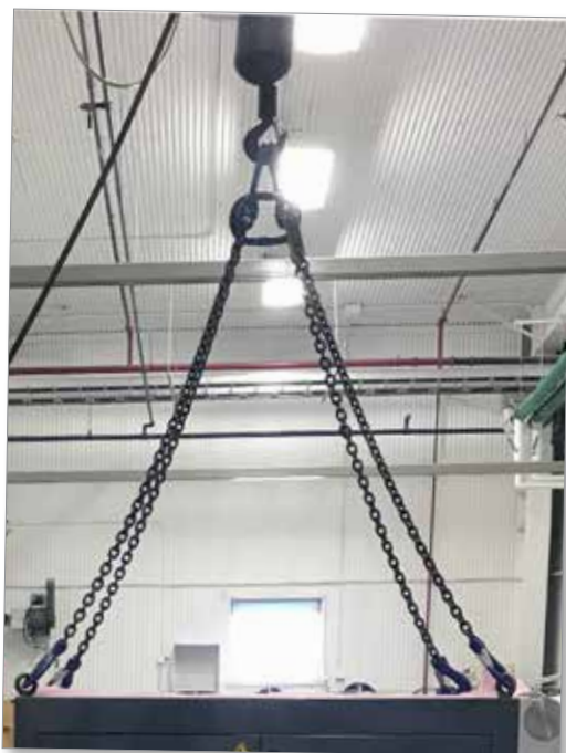
Hình 3-11 Gắn dây nâng vào cả 4 bu-lông vòng
