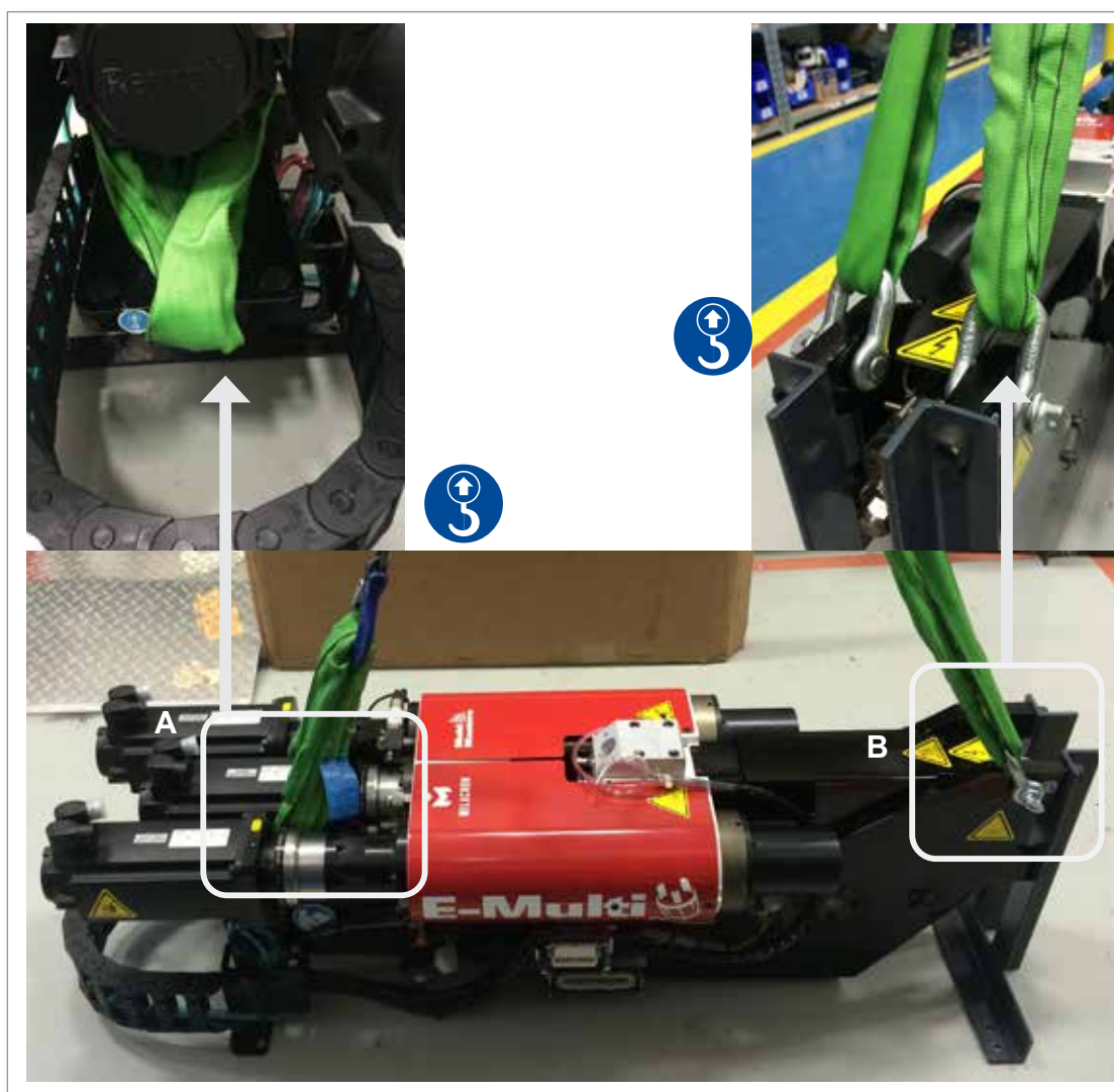
Hình 3-7 Các khớp nối nâng ngang của EM3. Tương tự như EM1/EM2
