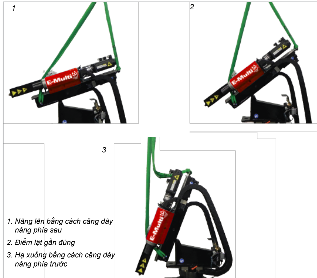
Hình 11-6 Nghiêng Thiết bị hướng tâm E-Multi từ vị trí ngang sang vị trí dọc
