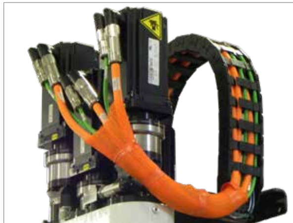
Hình 7-1 Định tuyến cáp servo của EM3
