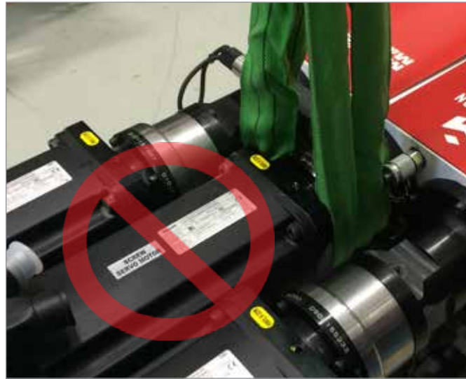
Hình 3-5 Không dùng động cơ làm điểm nâng
