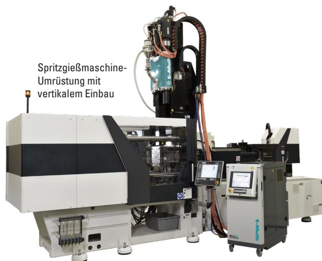
Spritzgießmaschine-Umrüstung mit vertikalem Einbau
