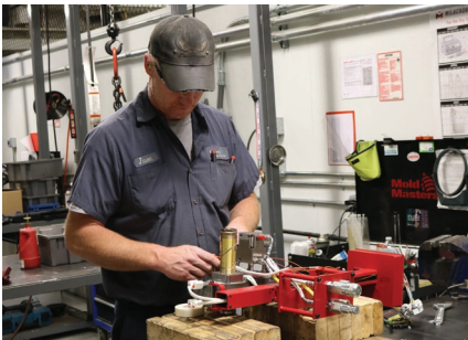
Reinigung der Wasserkanäle, Beseitigung von Mineralablagerungen.
