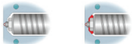
Keine Leckage, normale durchschnittliche Leistung Leckage beginnt, Leistungsaufnahme steigt an, da Wärmeenergie über die wassergekühlte Kavitätensplatte verloren geht.
