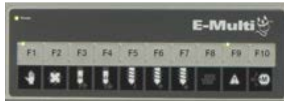
Figur 8-2 Knapstrimmel under styreenhedens skærm (HMI)
