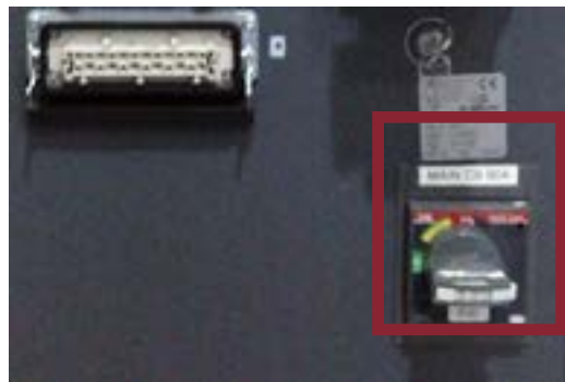
Figur 8-1 Hovedafbryder på E-Multi
