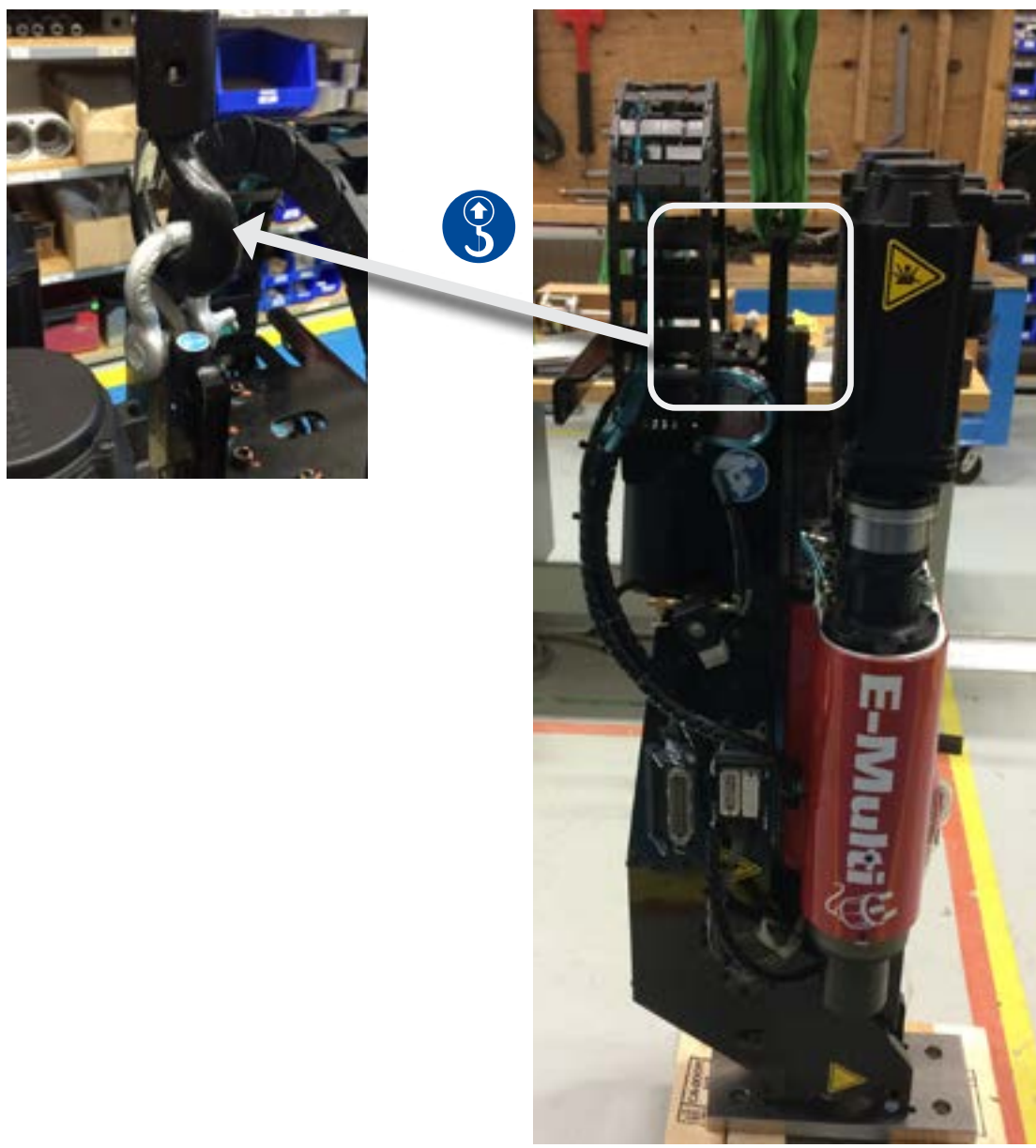
Figur 3-6 Lodrette løftetilslutninger på EM1/EM2 (lignende på EM3)
