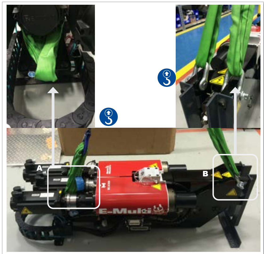
Figur 3-7 Vandrette løftetilslutninger på EM3. EM1/EM2 er lignende
