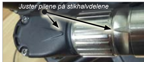
Figur 7-3 Korrekt justering af stik
