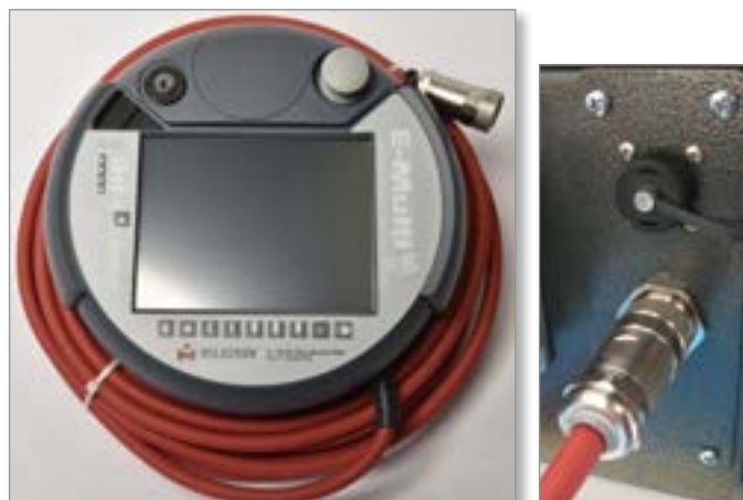
Figur 7-5 Håndholdt HMI og tilslutning
