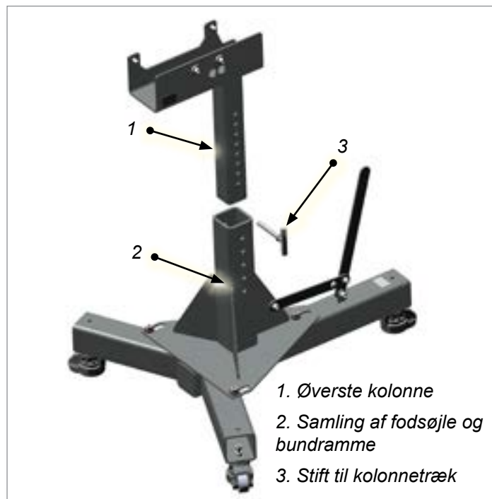
Figur 14-5 Samling af kompakt stativ
