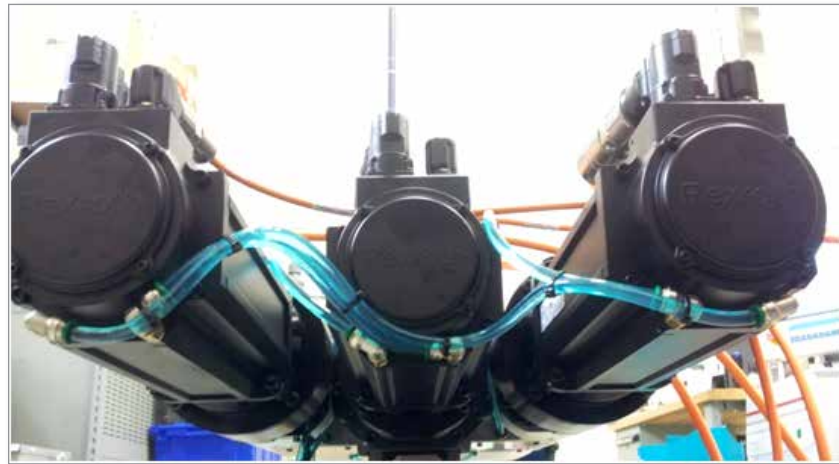
Afbeelding 7-8 Koelaansluitingen van de servomotor van de EM3 / EM4
