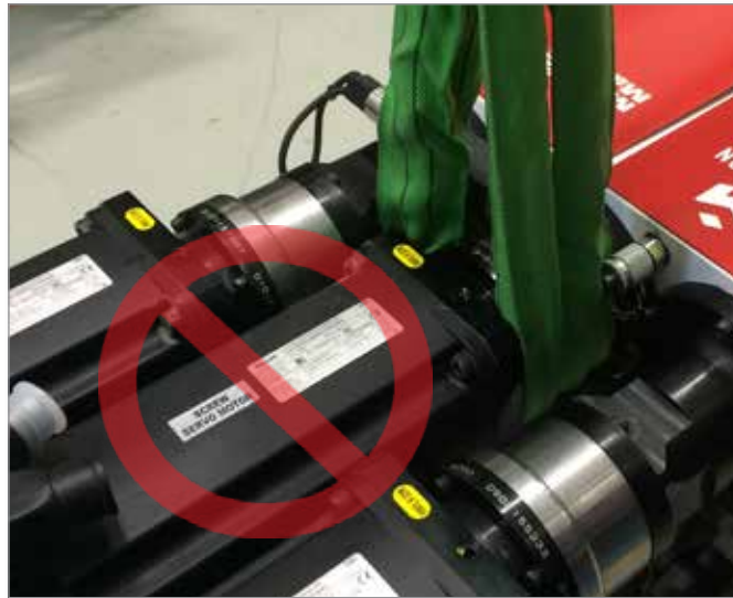
Afbeelding 3-5 Gebruik de motor niet als hefpunt
