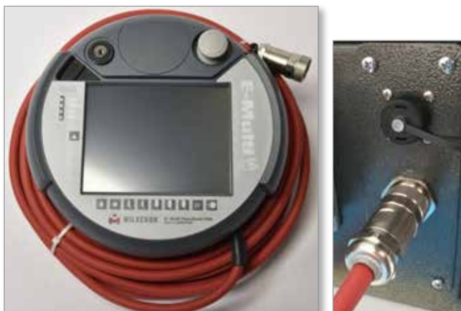
Afbeelding 7-5 Draagbare HMI en aansluiting
