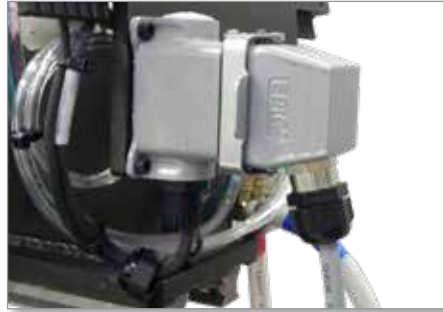
Afbeelding 11-9 Installeer de I/O-connector
