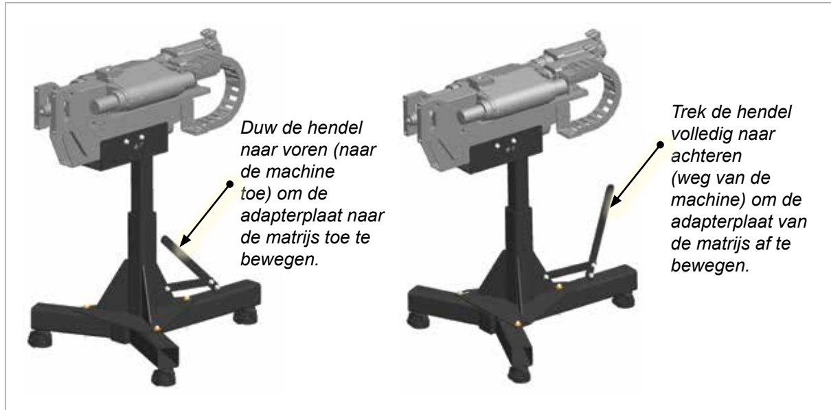
Afbeelding 14-4 Horizontale afstelling van de positie van de compacte standaard
