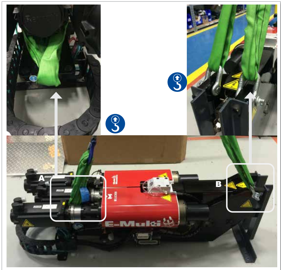
Afbeelding 3-7 Verbindingen voor horizontaal optillen van de EM3. EM1 / EM2 soortgelijk
