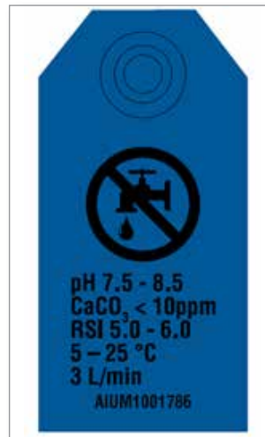
Afbeelding 7-10 Label met specificaties van de waterkwaliteit op de E-Multi
