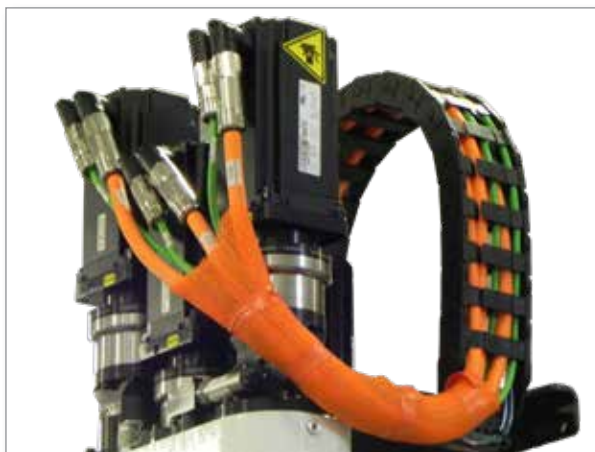
Afbeelding 7-1 Geleiding van de servokabels van de EM3
