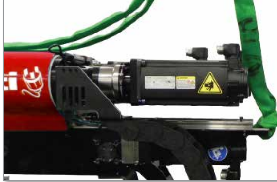
Afbeelding 11-4 Bevestiging van de achterste strop
