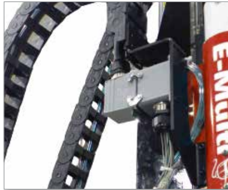
Afbeelding 11-7 Installeer de connector van de cilinderverwarming
