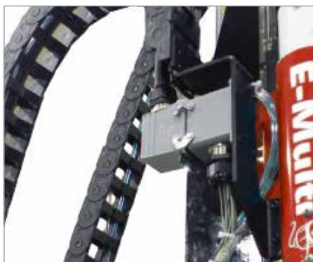
Figur 11-7 Installera husets värmeanslutning
