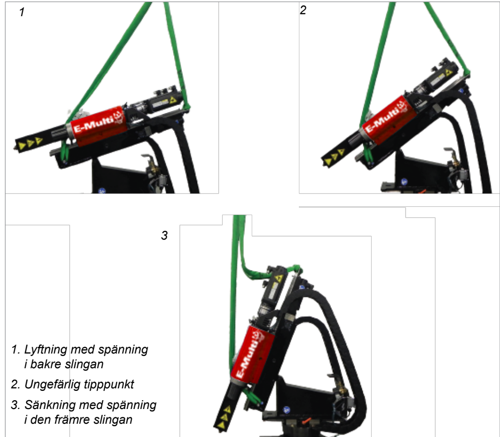
Figur 11-6 Luta E-Multi Radial från horisontellt till vertikalt läge
