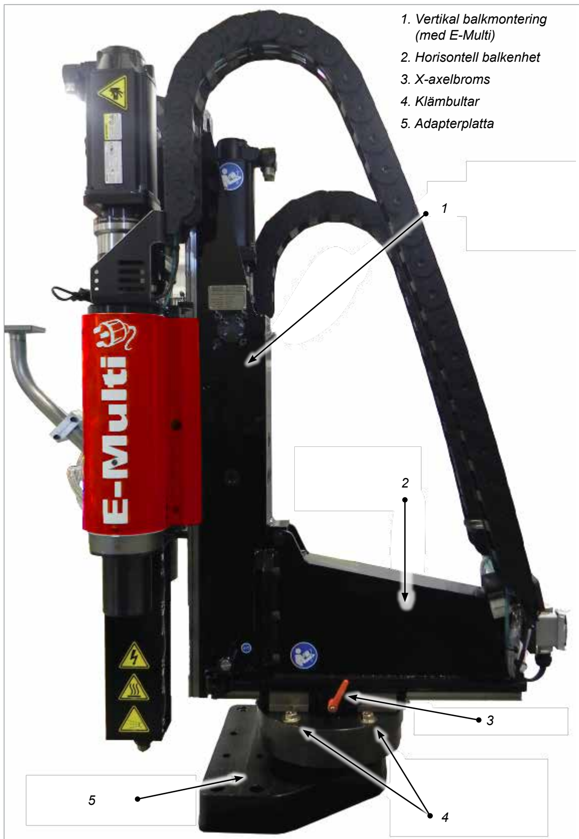
Figur 11-1 Huvudkomponenter i E-Multi Radial
