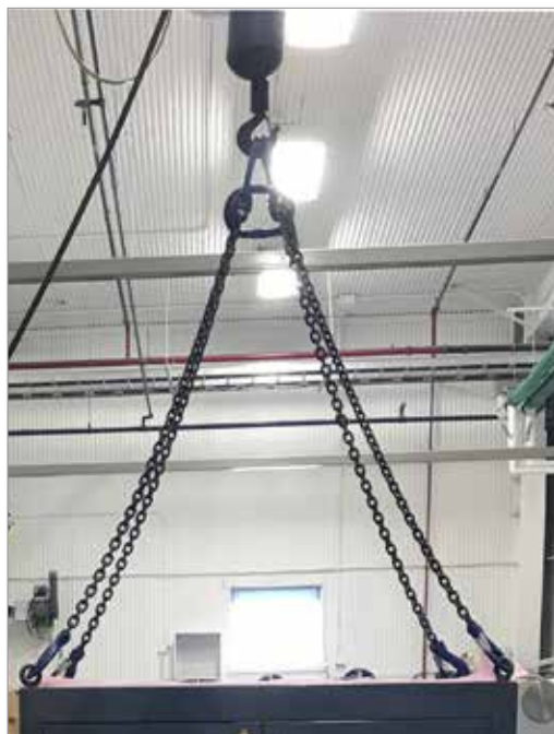
Figur 3-11 Fäst slingor på alla fyra lyftöglorna
