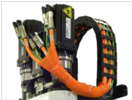
Figur 5-1 Servokabelføring i EM3
