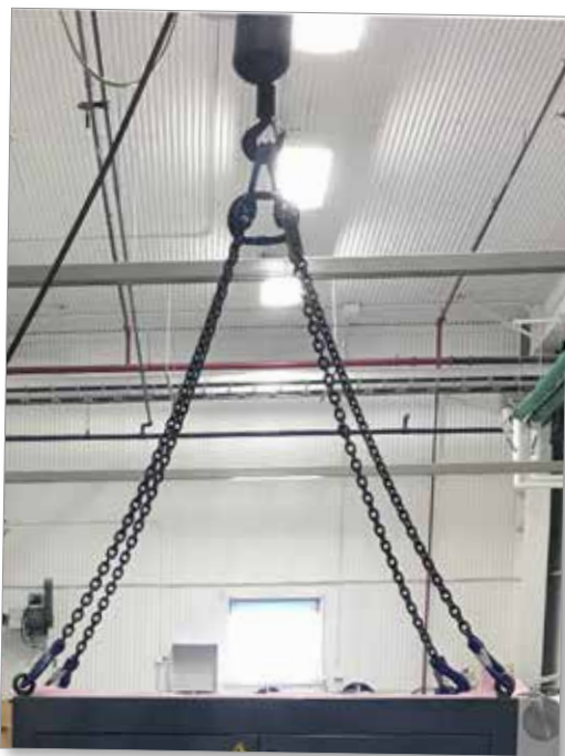
Figure 3-11 Fastgør slynger til alle fire øjebolte
