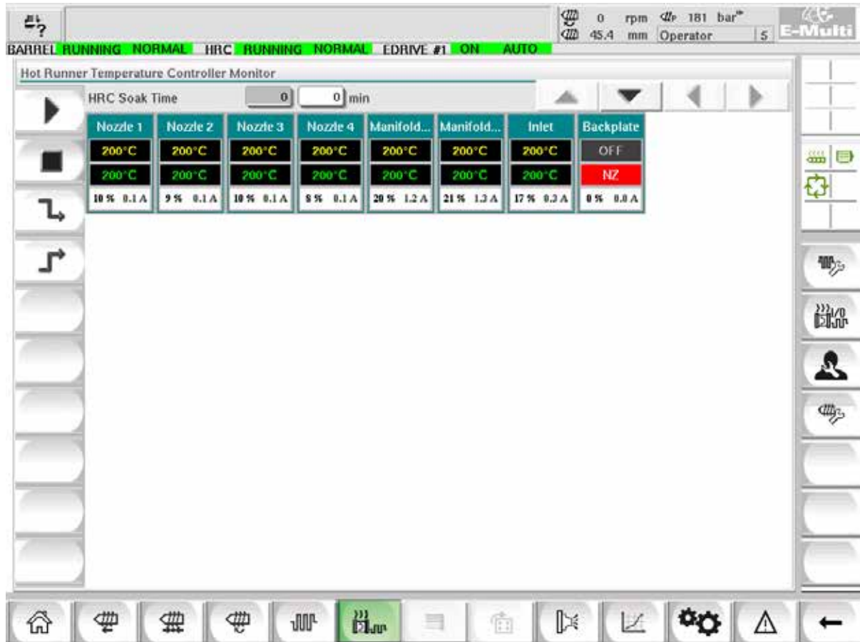
Figur 7-11 Observationsskærm for varmekanalens styreenhed
