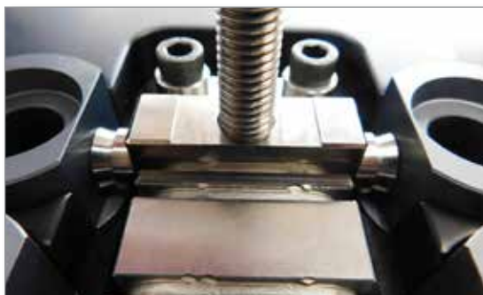
Figura 5-103 Instale um olhal de içamento M10
