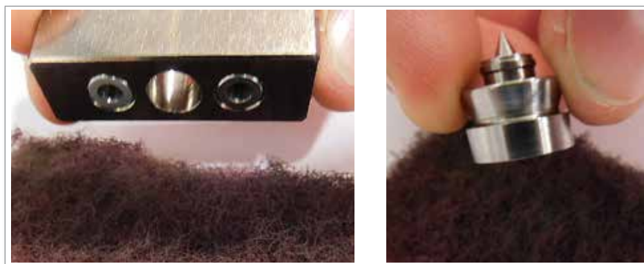
Figura 5-108 Limpe o bloco de fusão e a vedação da comporta
