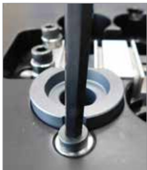
Figura 5-101 Instale a inserção da cavidade
