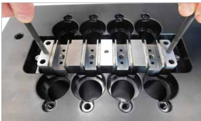
Figura 5-97 Instale o coletor do Melt-Cube
