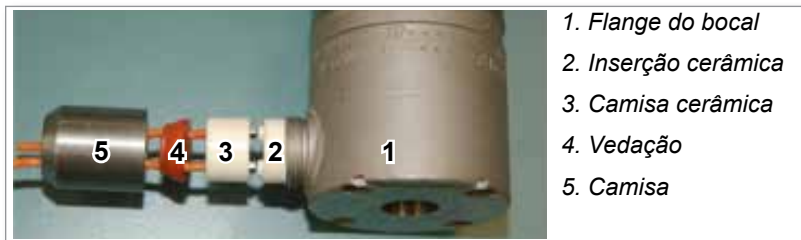
Figura 10-6 Conjunto de terminais do bocal
