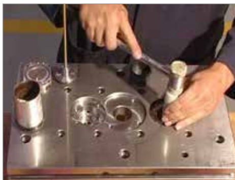
Figura 5-52 Instalação do cilindro
