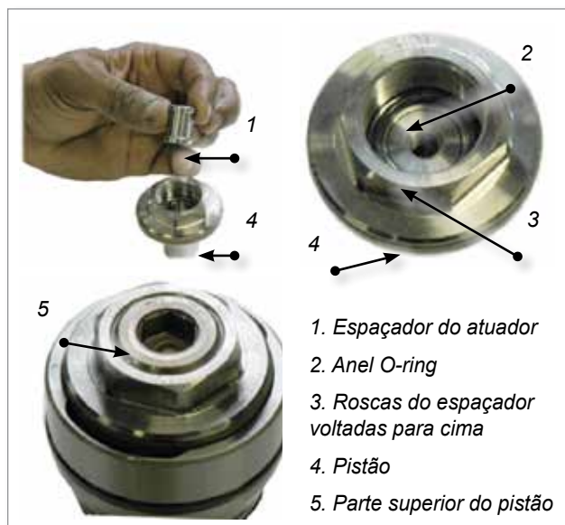
Figura 5-53 Instalação do espaçador do pistão
