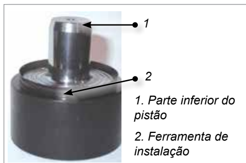
Figura 5-41 Parte inferior do pistão com ferramenta de instalação
