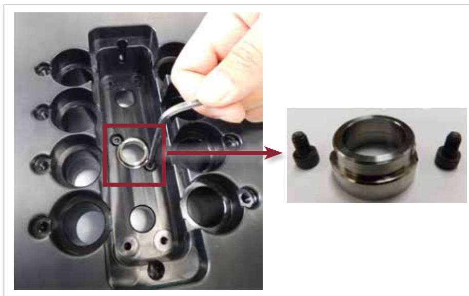
Figura 5-95 Instale o localizador central
