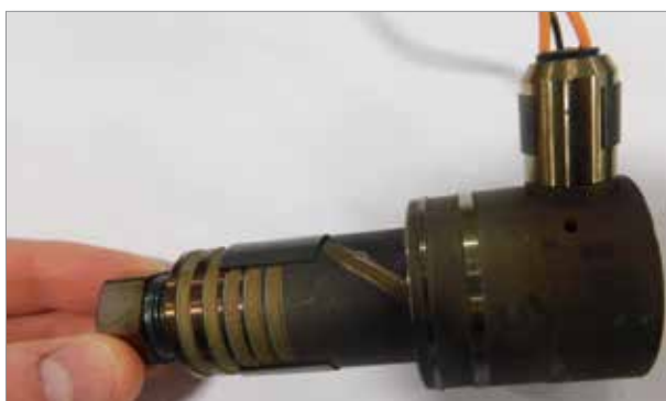
Figura 5-93 Instale a metade superior da ligação de transferência de fusão
