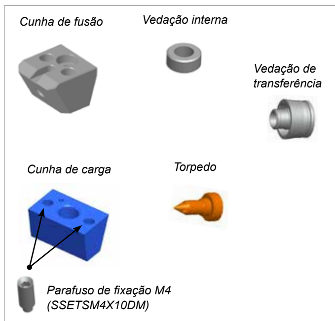
Figura 5-82 Conjunto da vedação da comporta
