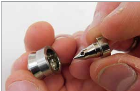
Figura 5-100 Instale o torpedo
