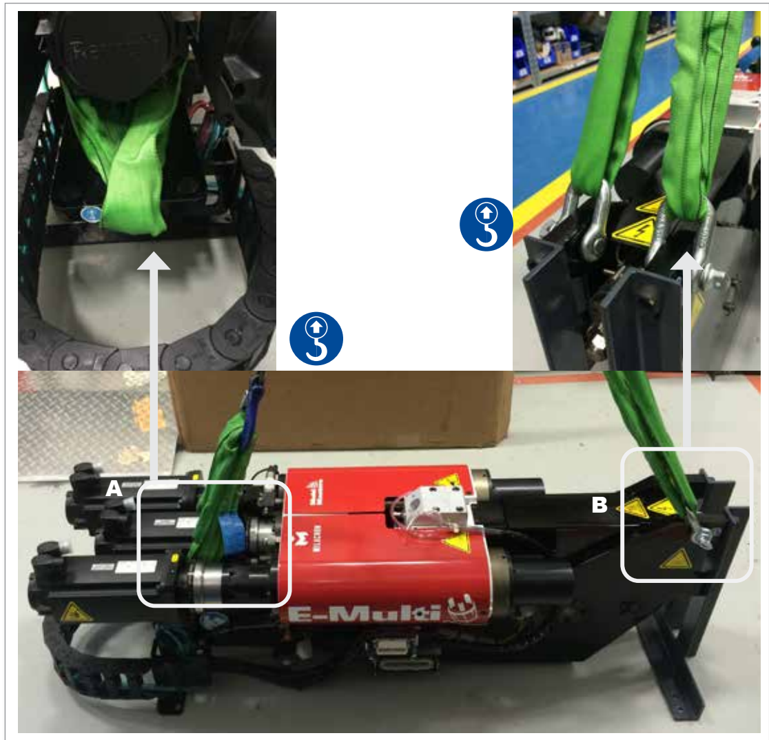
Kuva 3-7 EM3-vaakanostoliitännät. EM1 ja EM2 ovat samankaltaisia.
