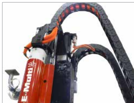
Kuva 11-8 Kiinnitä servomootorin kaapelit.
