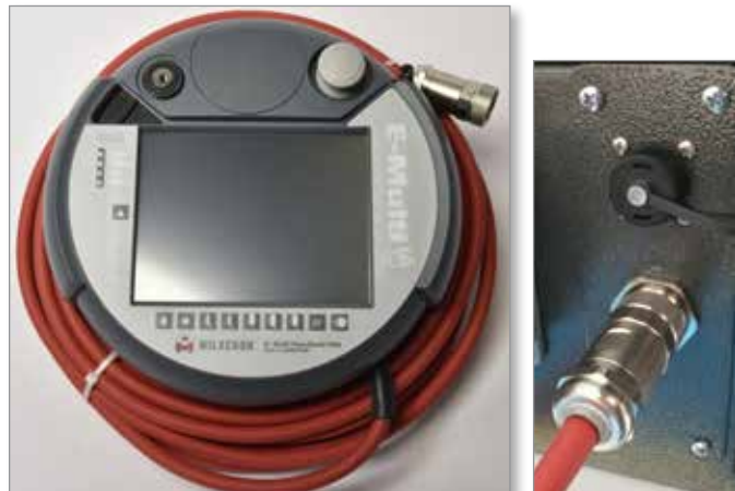
Kuva 7-5 Kannettava käyttöliittymä ja liitäntä
