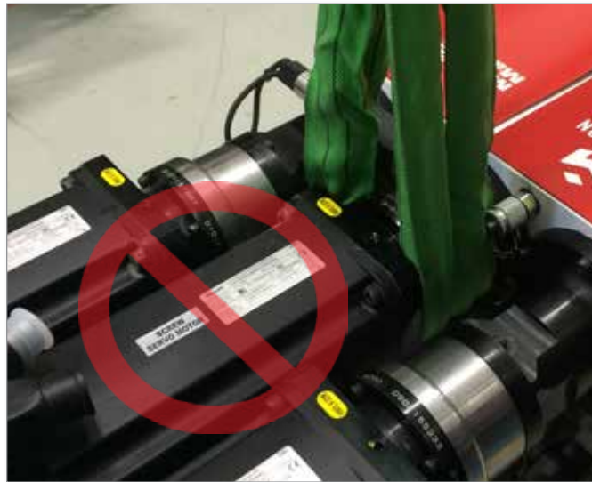
Kuva 3-5 Älä käytä moottoria nostopisteenä
