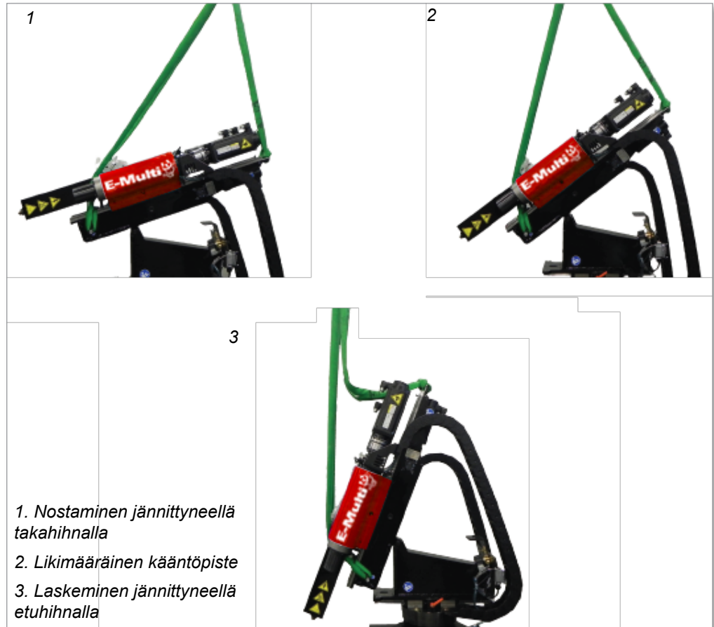
Kuva 11-6 E-Multi Radialin kallistaminen vaaka-asennosta pystyasentoon
