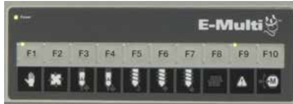
Kuva 8-2 Painikerivi ohjaimen näytön (käyttöliittymä, HMI) alapuolella
