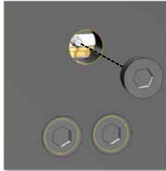
3. Schlitten verschieben, bis der Anschluss zum Loch ausgerichtet ist.
