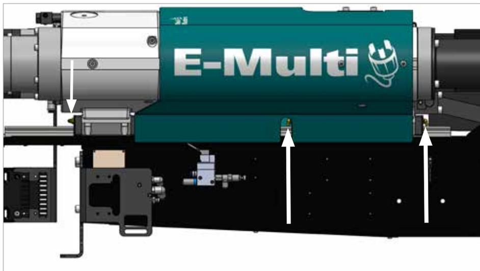
Abbildung 2-16 Seitenansicht der Schmierpunkte der Linearführung (3)
