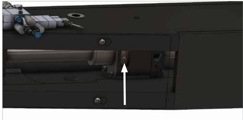
*Abbildung 2-12 Ansicht der Unterseite, die die Position der Schmierpunkte der Kugelgewindespindel des Schlittens zeigt (Systeme vor Mitte 2023)*
