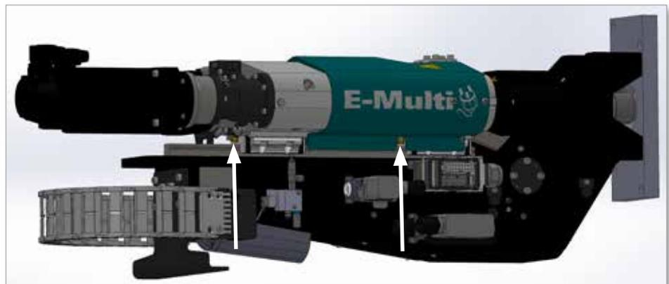
Abbildung 2-2 Schmierpunkte für die Linearführungen (2)
