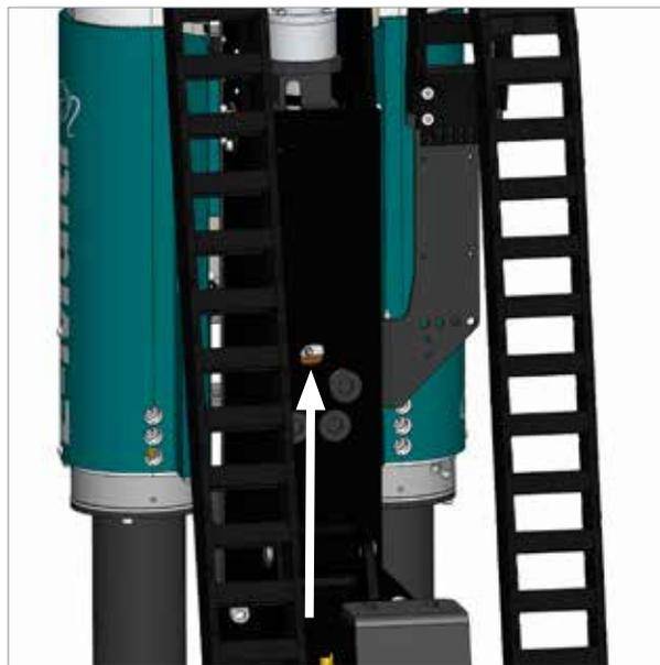
Abbildung 2-4 Schmierpunkt für die Kugelgewindespindel des Schlittens (1)
