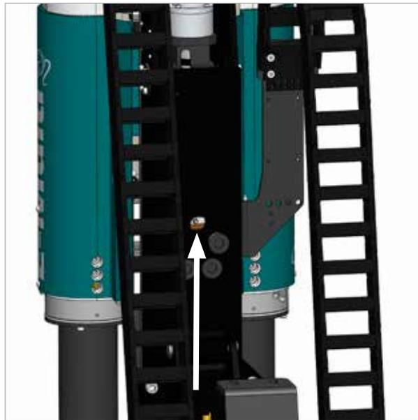
*Illustration 2-4 Point de lubrification de la vis à billes du chariot (1)*
