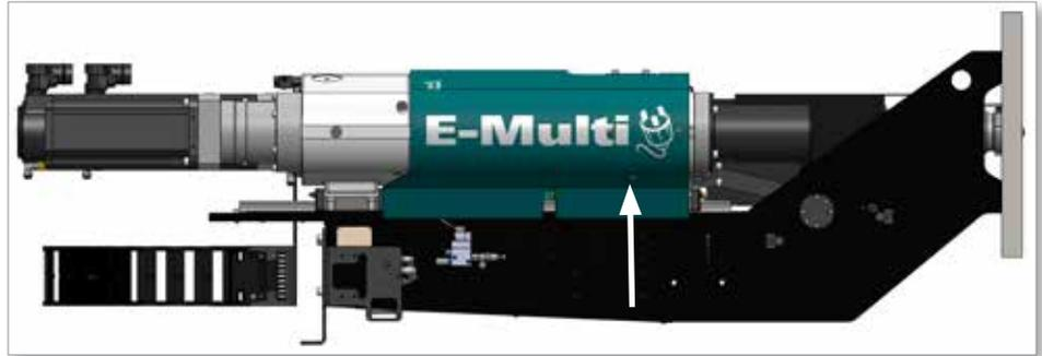
*Illustration 2-14 Vue latérale montrant l'emplacement des points de lubrification des vis à billes*
