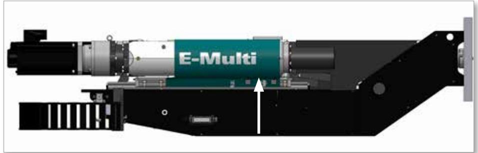
*Illustration 2-21 Vue latérale montrant l'emplacement des points de lubrification des vis à billes*
