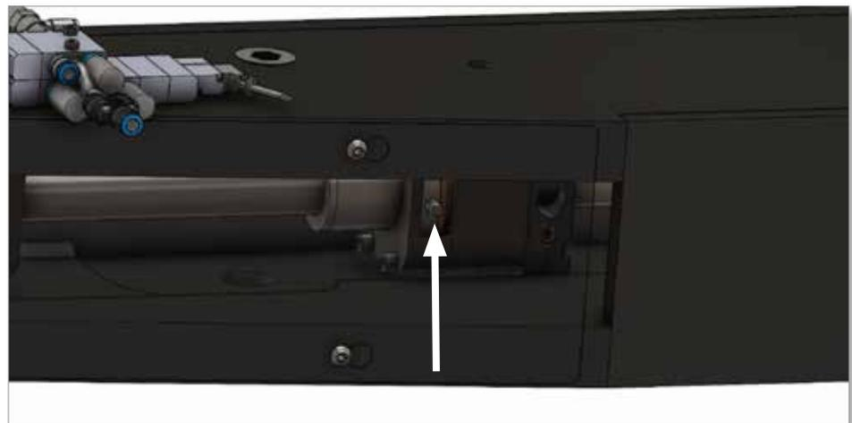
*Illustration 2-12 Vue de dessous montrant l'emplacement du point de lubrification de l'écrou de la vis à billes du chariot (systèmes antérieurs à la mi-2023)*
