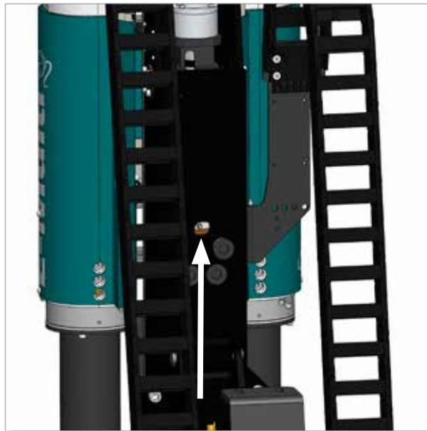
*Figura 2-4 Punto di lubrificazione dado vite a sfere carrello (1)*
