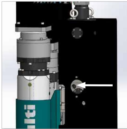
*Figura 2-18 Vista laterale (verticale effettiva) che mostra il punto di lubrificazione del gruppo molla (carrello in basso di 50 mm dalla posizione completamente sollevata)*
