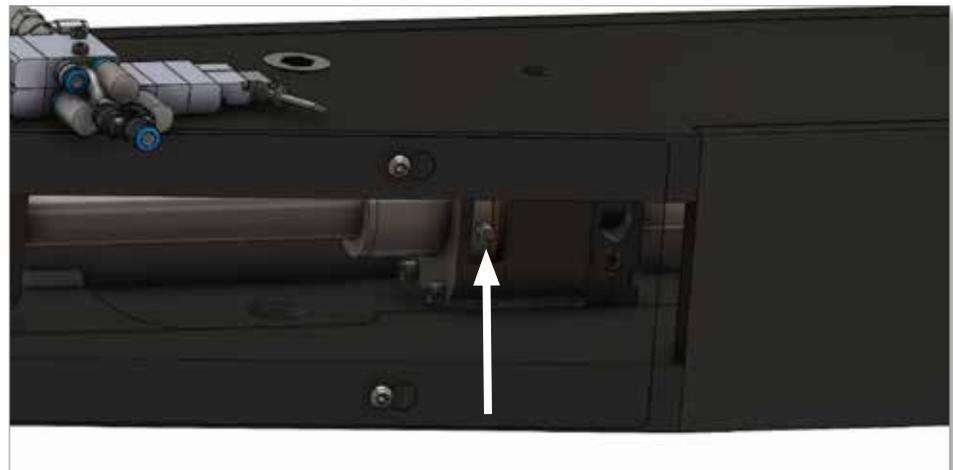
*Figura 2-12 Vista dal basso che mostra la posizione del punto di lubrificazione del dado della vite a sfere del carrello (sistemi precedenti alla metà del 2023)*
