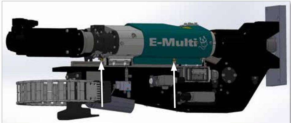
Figura 2-2 Punti di lubrificazione della guida lineare (2)
