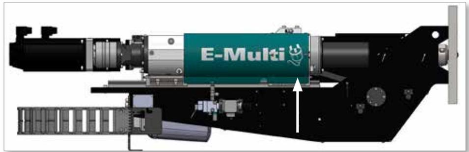
Figura 2-7 Vista laterale che mostra la posizione dei punti di lubrificazione della vite a sfere
