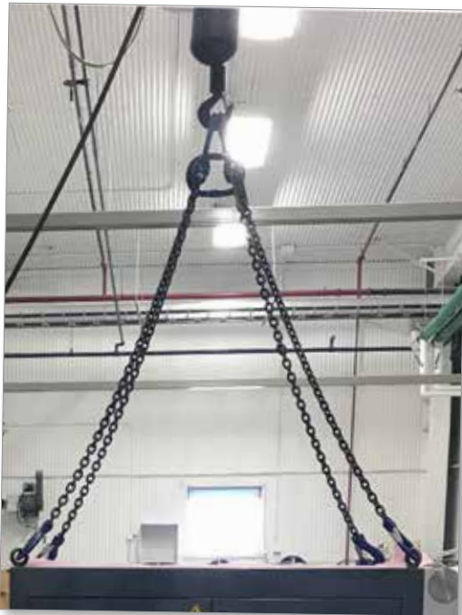
Abbildung 5-3 Befestigen von Hebeketten an allen vier Ringschrauben
