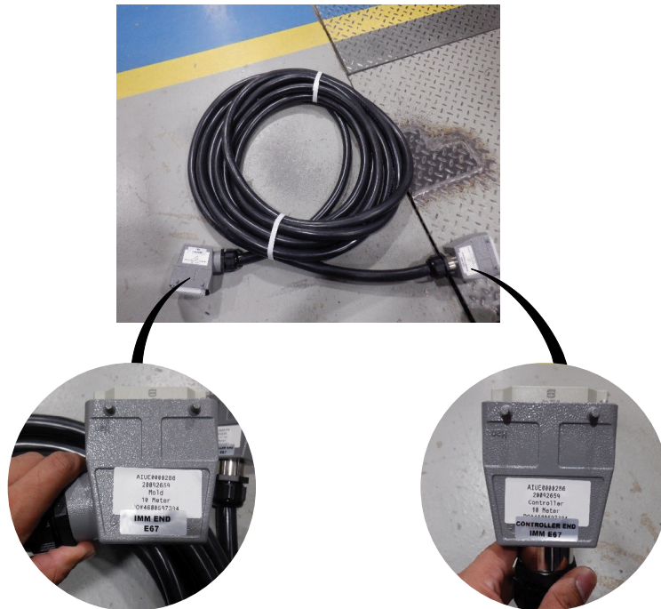
Figure 5-5 Formsprutningsmaskin E67-kabel med form/Formsprutningsmaskinsände och styrenhetssida
