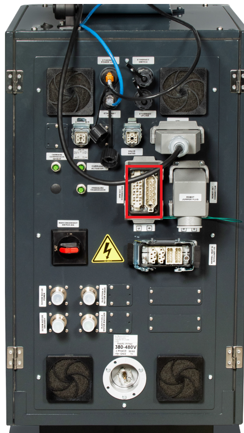
Figure 5-6 Formsprutningsmaskin E67-kontakt på baksidan av styrenheten
