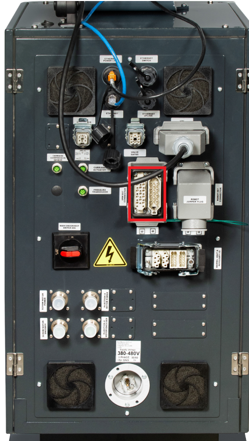
Abbildung 5-6 IMM E67-Stecker auf der Rückseite der Steuerung
