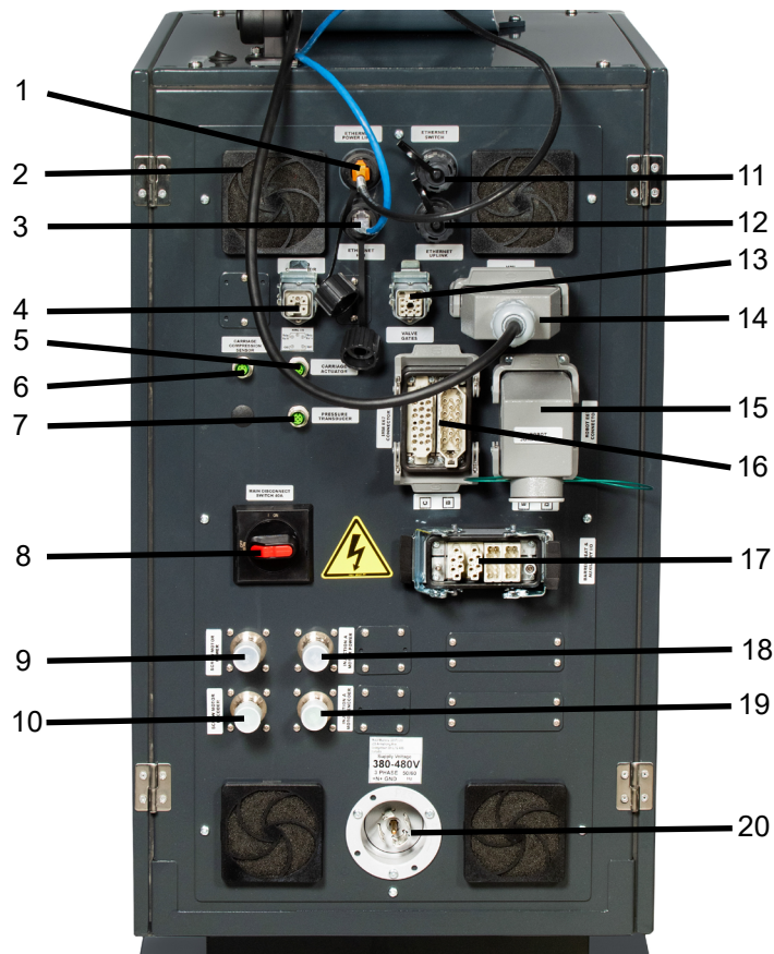
Abbildung 4-2 Rückansicht der Steuerung (Anschlüsse)
