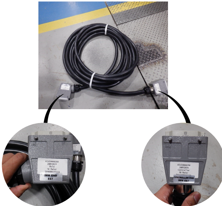
Abbildung 5-5 IMM E67-Kabel mit Gussform-/IMM-Ende und Steuerungsende
